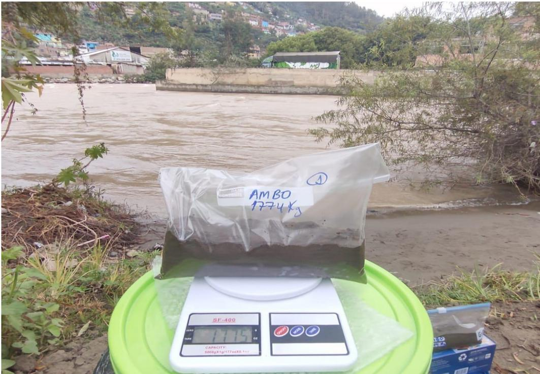
**Fotografía** Medición de peso sedimento arenoso (Microplásticos) - Punto AMBO
