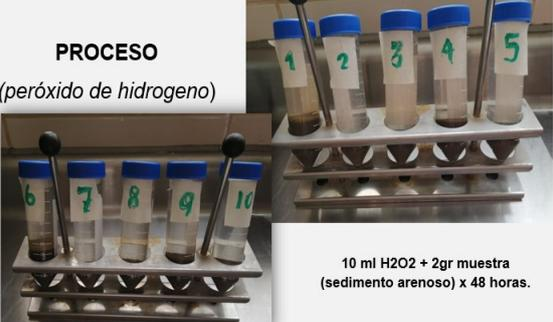
10 ml H2O2 + 2gr muestra (sedimento arenoso) x 48 horas.
