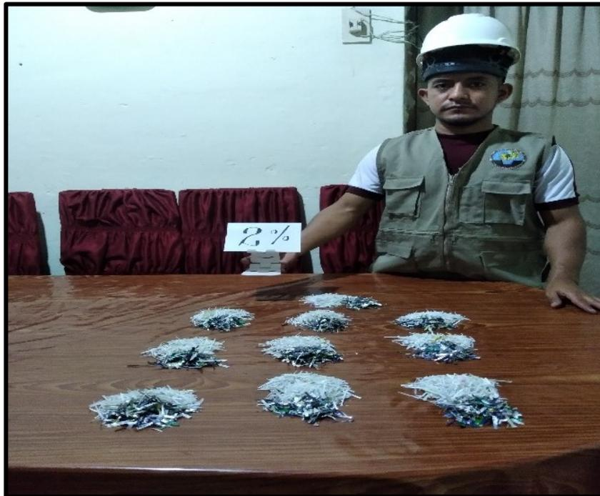
*Nota.* El gráfico muestra el 2% de fibras de polietileno de alta densidad y aluminio reciclado. Elaboración propia.
