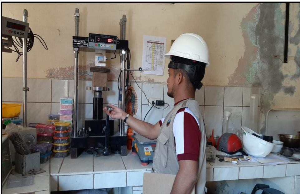
*Nota.* El gráfico muestra al bloque de adobe al ensayo de compresión. Elaboración propia.
