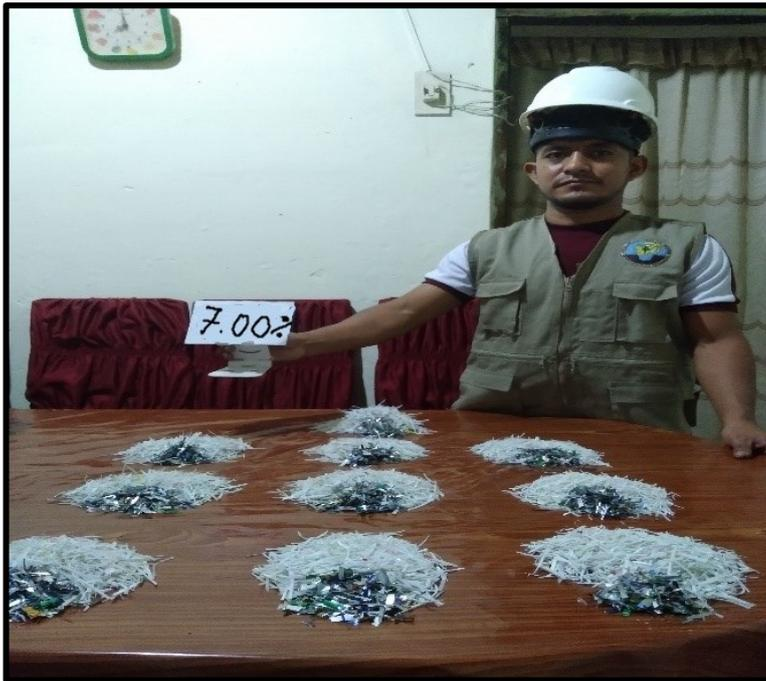
*Nota.* El gráfico muestra el 7% de fibras de polietileno de alta densidad y aluminio reciclado. Elaboración propia.
