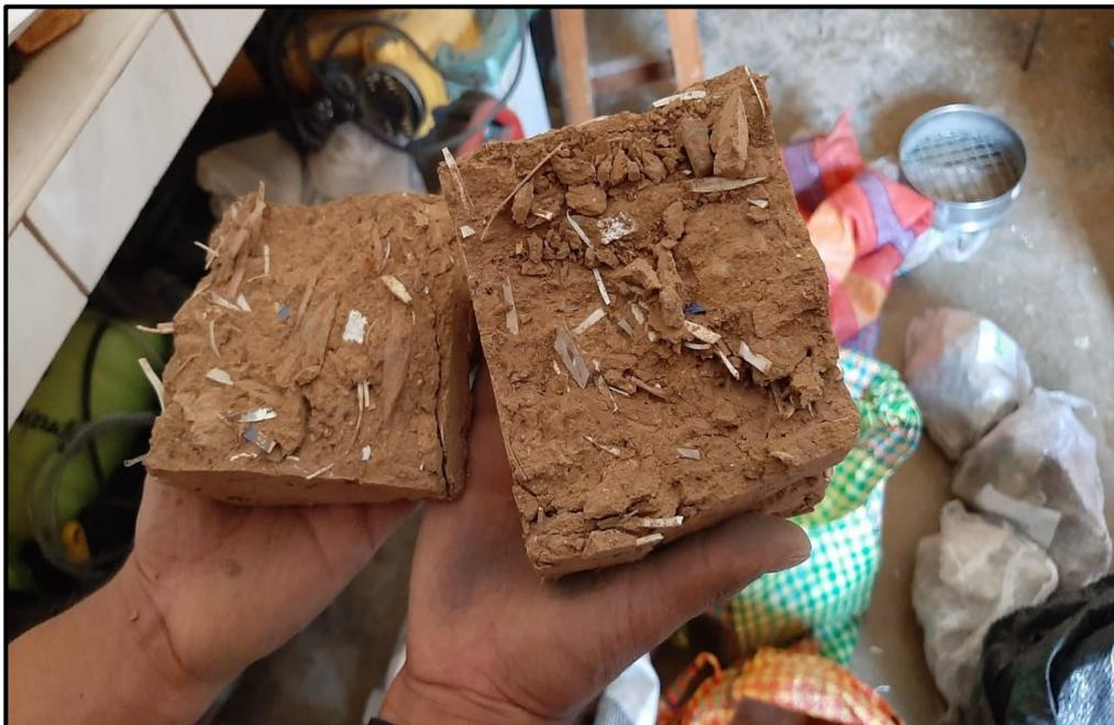
*Nota.* El gráfico muestra al bloque de adobe después del ensayo de compresión. Elaboración propia.
