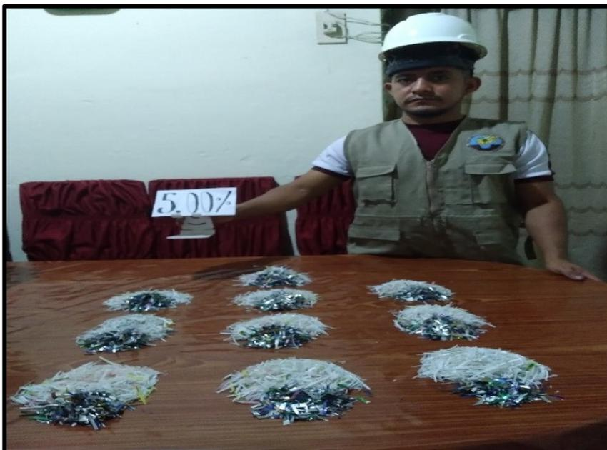
*Nota.* El gráfico muestra el 5% de fibras de polietileno de alta densidad y aluminio reciclado. Elaboración propia.
