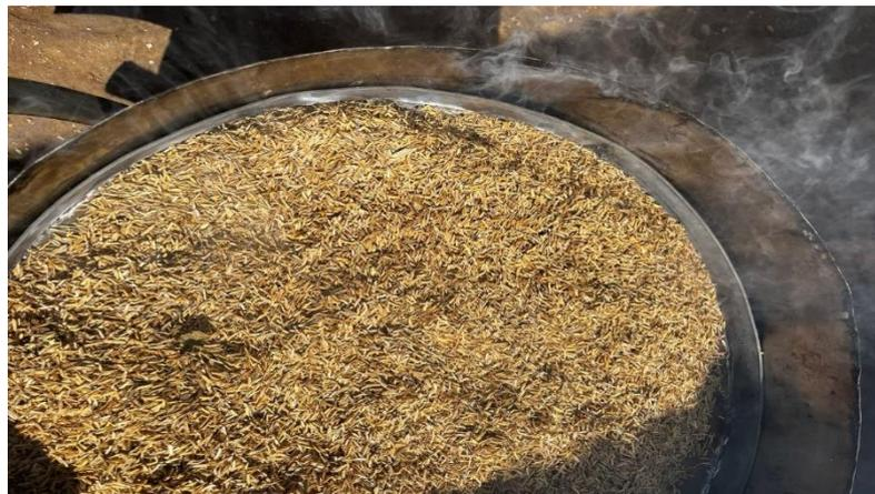
Nota: En la figura 13, la cascarilla de arroz está en proceso de carbonización dentro del horno, cuyo proceso tarda 12 horas en este caso con el residuo utilizado.
