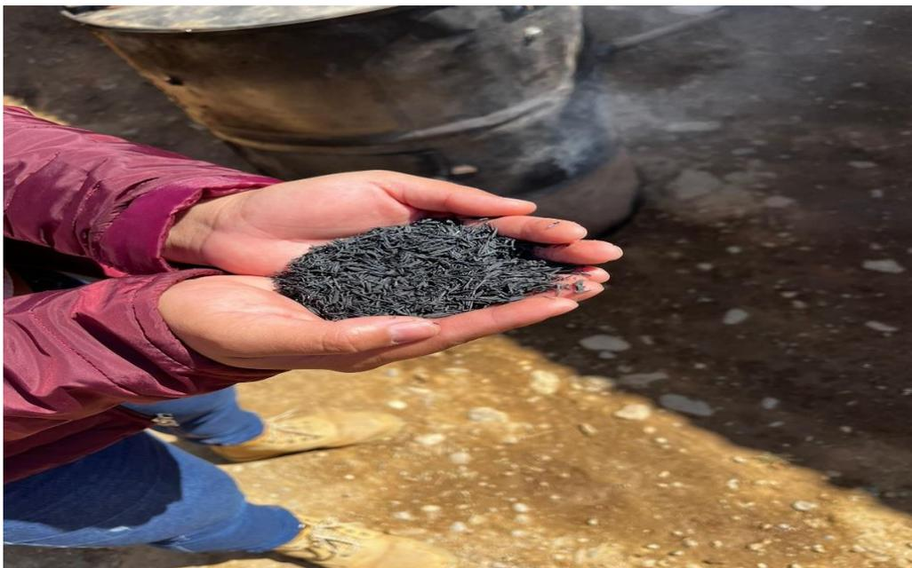
Nota: En la figura 15, el resultado final del proceso de carbonización, biochar de cascarilla de arroz.
