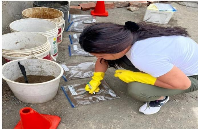
Nota: En la figura 19, muestra el rotulado de muestras del suelo post test adicionado el biochar con las dosificaciones al 20% y 25%.
