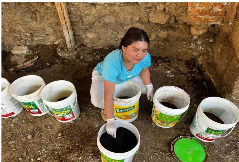
Nota: En la figura 16, muestran la homogenización del biochar con el suelo ya con las dosis aplicadas en el 20% y 25%.
