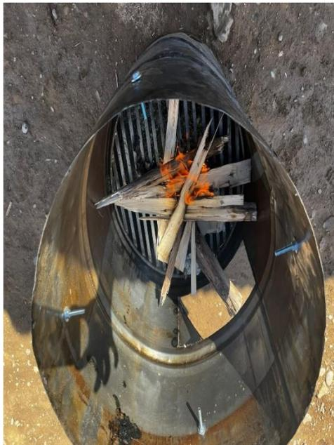
Nota: En la figura 12, el encendido del horno pirrónico donde se carbonizará el biochar de cascarilla de arroz.
