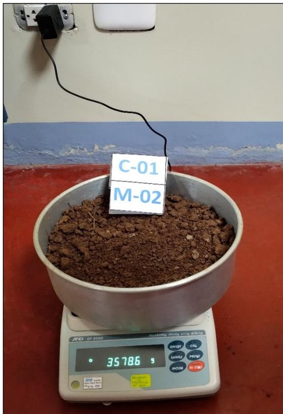
CUARTEO Y PESADO DE MUESTRAS PARA EL CALCULO DEL PSEO VOLUMETRICO.
