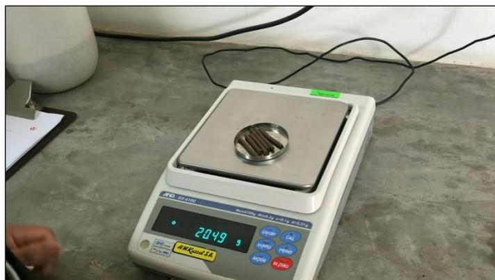
SE TOMAN MUESTRAS SUELO Y SE FORMAN BASTONES DE 3mm HASTA QUE SE MUESTREN FISURAS, LUEGO SE PESA DE FORMA NATURAL Y TAMBIEN LUEGO DE ENTRAR AL HORNO.
