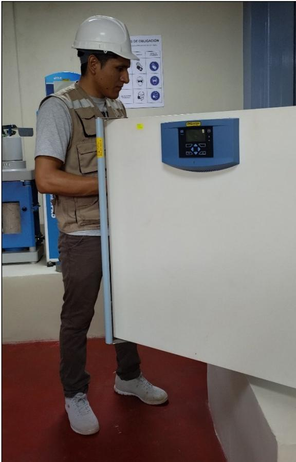
COLOCACIÓN EN EL HORNO PARA CALCULAR EL CONTENIDO DE HUMEDAD DE TODAS LAS MUESTRAS.
