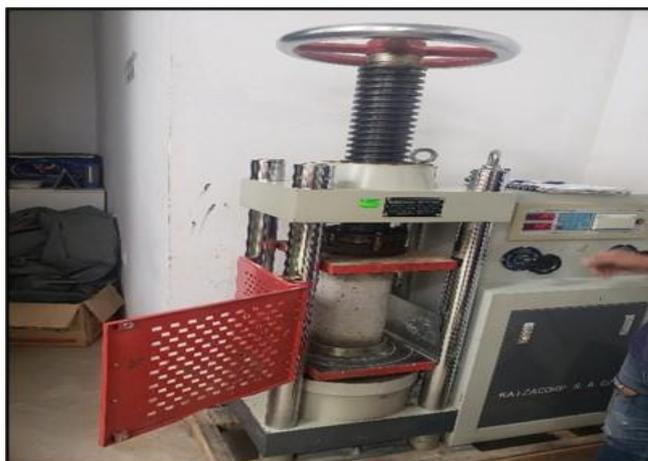
**Nota:** La figura muestra la prensa digital STYE-2000 marca KAYZACORP utilizado para la rotura de los testigos de concreto
