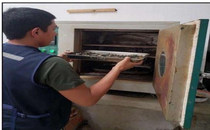
**Nota:** La figura muestra el empleo de horno para el secado de agregado grueso para el posterior cálculo de contenido de humedad
