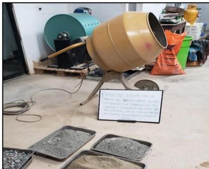
**Nota:** la figura muestra el empleo proporcionado de materiales necesarios para la elaboración de los testigos de concreto por tipo de muestra previos a ser introducidos a la mezcladora
