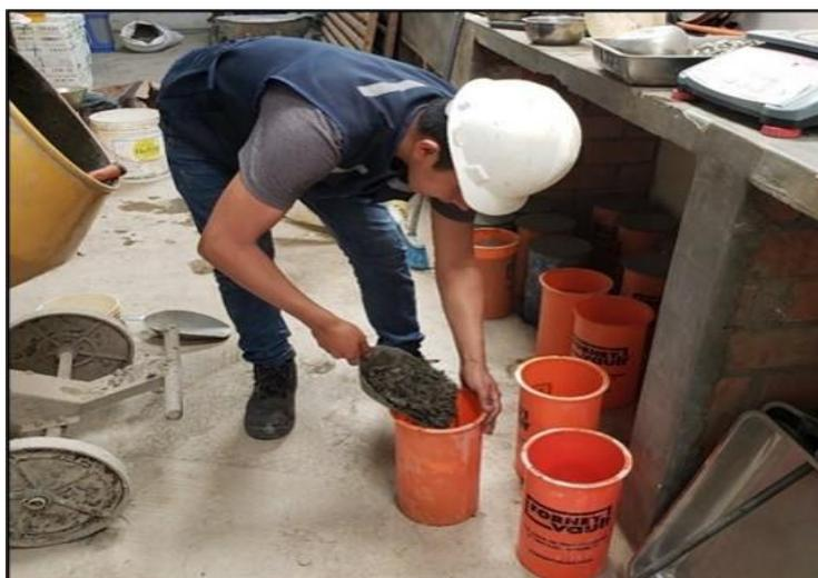
**Nota:** La figura muestra el llenado de los moldes con el concreto fresco, cabe resaltar que previamente los moldes son rellenos con petróleo para el fácil desmoldeo de las muestras endurecidas
