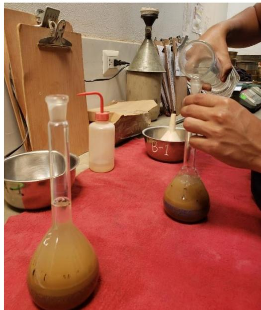
**Nota:** La figura muestra el procedimiento para el calculo de peso específico del agregado fino con el empleo de un picnómetro
