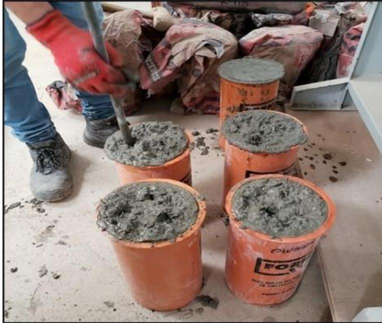
**Nota:** La figura muestra el golpeo con la varilla metálica en la última capa del llenado del concreto en los moldes cilíndricos
