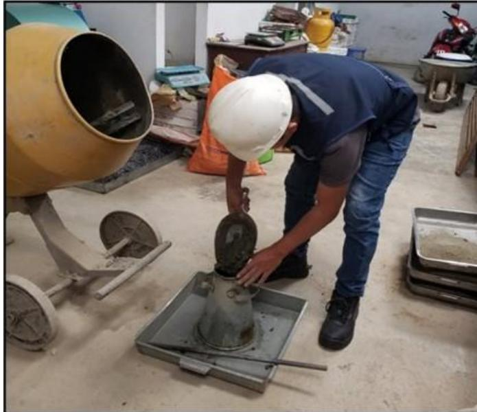
**Nota:** Después del mezclado correcto según el manual de diseño de mezclas se procede con realizar el ensayo de cono de Abrams para poder determinar si cumple con el asentamiento diseñado, para ellos se vierte el concreto fresco en 3 niveles previos chuseado para posteriormente quitar el molde y medir el asentamiento
