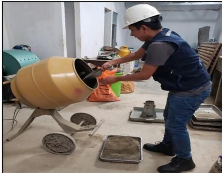
**Nota:** La figura muestra la introducción de los agregados a la mezcladora, previamente se vierte cierta cantidad de agua y posterior los demás materiales necesarios para la elaboración de las probetas cilíndricas de 15x30cm
