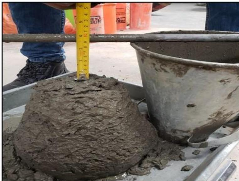
**Nota:** Quitado el molde se mide en pulgadas el asentamiento del concreto diseñado y para este caso se puede apreciar un asentamiento en 3 y 4 pulgadas
