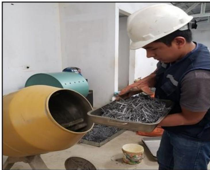
**Nota:** Una vez sumergida todos los materiales necesarios para la elaboración del concreto, se procede a introducir la tanda de fibra de acero según el diseño realizado
