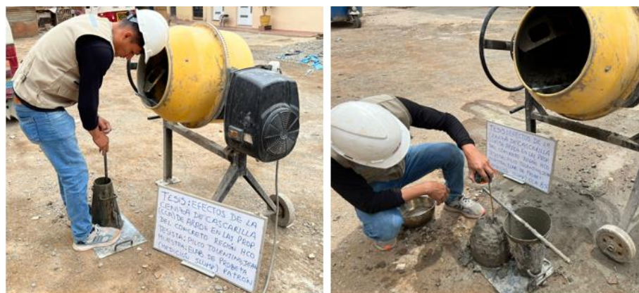
Figura 14 Calculo del Slump mediante el cono de Abrams
