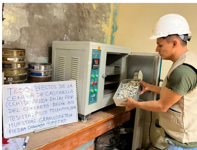
Figura 10 Humedad de la piedra triturada
