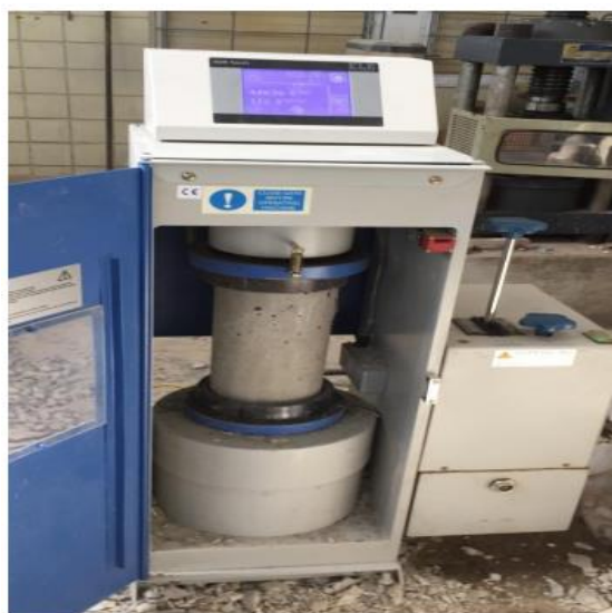
Figura 3 Probeta sometida al proceso de compresión
