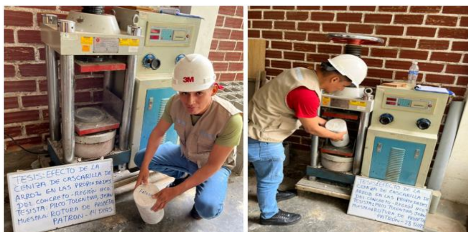
Figura 15 Ensayo de rotura de probetas
