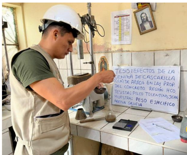
Figura 9 Gravedad específica del agregado fino
