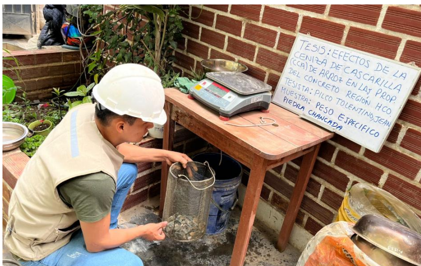
Figura 8 Gravedad específica y absorción del agregado grueso
