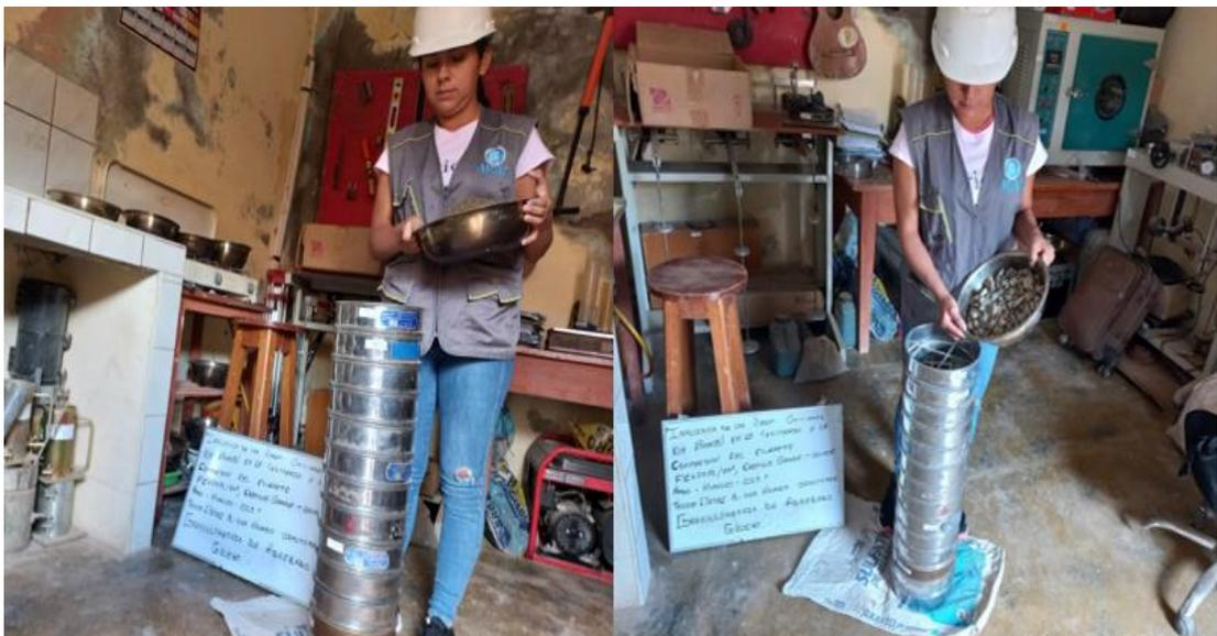
En la foto se puede apreciar que después de pasar por el tamiz, el porcentaje total que pasa se le realiza el pesaje y se introduce al horno, para obtener un peso específico del agregado seco, todo según a la NTP 400
