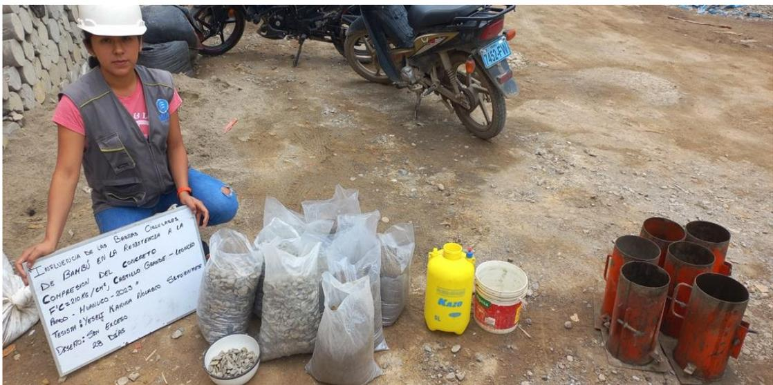
En esta imagen podemos apreciar que pesamos los materiales que usaremos para la elaboración de nuestro concreto (sin exceso)
