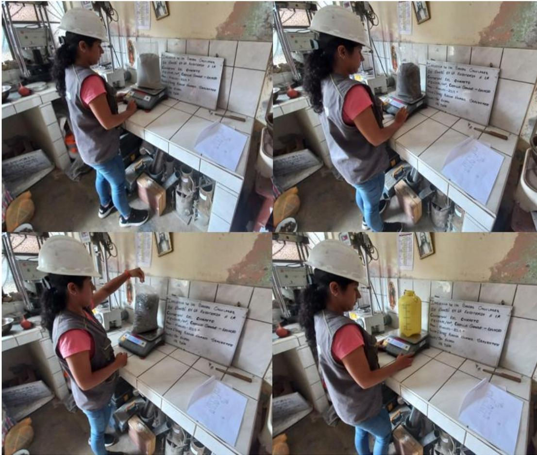
Realizamos la mezcla de los materiales para nuestro concreto sin exceso. Posteriormente se le añadirá los % del bambú para cada ensayo
