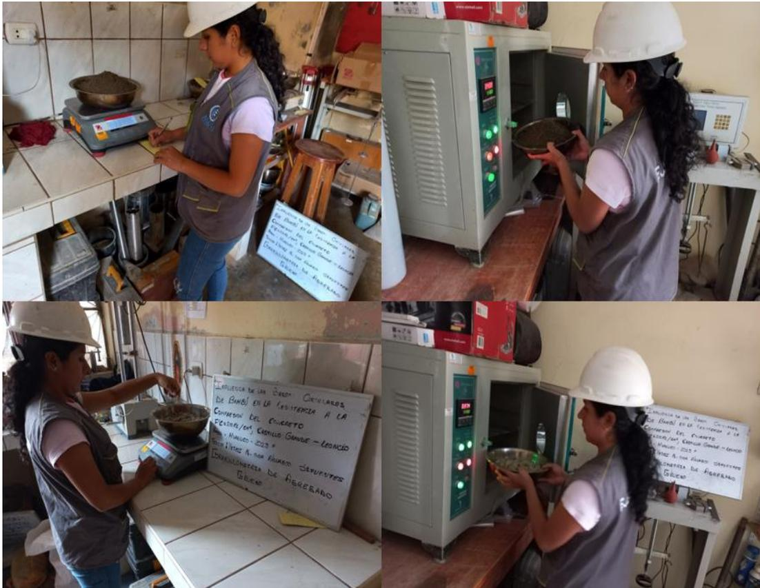
Una vez obtenido todos los datos al realizar el ensayo granulométrico lo separamos para realizar posteriormente la elaboración de nuestro concreto con bambú
