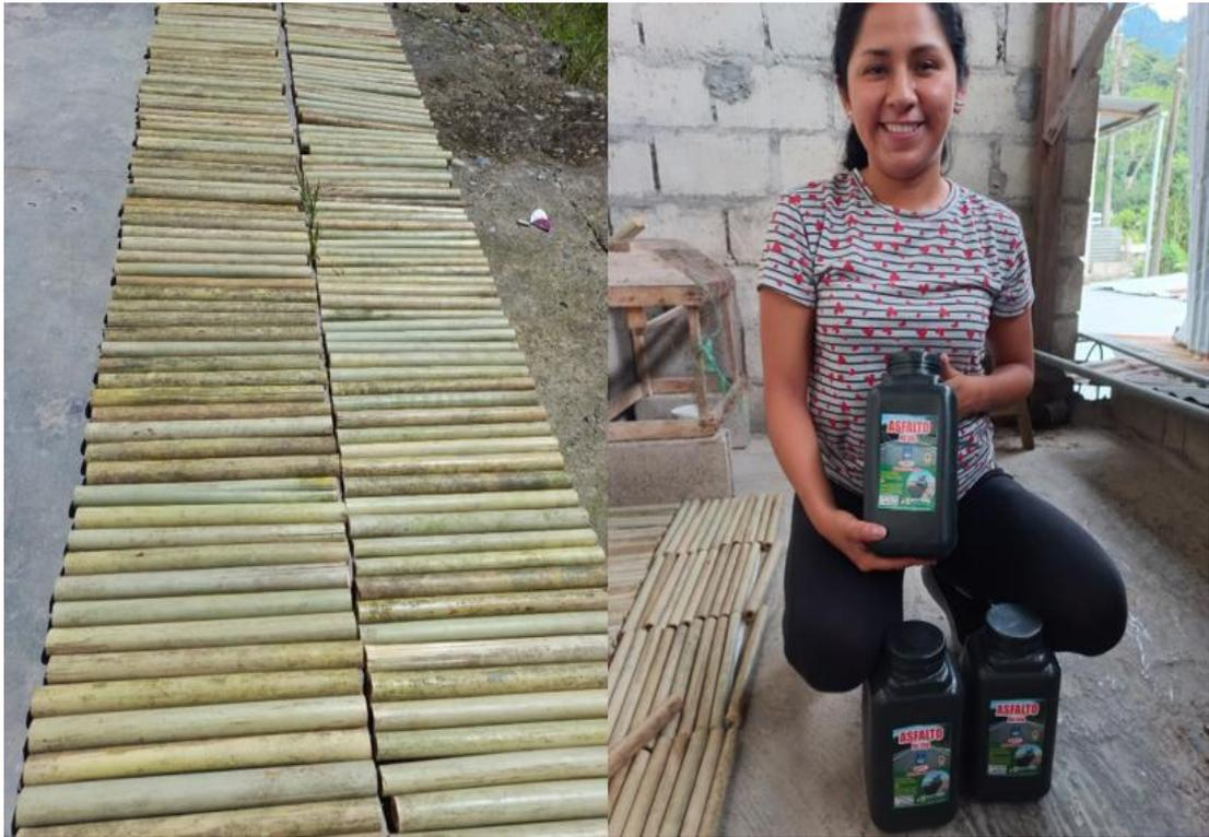
*Observamos en la imagen que el bambú es sumergido en asfalto con un tiempo determinado y así absorberlo*
