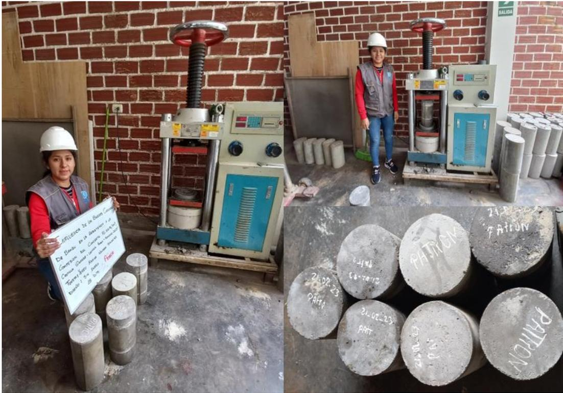
Imágenes del patrón después de ser sometido a las pruebas de resistencia a compresión
