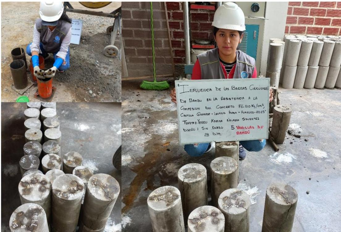
En la imagen se aprecia el resultado de nuestras muestras que fueron sometidas a la resistencia a compresión de un concreto  $f'c=210 \text{ kg/cm}^2$  con la adición de 5 barras de bambú sumergido en asfalto
