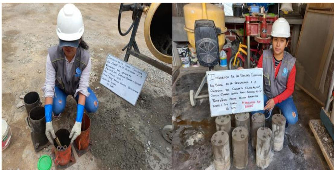
Se observan las muestras del molde cilíndrico y posteriormente realizaremos los ensayos de resistencia a compresión de un concreto de  $f_c=210 \text{ kg/cm}^2$  con adición de 3 barras de bambú sumergido en asfalto, también. En la imagen se aprecia el resultado de nuestras muestras que fueron sometidas a la resistencia a compresión de un concreto  $f_c=210 \text{ kg/cm}^2$  con la adición de 4 barras de bambú sumergido en asfalto
