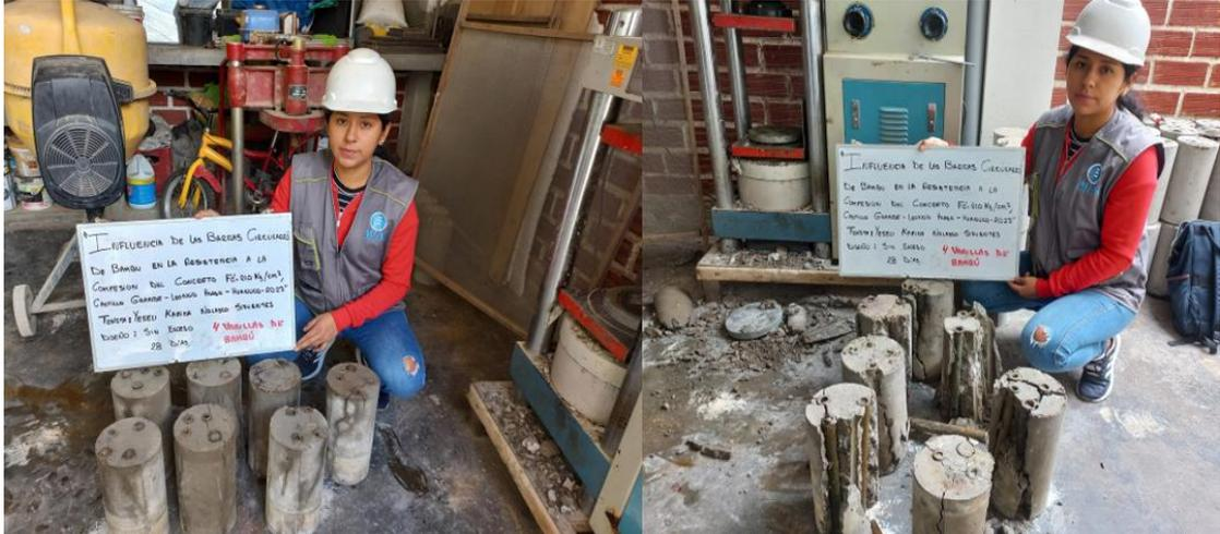
Apreciamos la inclusión de cinco barras de bambú sumergidos en asfalto a nuestra mezcla de concreto también la extracción de las muestras del molde cilíndrico y posteriormente realizaremos los ensayos de resistencia a compresión de un concreto de  $f_c=210 \text{ kg/cm}^2$  con adición de 5 barras de bambú sumergido en asfalto
