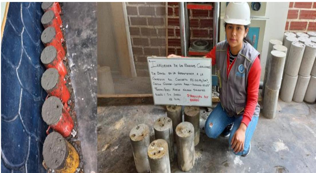
En la imagen apreciamos el resultado de nuestras muestras que fueron sometidas a la resistencia a compresión de un concreto  $f_c=210 \text{ kg/cm}^2$  con la adición de 4 barras de bambú sumergido en asfalto
