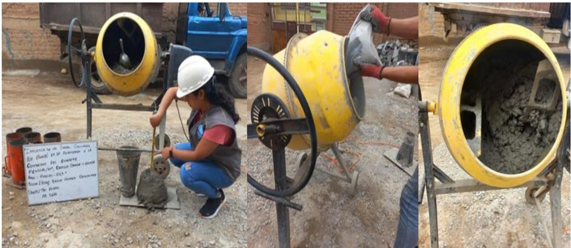
En esta imagen observamos las muestras del patrón, un concreto convencional que será sometido a las pruebas de compresión
