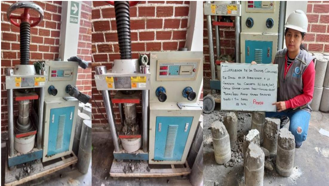
Apreciamos la inclusión de tres barras de bambú sumergidos en asfalto a nuestra mezcla de concreto, así obtenemos nuestras primeras muestras de concreto  $f_c=210 \text{ kg/cm}^2$  con 3 barras de bambú
