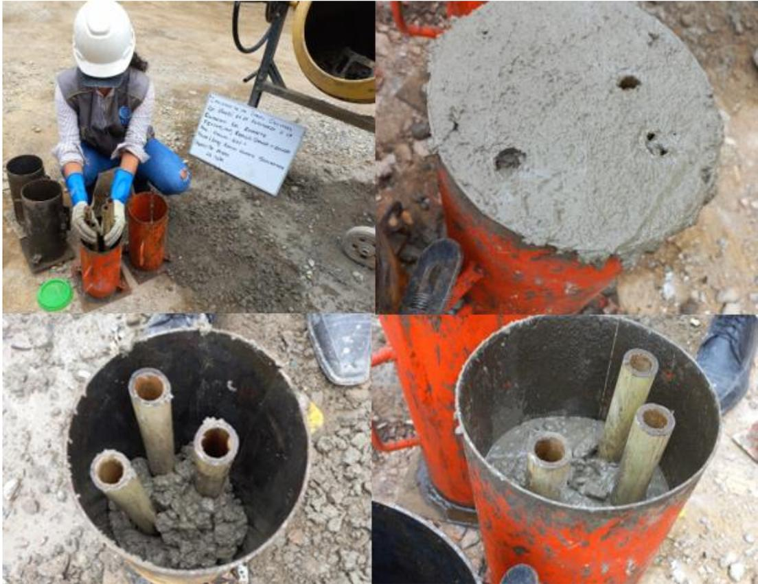
Extraemos nuestra muestra del molde cilíndrico y posteriormente realizamos los ensayos de resistencia a compresión de un concreto de  $f_c=210 \text{ kg/cm}^2$  con adición de 3 barras de bambú sumergido en asfalto
