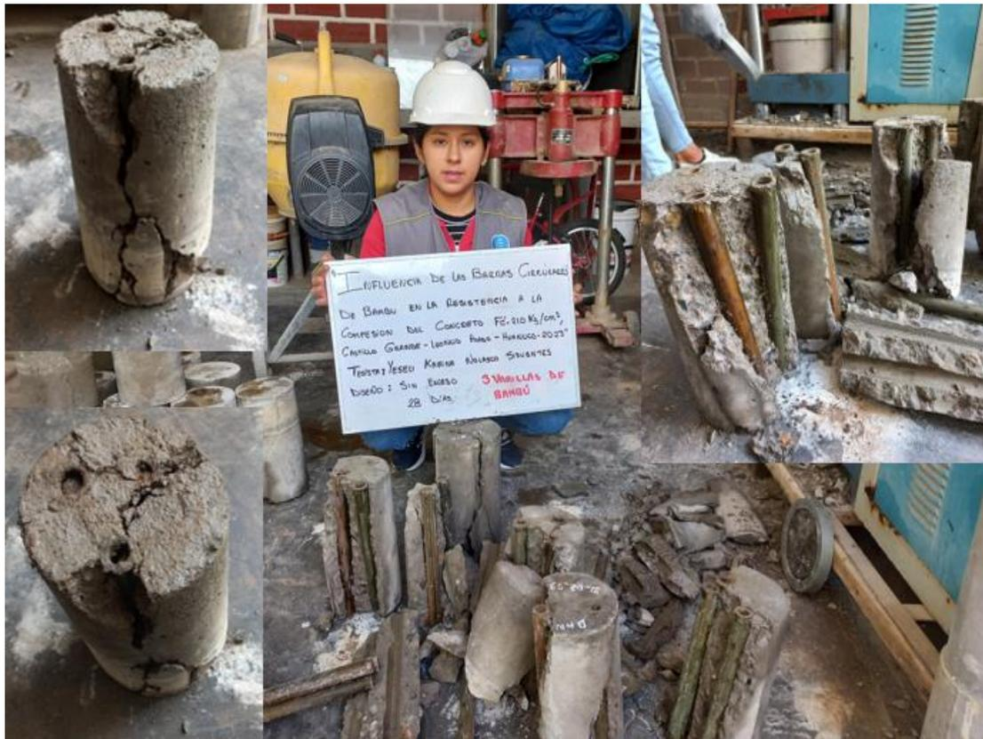
Apreciamos la inclusión de cuatro barras de bambú sumergidos en asfalto a nuestra mezcla de concreto también la extracción de las muestras del molde cilíndrico y posteriormente realizaremos los ensayos de resistencia a compresión de un concreto de  $f_c=210 \text{ kg/cm}^2$  con adición de 4 barras de bambú sumergido en asfalto
