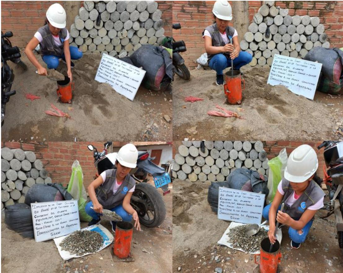
Realizamos el ensayo granulométrico de los agregados y lo pasamos por los tamices de ensayo según la NTP 350.001 y NTP 400
