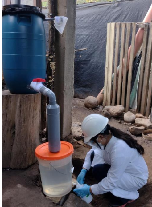
Toma de muestra del agua pluvial filtrada (cuarto post test)
