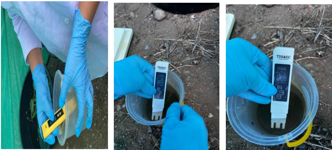
Toma de parámetros de campo como: Temperatura, conductividad y pH.
