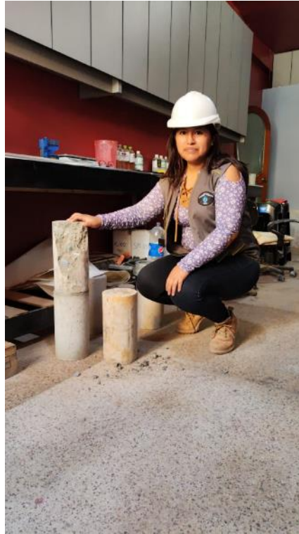
Se realizan los ensayos de rotura de probetas elaboradas in-situ para verificar si alcanzan la resistencia establecida.
