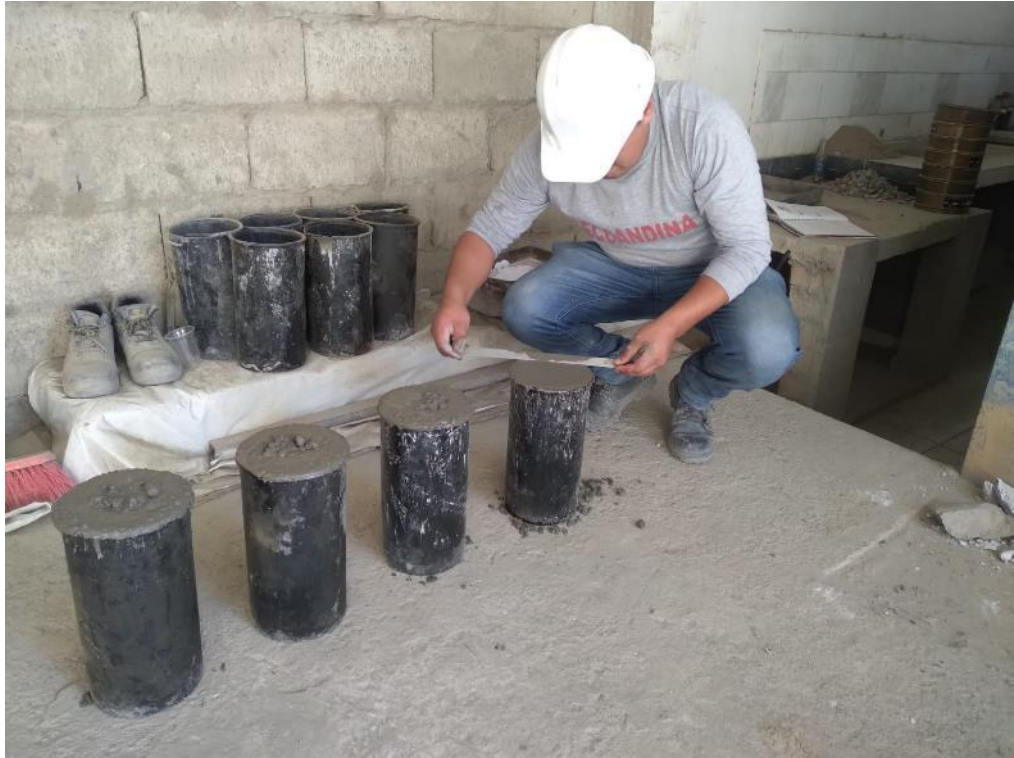
Se observa las probetas realizadas para el diseño de mezcla que será empleado en la obra
