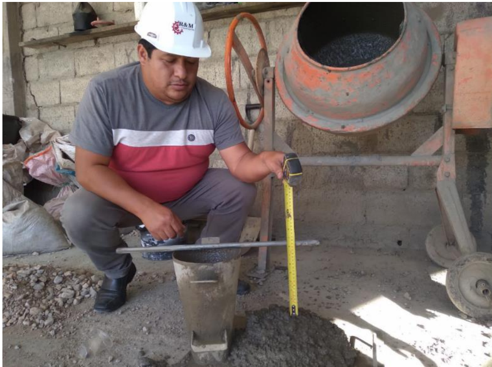
Se verifica el Slump del diseño de mezcla realizada en el laboratorio
