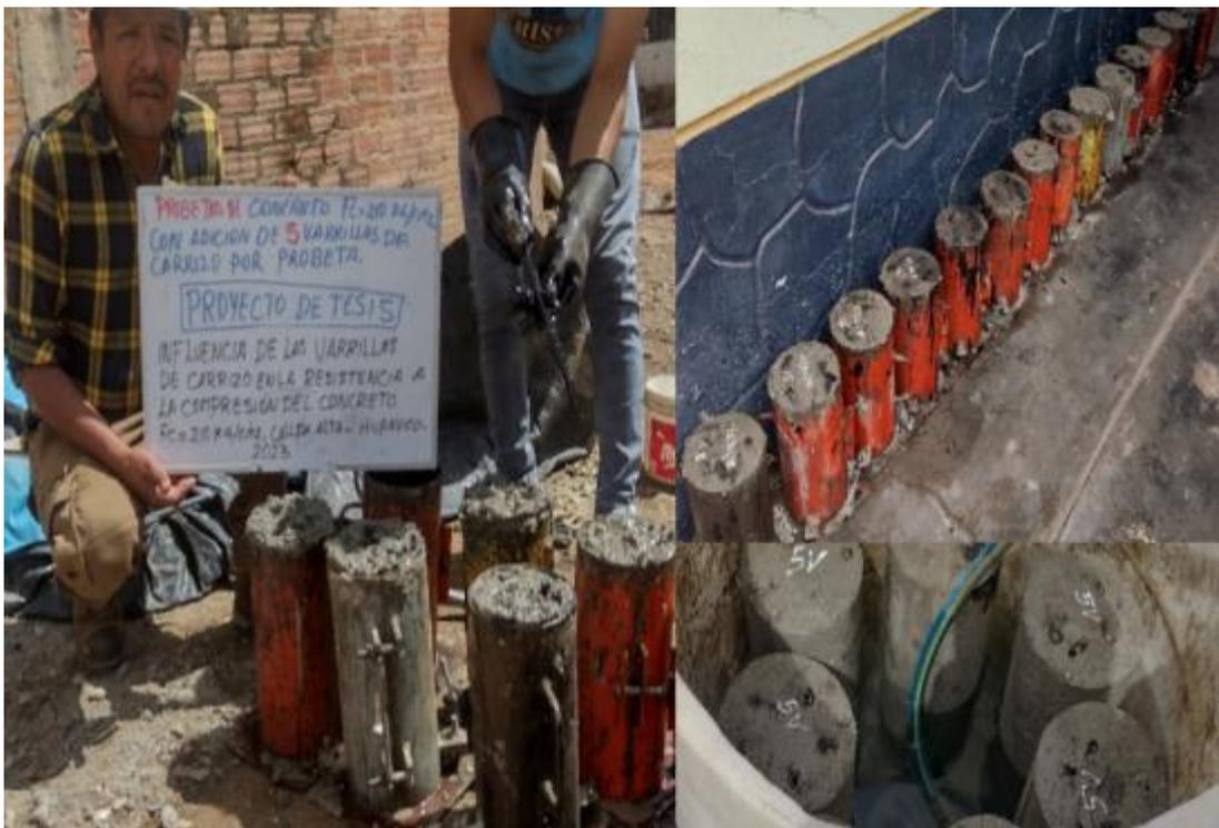
Muestras de las probetas de concreto  $f'c=210$  kg/cm<sup>2</sup>, del patrón y con adición de 3, 4 y 5 varillas de carrizo, después de los 7 días del curado.
