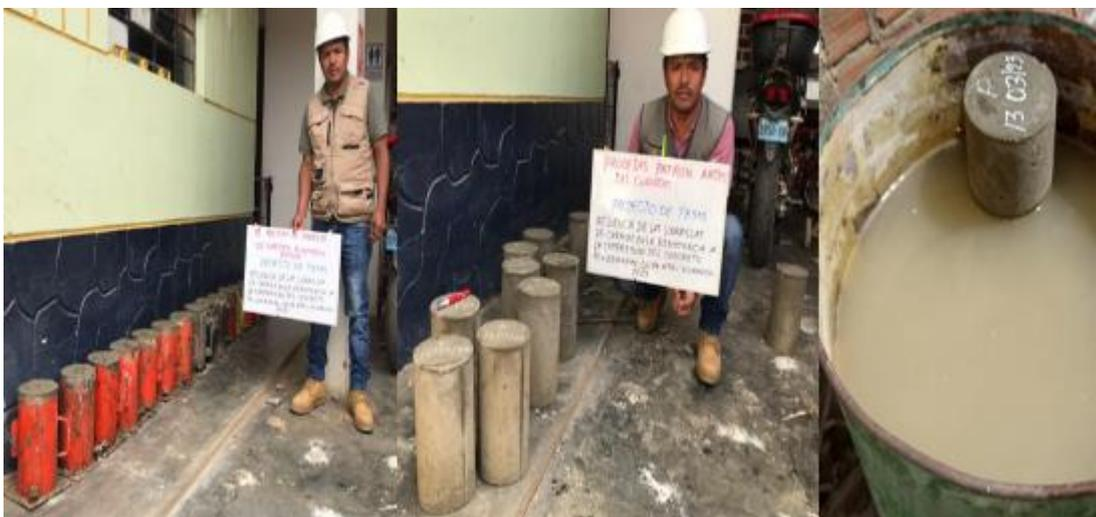
Materiales para las muestras de concreto  $f'_c=210$  kg/cm<sup>2</sup> con adición de varillas de carrizo.
