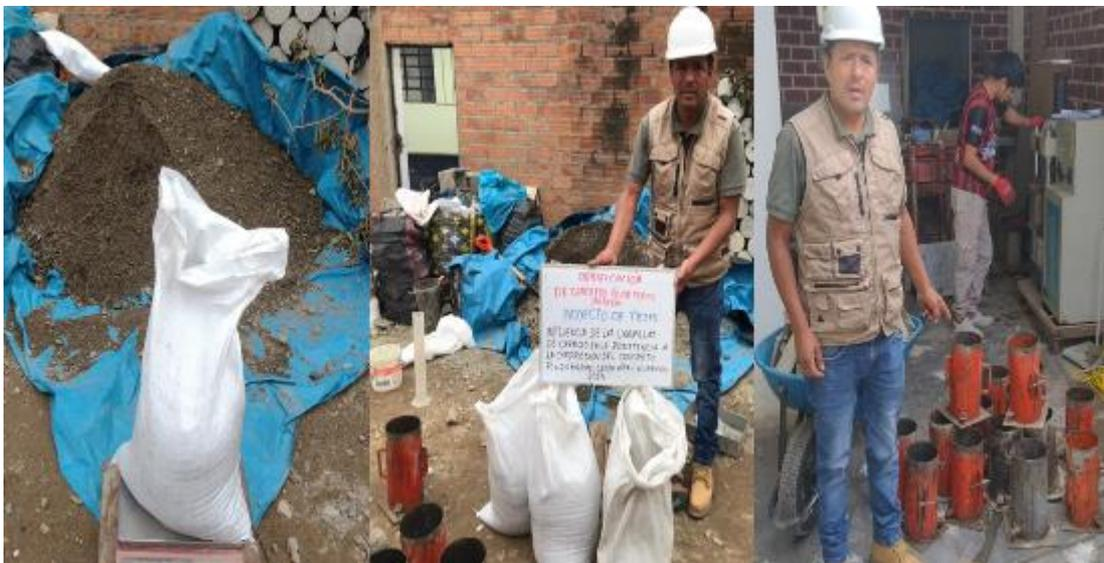
Realizamos la mezcla del concreto patrón  $f'c=210$  kg/cm<sup>2</sup>, colocamos la mezcla en las probetas.
