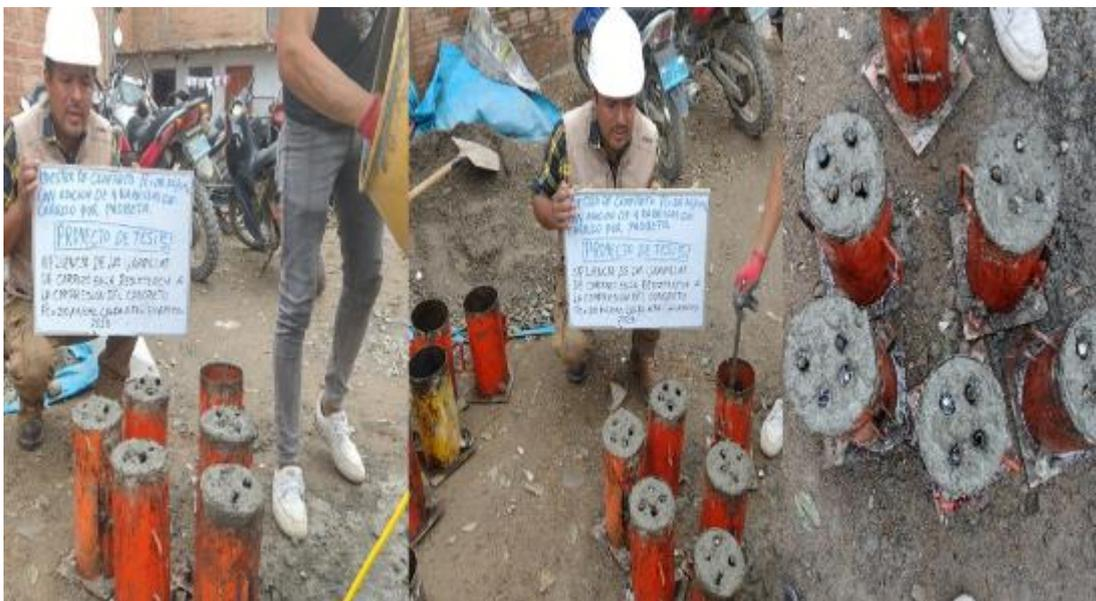
Sacamos las muestras del concreto  $f'c=210$  kg/cm<sup>2</sup> con la adición de 4 varillas de carrizo de las probetas, antes del curado y durante el curado.
