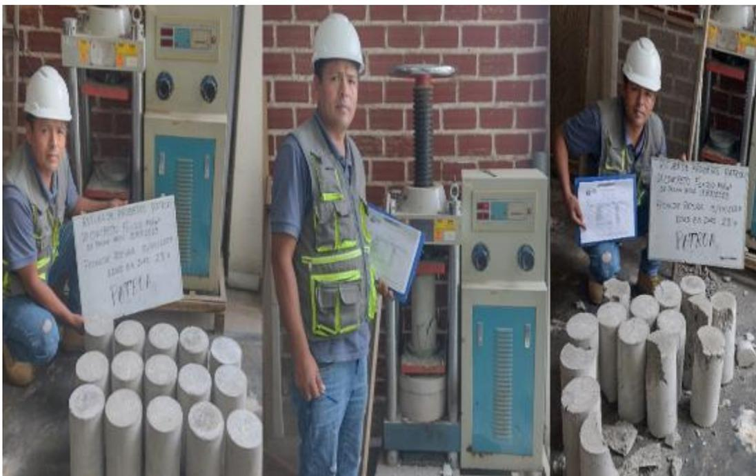
Rotura de probeta de concreto  $f'c=210$  kg/cm<sup>2</sup> con adición de 3 varillas de carrizo, después de los 28 días.
