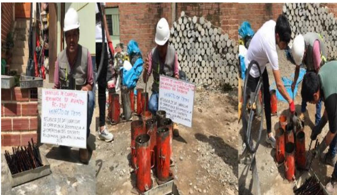
Sacamos las muestras del concreto  $f'c=210$  kg/cm<sup>2</sup> con la adición de 3 varillas de carrizo de las probetas, antes del curado y durante el curado.
