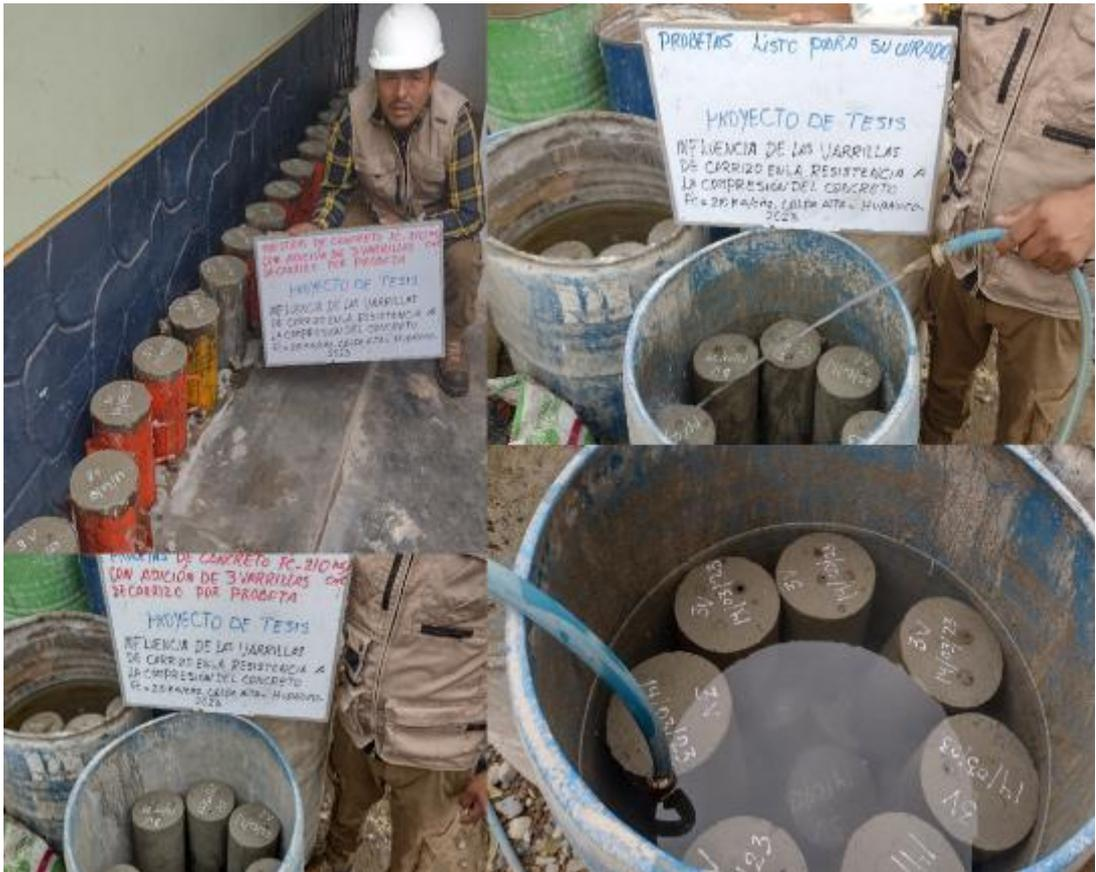
Elaboración del concreto  $f'c=210$  kg/cm<sup>2</sup> con la adición de 4 varillas de carrizo. Colocamos la mezcla de concreto en las probetas.
