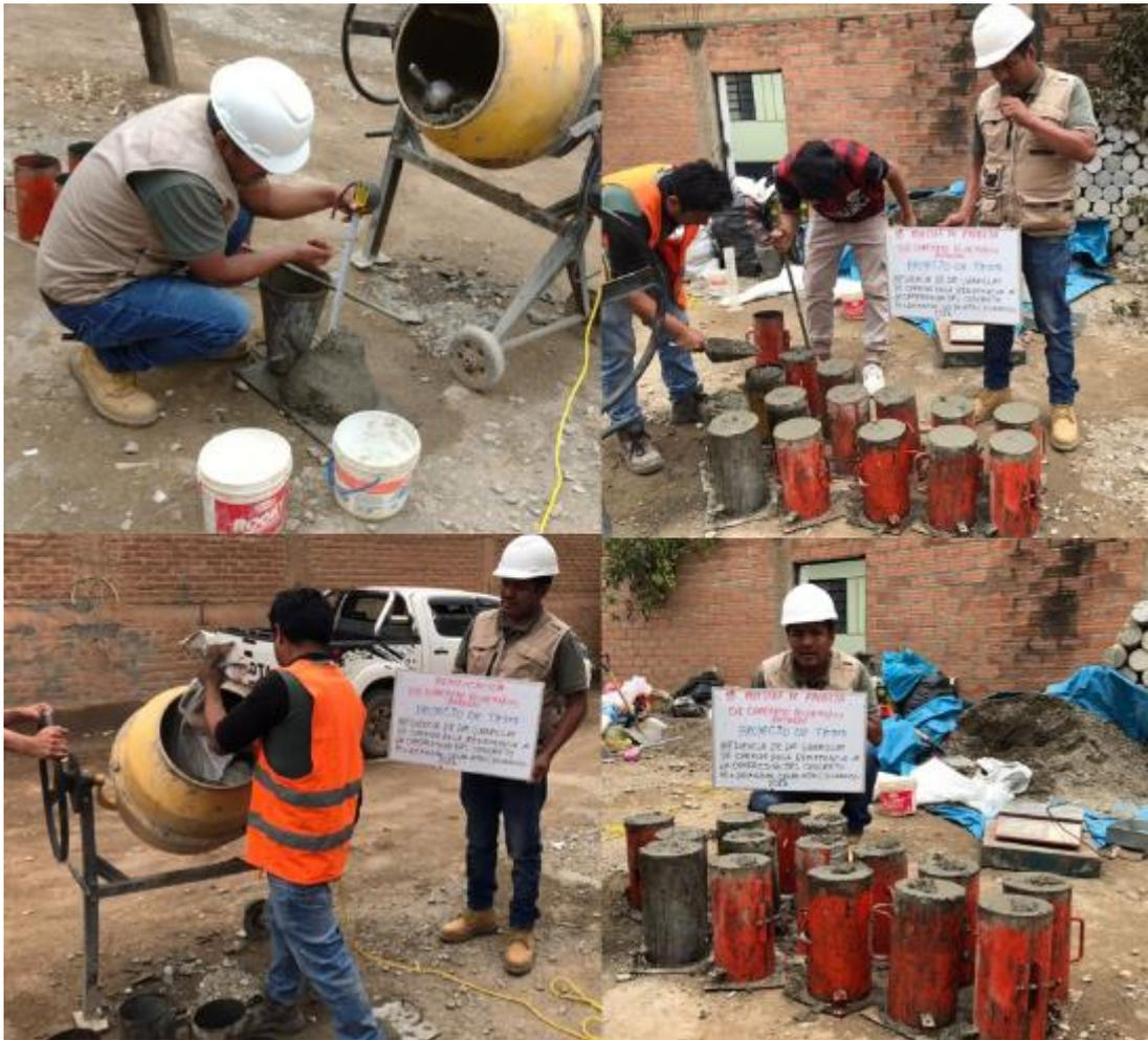
Extraemos el concreto de las probetas y realizamos el curado correspondiente.
