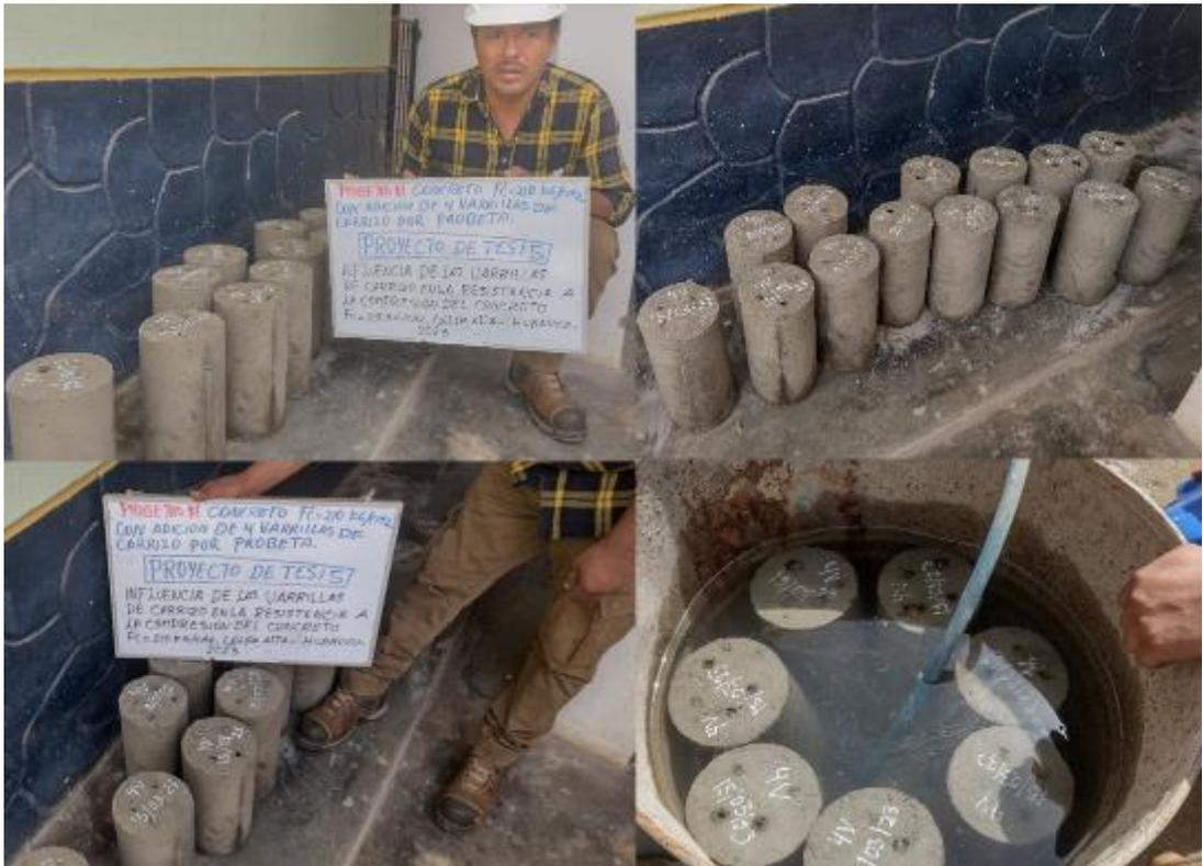
Muestras de concreto  $f'c=210$  kg/cm<sup>2</sup> con la adición de 5 varillas de carrizo.
