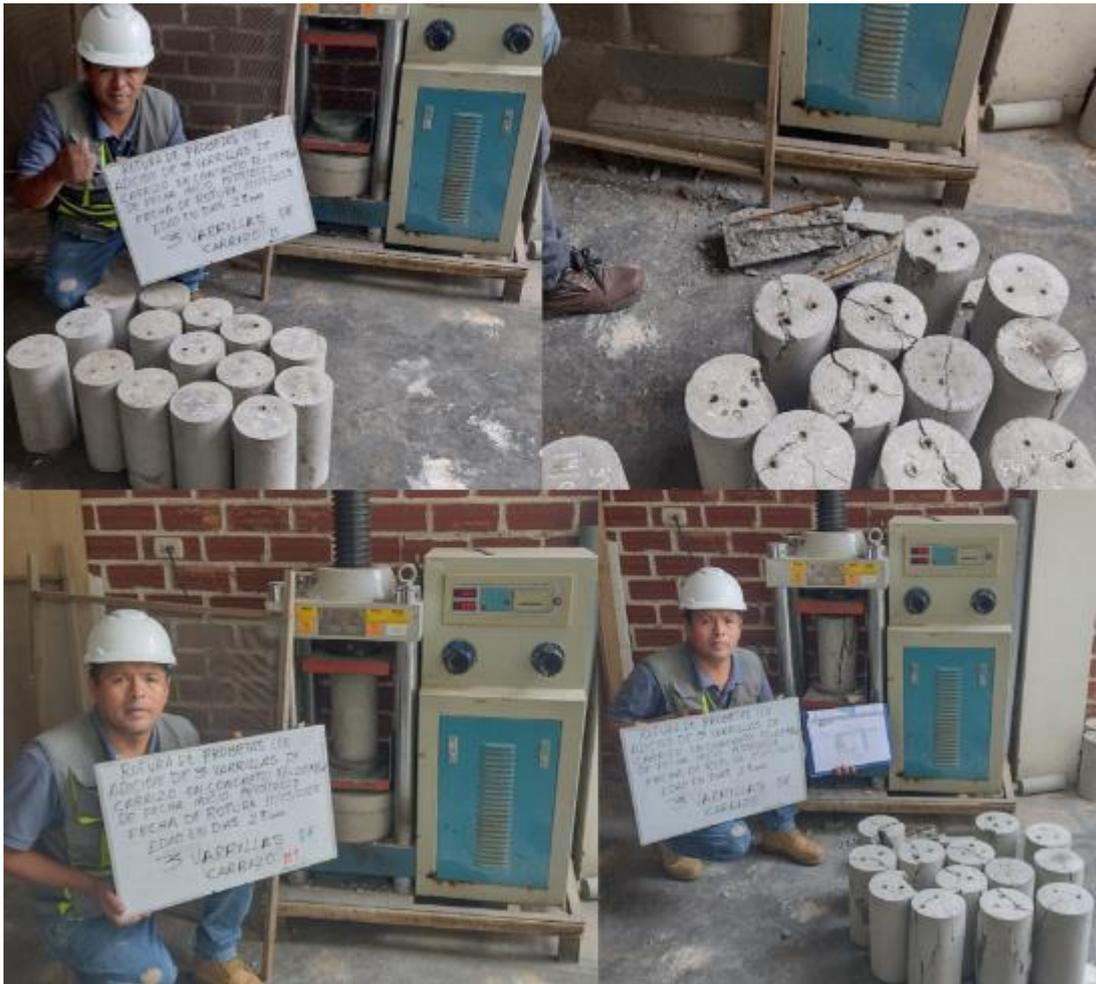
Rotura de probeta de concreto  $f'c=210$  kg/cm<sup>2</sup> con adición de 4 varillas de carrizo, después de los 28 días.
