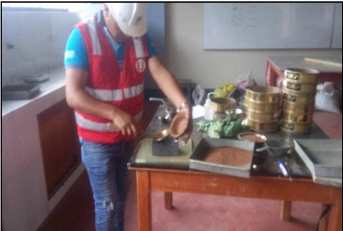
*Nota.* La figura muestra el ensayo de plasticidad.
