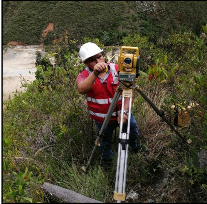
*Nota.* La figura muestra el procedimiento de estacionamiento.
