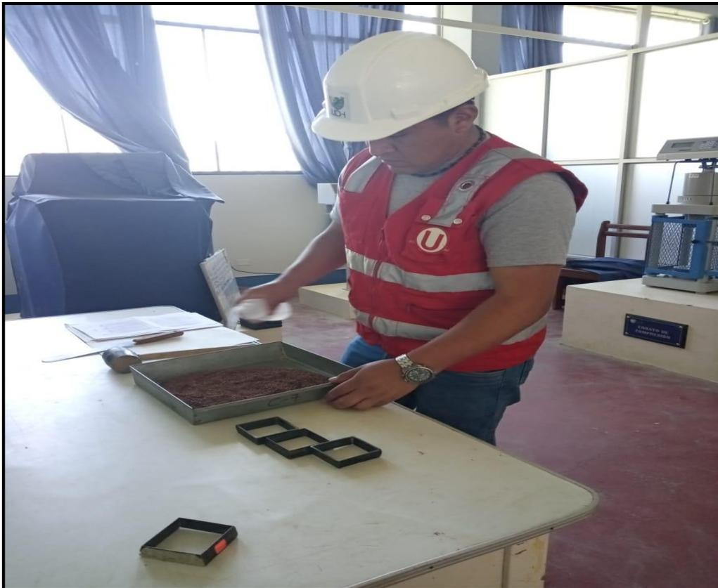
*Nota.* La figura muestra el proceso del ensayo de corte directo.
