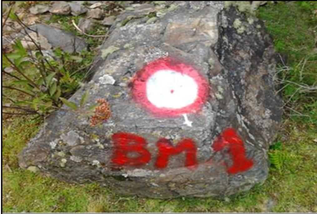
*Nota.* La figura muestra el BM del levantamiento topográfico.
