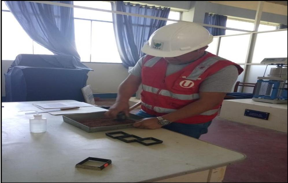
*Nota.* La figura muestra el proceso del ensayo de corte directo.
