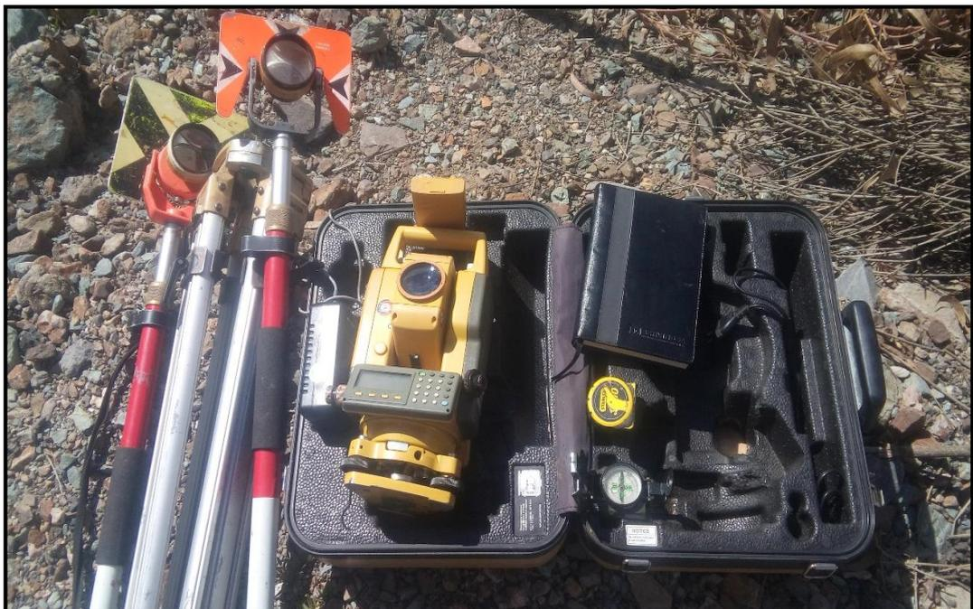
*Nota.* La figura muestra la estación total utilizada.
