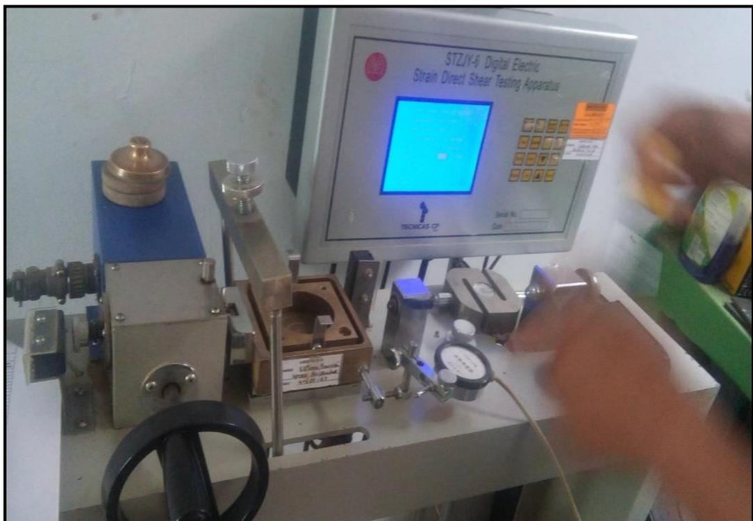
*Nota.* La figura muestra el proceso del ensayo de corte directo.
