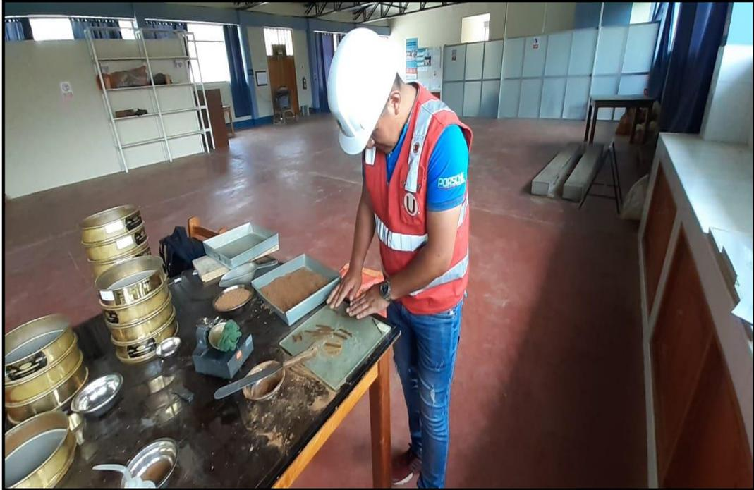
*Nota.* La figura muestra el ensayo de plasticidad.
