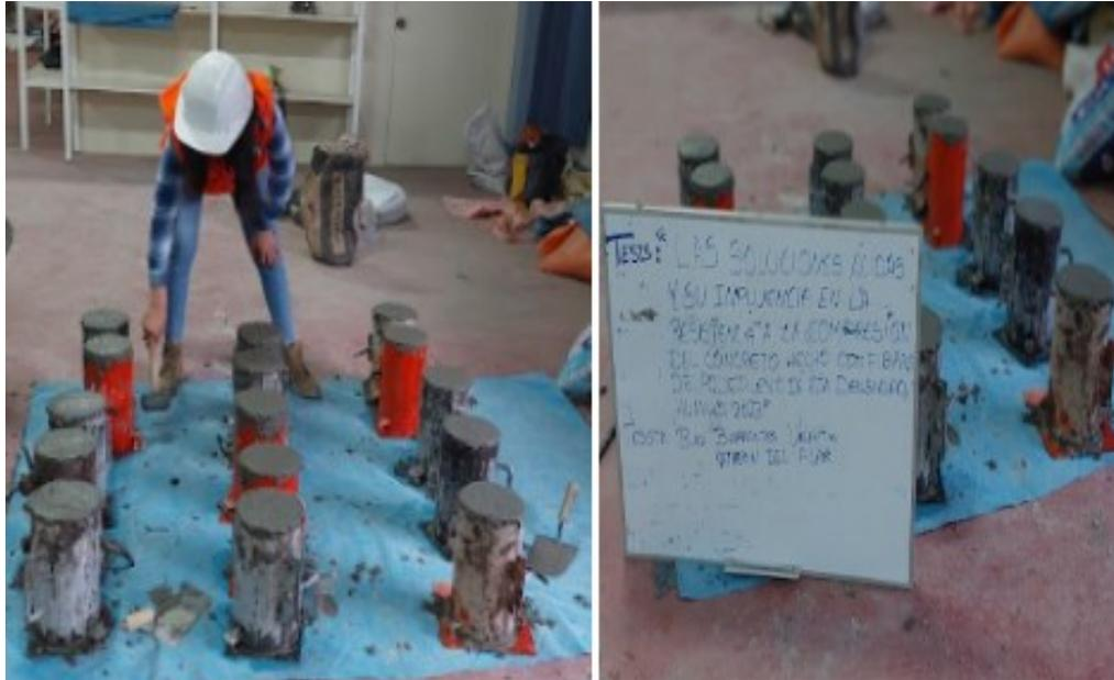
Se trasladó hasta una superficie limpia, seca y libre de impurezas, sobre la cual se realizó el desmoldado retirando el molde
