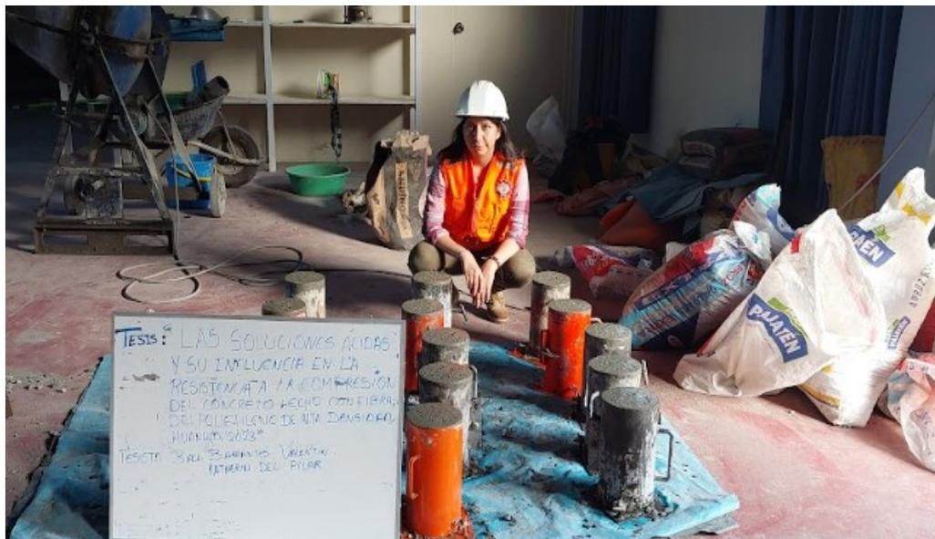
Se inició con la fabricación de las probetas de concreto con la preparación de los materiales se ha empleado los siguientes equipos y herramientas:
