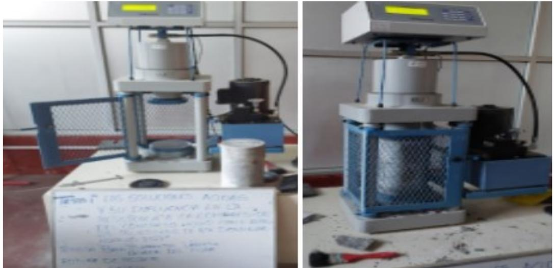
Una vez transcurrido el tiempo de aplicación de la carga hacia el bloque se procedió a retirarlo y a registrar la carga de compresión máxima en las fichas de registro de laboratorio.
