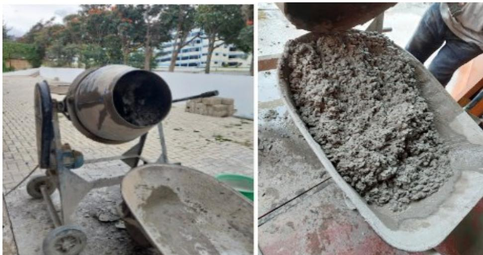
Después del mezclado de los materiales se verifica el asentamiento de la mediante el ensayo del cono de Abrams con fibras de polietileno de alta densidad y solución ácida y encontrándose dentro del rango según para el cual fue diseñado la mezcla.
