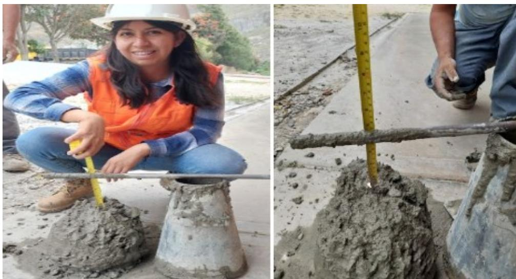
El proceso de moldeo se desarrolló llenando la pasta de concreto sobre el molde metálico.
