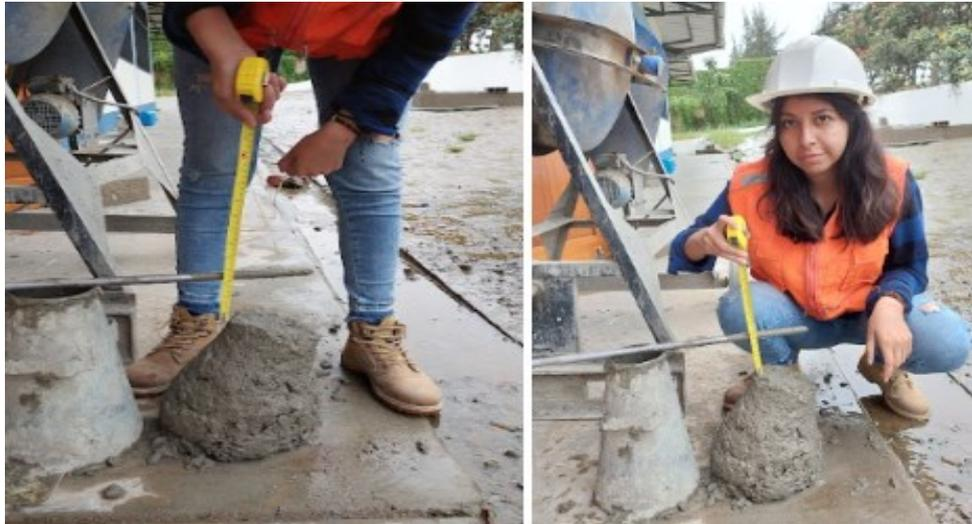
Proceso de moldeo se desarrolló llenando la pasta de concreto con fibras PAT y solución ácida sobre el molde metálico.
