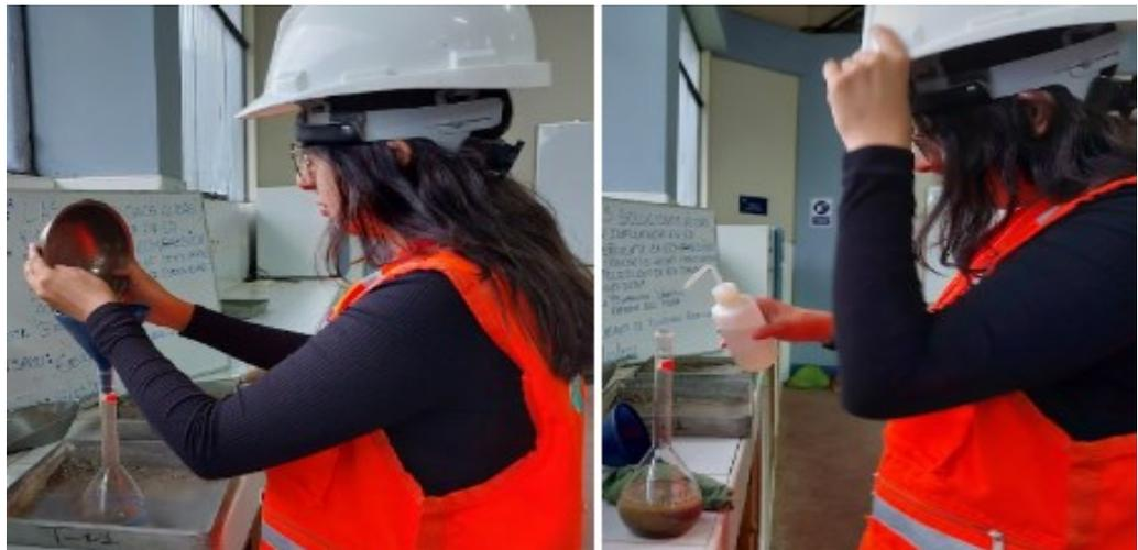
Se procedió el registro de los pesos de los instrumentos sin agregado, Luego con 500gr de agregado fue introducido en la fiola con agua.
