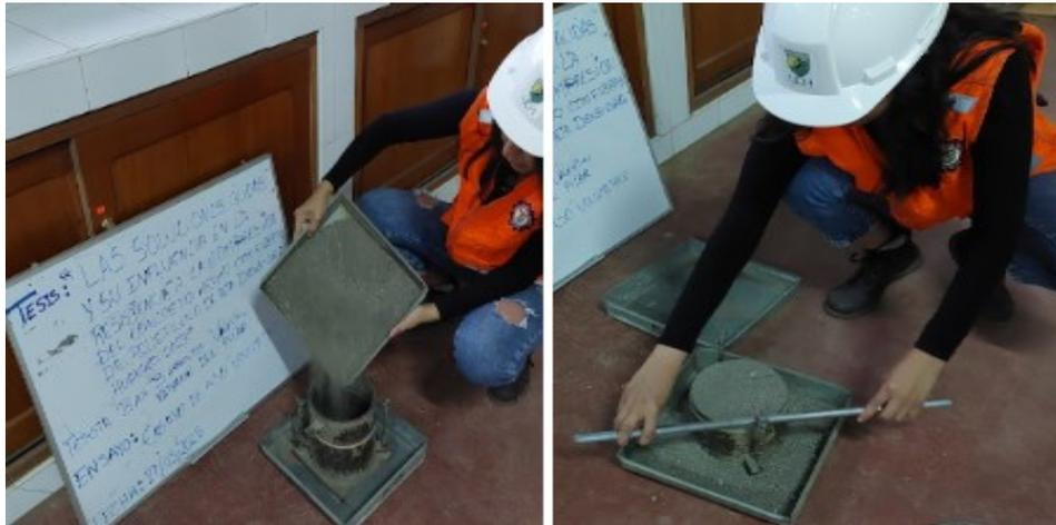
Continuando con el ensayo se procedió nuevamente al llenado del material pétreo grueso sobre el recipiente y finalmente se enrasa sobre la parte superior.
