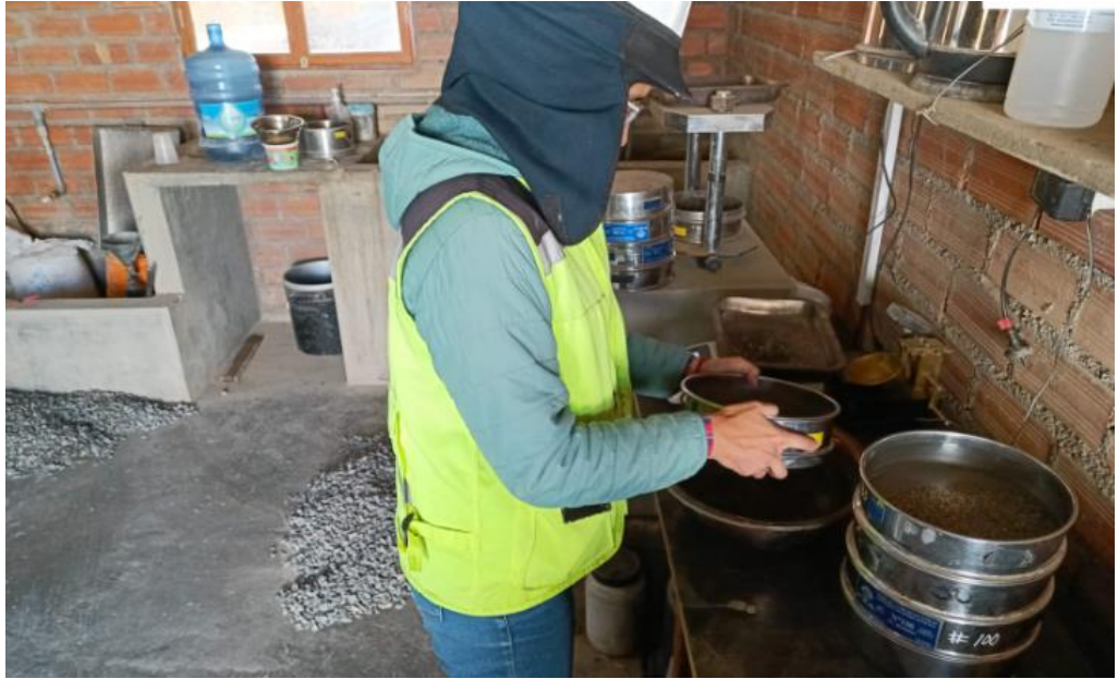
Tamizado del material fino, para realización del ensayo de equivalente de arena.
