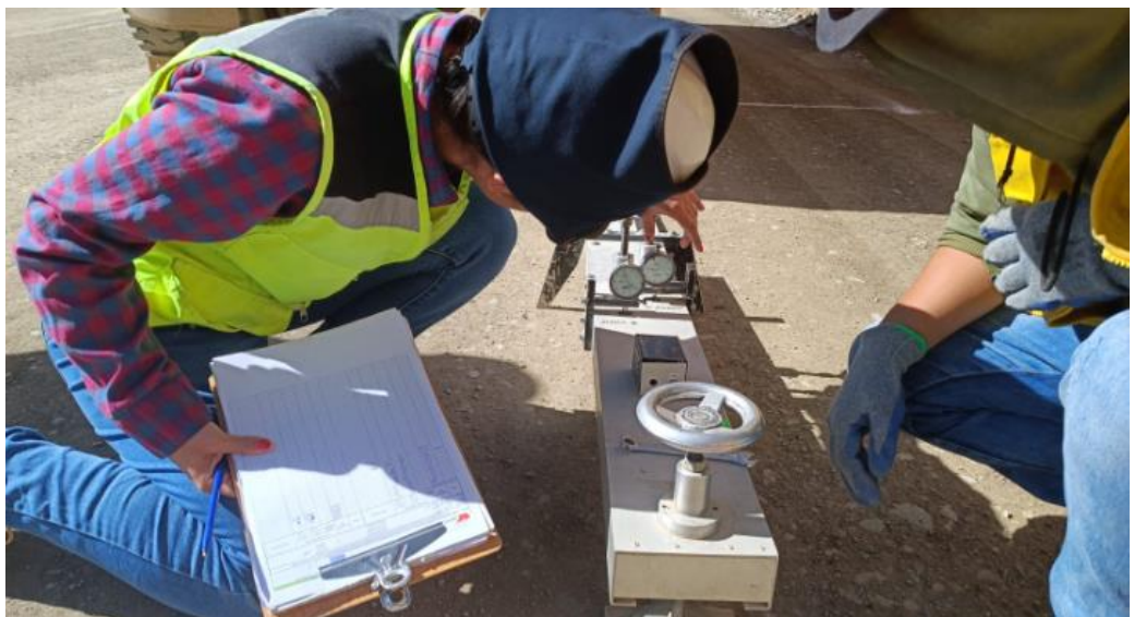
Adecuación de los diales para la realización del ensayo de Viga Benkelman en sub base granular.
