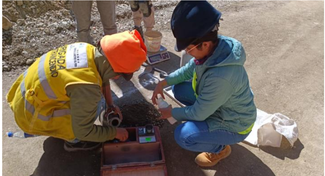
Pesaje del material extraído en el ensayo de densidad de campo y la incorporación del hidruro de carburo en el equipo Speedy.
