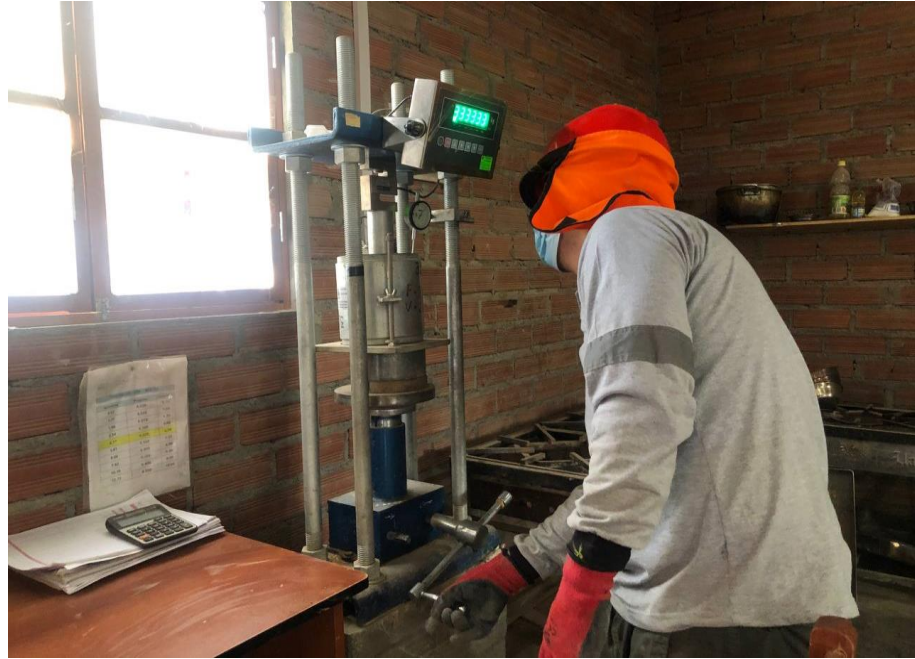
Ensayo CBR del material, para el conocimiento de la máxima densidad seca y el óptimo contenido de humedad.
