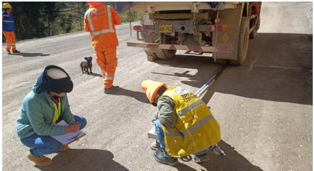
Obtención de resultados menor a la deflexión admisible requerida para la plataforma.
