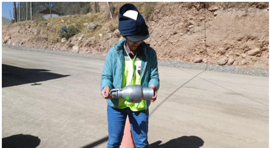
Agitación del contenido del equipo Speedy para esperar la reacción y así conocer el contenido de humedad de la plataforma.
