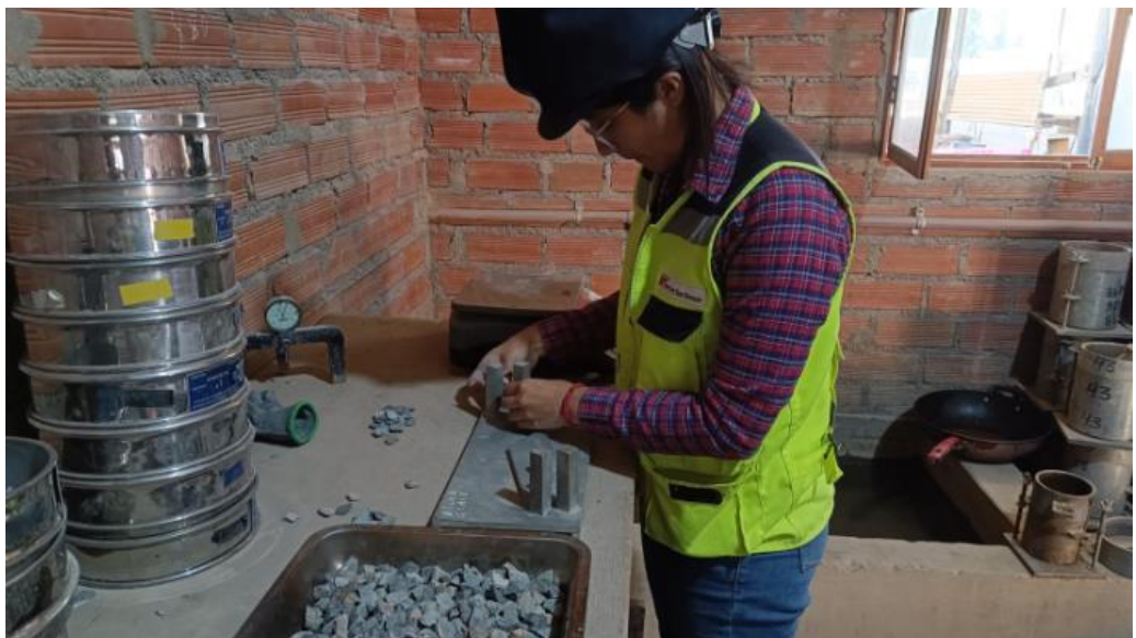
Ensayos de laboratorio para conocer el porcentaje de caras chatas y alargadas que contienen las muestras extraídas.
