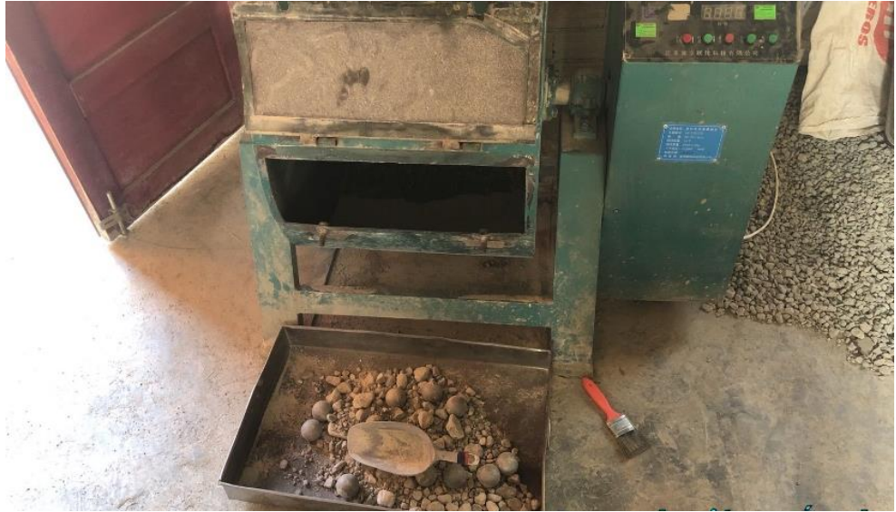
Ensayo de Abrasión de Los Ángeles.
