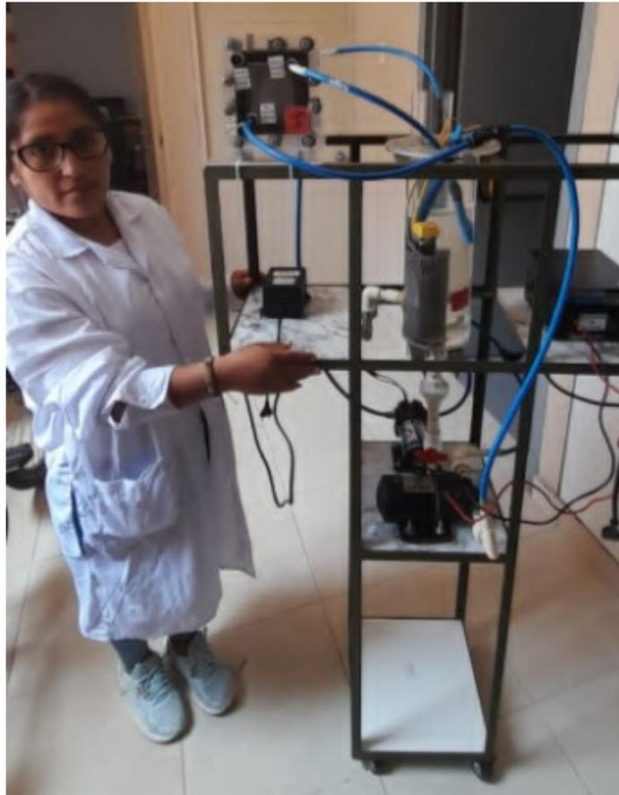
*Nota.* El módulo construido, donde consta de una celda electrolítica con su membrana catiónica, dos bombas, dos depósitos y sus rectificadores correspondiente.
