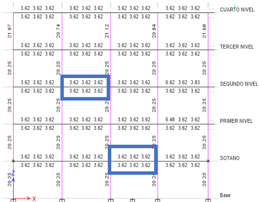
Figura 78 Cuantía para Viga secundaria
