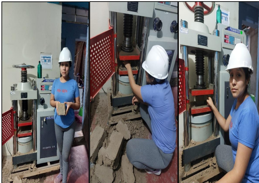
Adobes en el laboratorio sometidos al ensayo específicamente a compresión.
