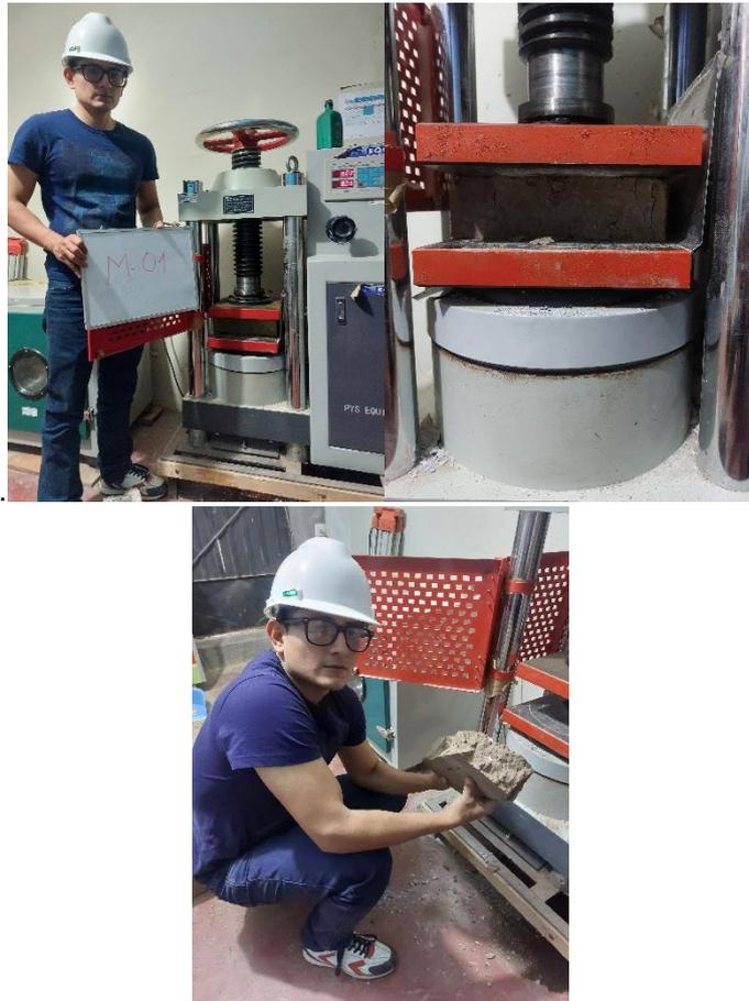
*Nota.* En las imágenes se muestra el procedimiento de ensayo a la compresión.
