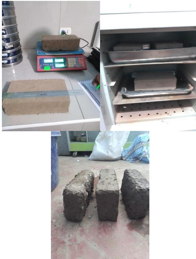
*Nota.* Se observa el proceso de inicio a fin del ensayo de absorción.
