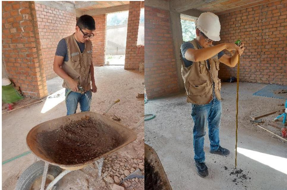
*Nota.* En las imágenes se aprecia el procedimiento realizado para el cálculo del contenido óptimo de humedad en base a la Norma Técnica Peruana E.080.
