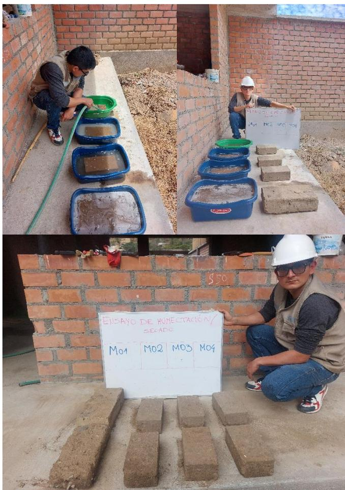
*Nota.* Se muestran los resultados tras completar los 6 ciclos de humectación/secado.
