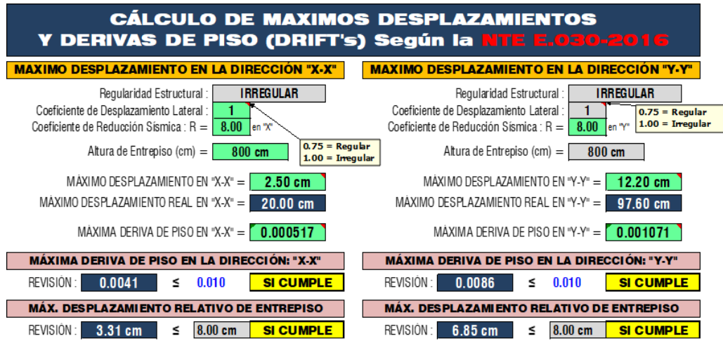
Figura 40 Comprobación de deriva según la norma E030
