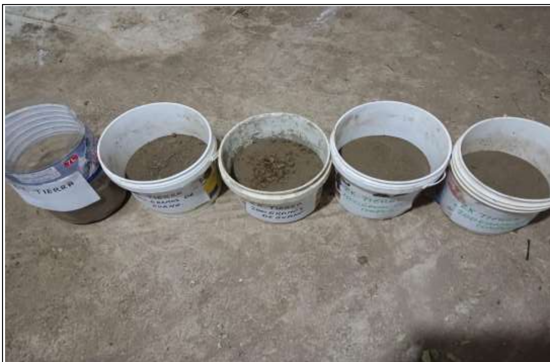
Mezclado de suelo con las enmiendas orgánicas de acuerdo a las dosis (10%=200 g y 20%=400g)
