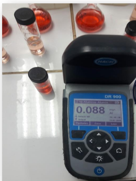
Fotografía N° 14. Medición de Aluminio en las muestras de agua de abastecimiento (cruda).
