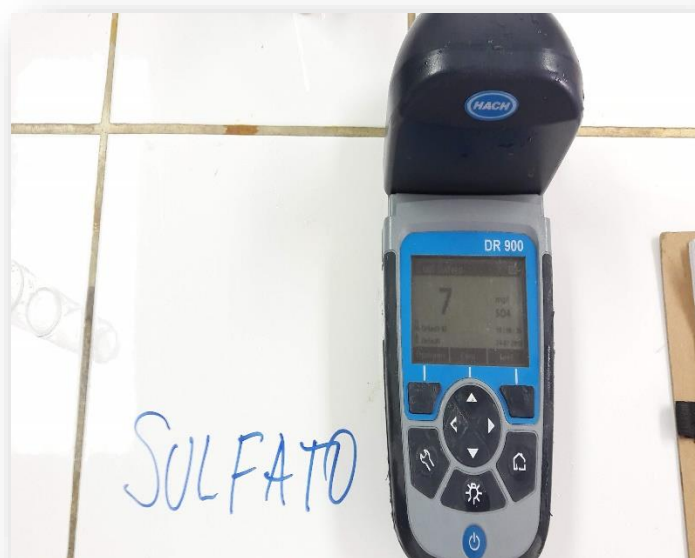
Fotografía N° 12. Medición de Sulfato en las muestras de agua de abastecimiento (cruda).
