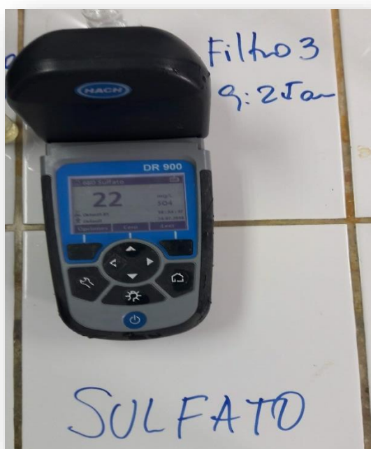
Fotografía N° 8. Medición de Sulfato en las muestras de agua residual.
