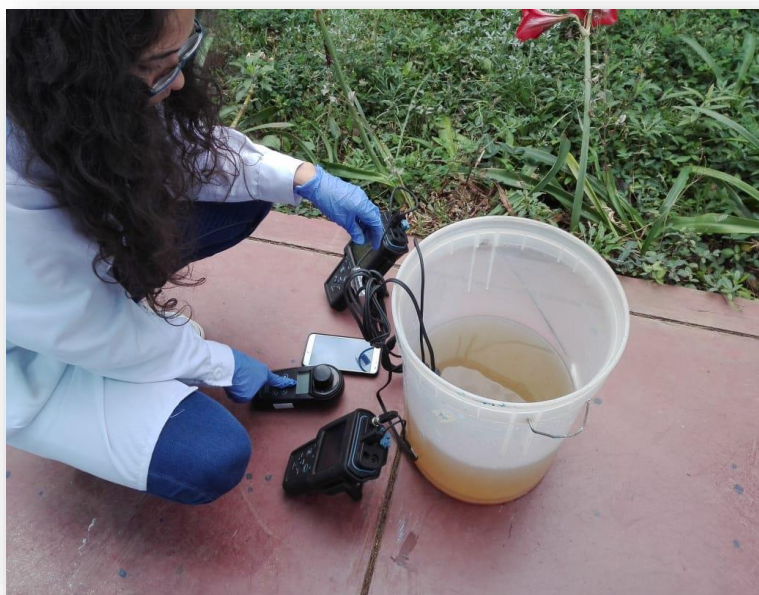
Fotografía N° 4. Medición de pH, temperatura, turbidez y conductividad de la muestra.
