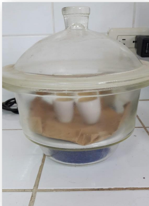
Fotografía N° 11. Papel filtro colocado en el desecador para su posterior pesado.
