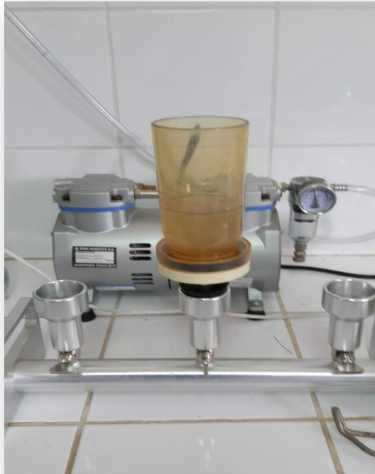
Fotografía N° 9. Filtrado de las muestras (100ml) de aguas residuales para el análisis de STS.
