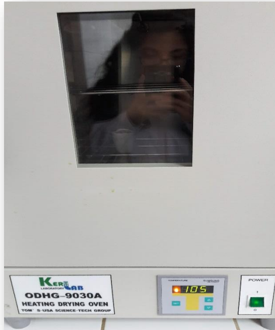
Fotografía N° 10. Papel filtro colocado en la estufa a 105°C.
