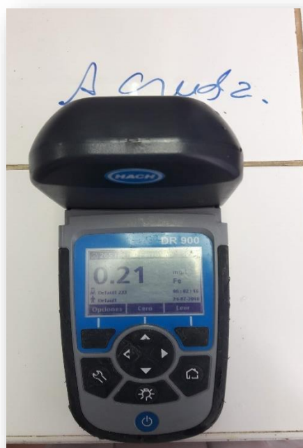
Fotografía N° 13. Medición de Hierro en las muestras de agua de abastecimiento (cruda).
