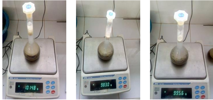
Figura 14. Masa picnómetro + agua + agregado saturado (ensayo de peso específico)
