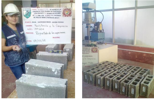
Figura 30. Refrentado con yeso-cemento de las unidades de albañilería
