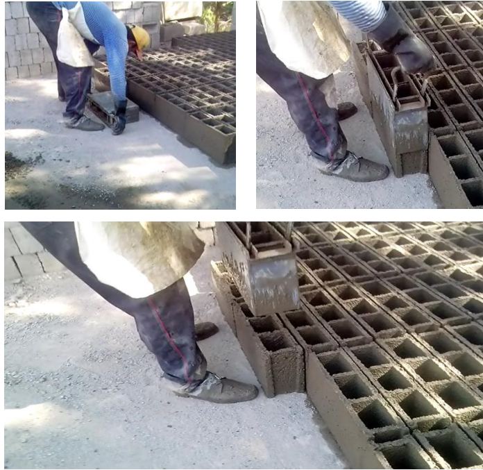
Figura 25. Desmoldeo de las unidades de albañilería
