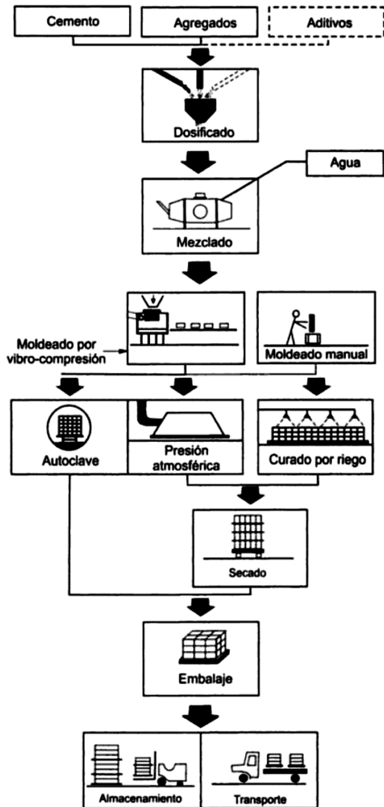
Figura 5. Proceso de fabricación de las unidades de concreto
