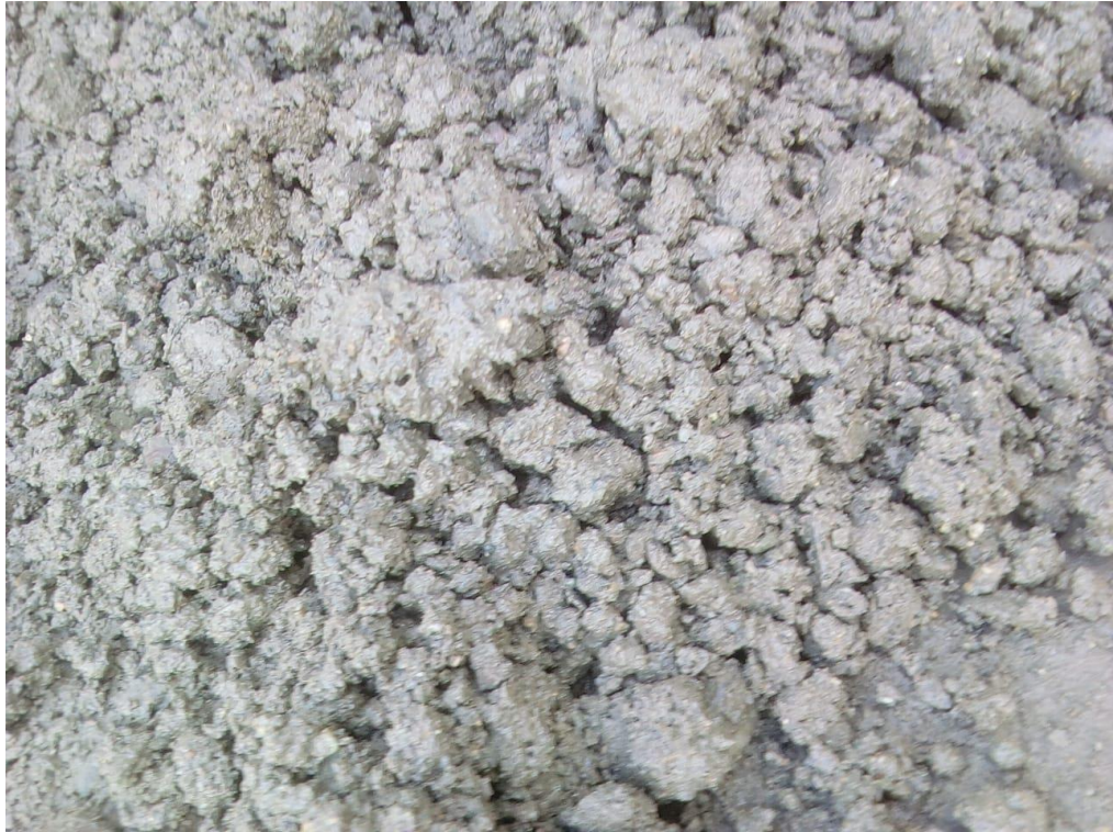
Foto 04. Consistencia húmeda de la mezcla de concreto para elaborar las unidades de albañilería
