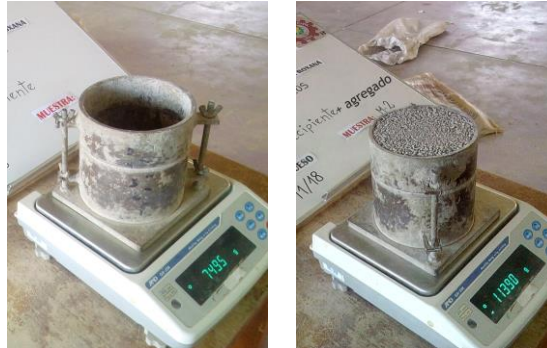
Figura 12. Prueba de peso unitario suelto del agregado fino
