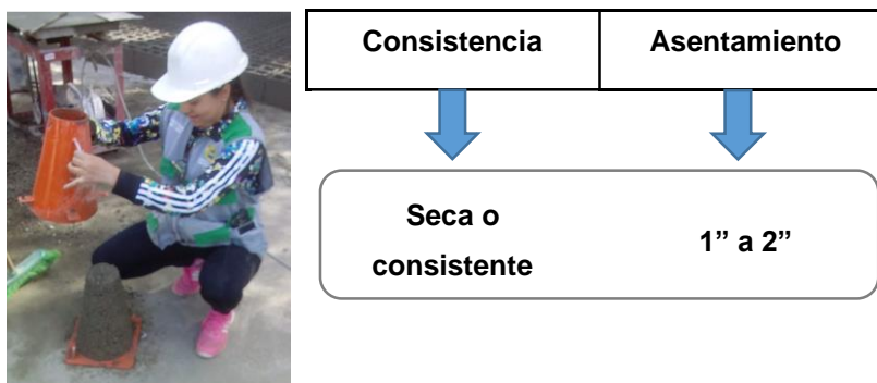
Figura 40. Medición del asentamiento del concreto
