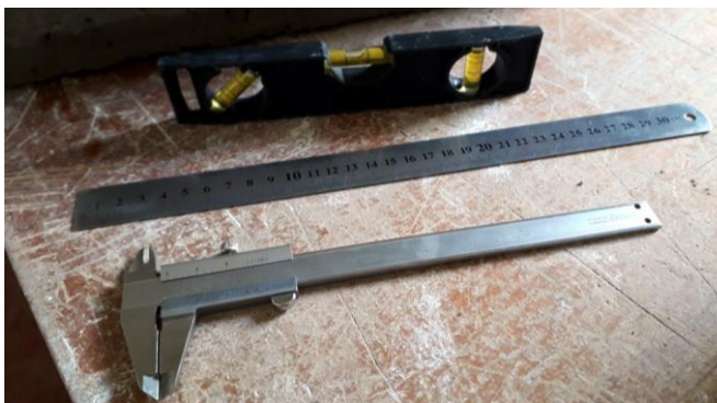
Figura 27. Instrumentos de la prueba variación dimensional
