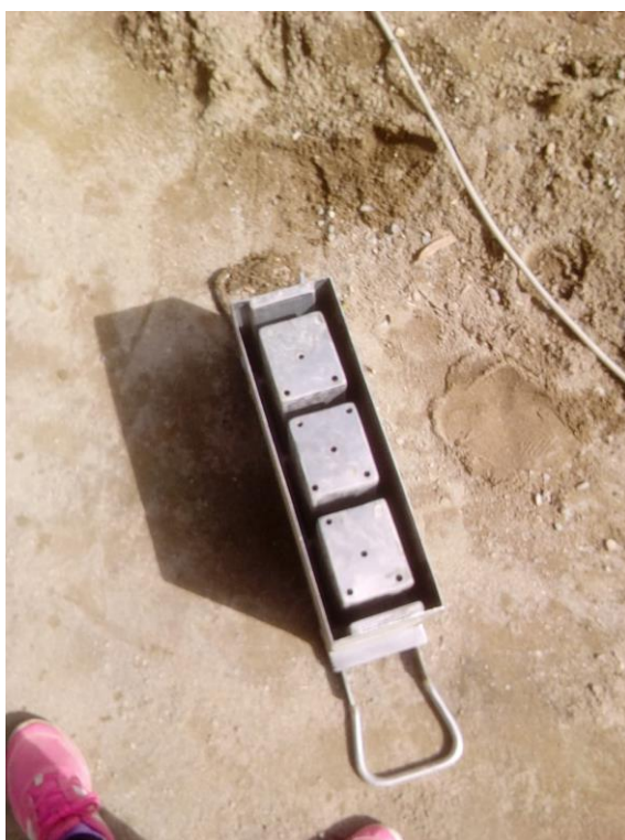
Foto 04. Molde metálico utilizado en la elaboración de bloques de concreto
