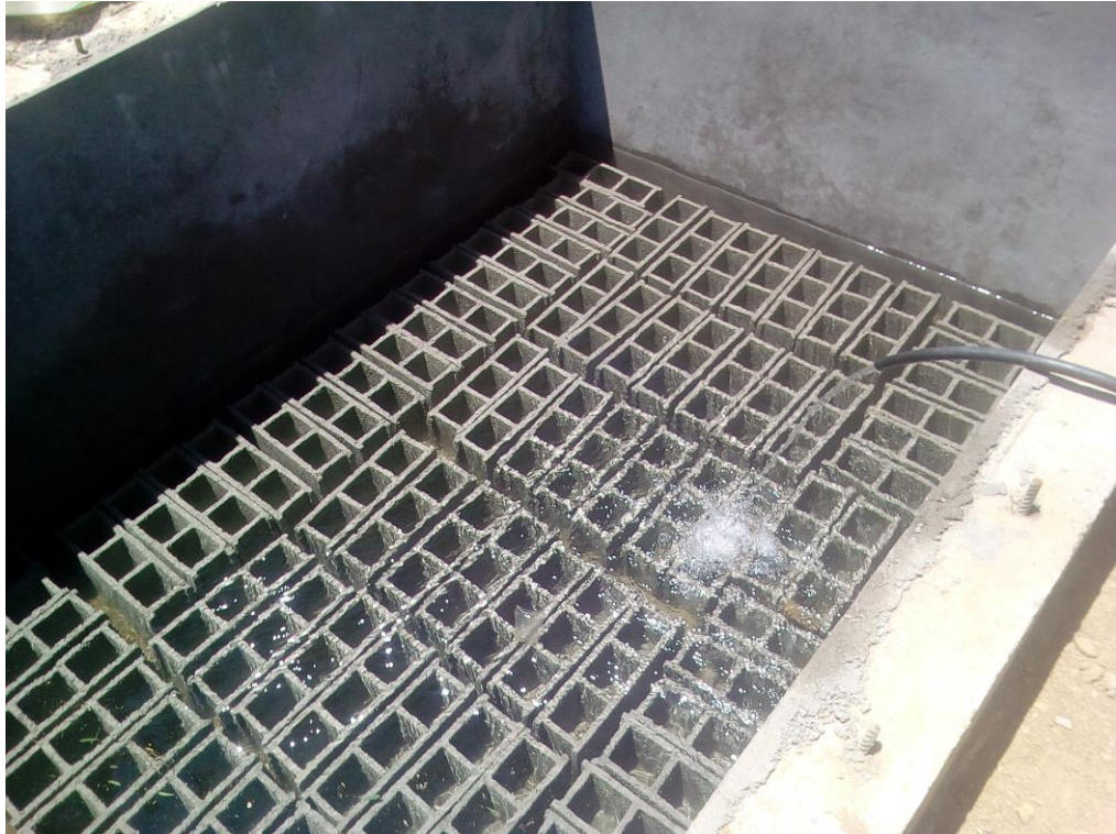
Foto 06. Curado de los bloques de concreto en la posa de la UDH
