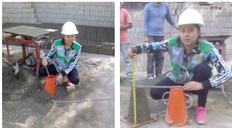
Figura 23. Medición del asentamiento del concreto con el cono de Abrams
