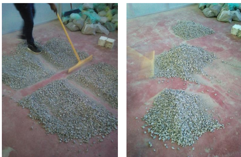
Figura 17. Procedimiento del cuarteo de muestra
