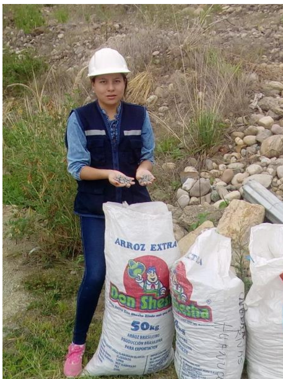
Foto 03. Agregados procedentes de la trituración del pavimento rígido reciclado
