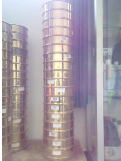
Figura 19. Serie de tamices ordenado progresivamente (análisis granulométrico)
