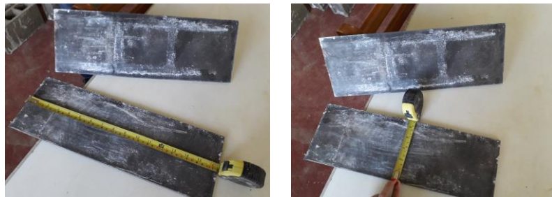
Figura 31. Planchas de soporte de acero con dimensiones de 42x14cm 2
