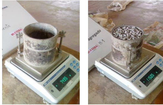
Figura 13. Prueba de peso unitario compactado del agregado grueso
