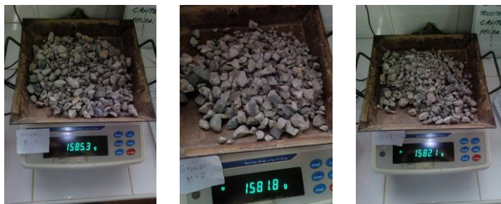
Figura 15. Masa seca del material al horno
