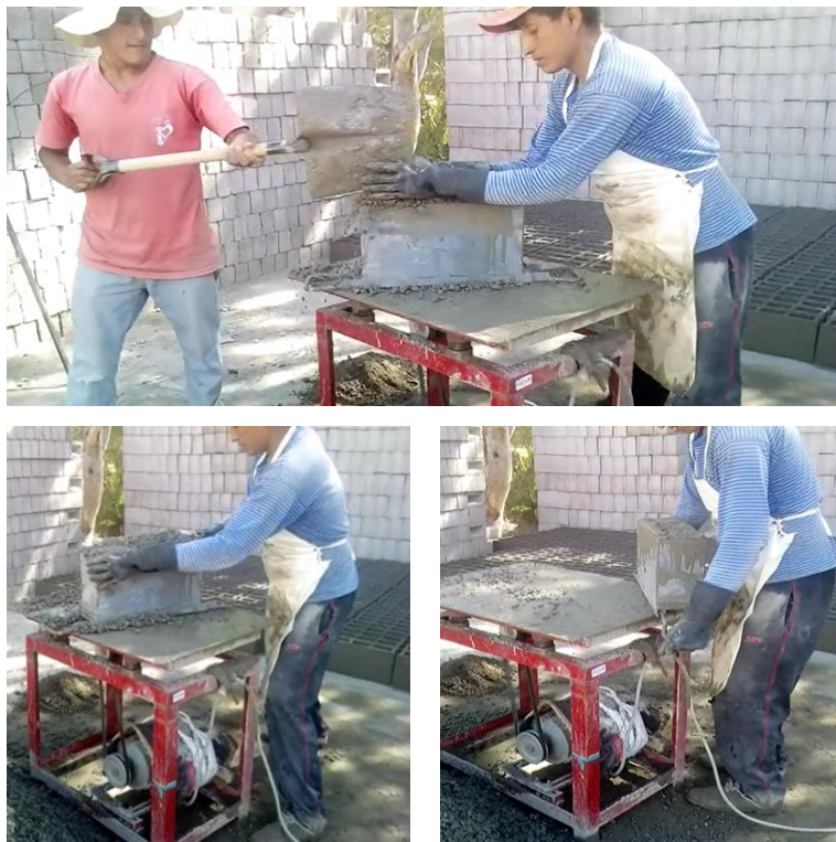
Figura 24. Moldeo de las unidades de albañilería
