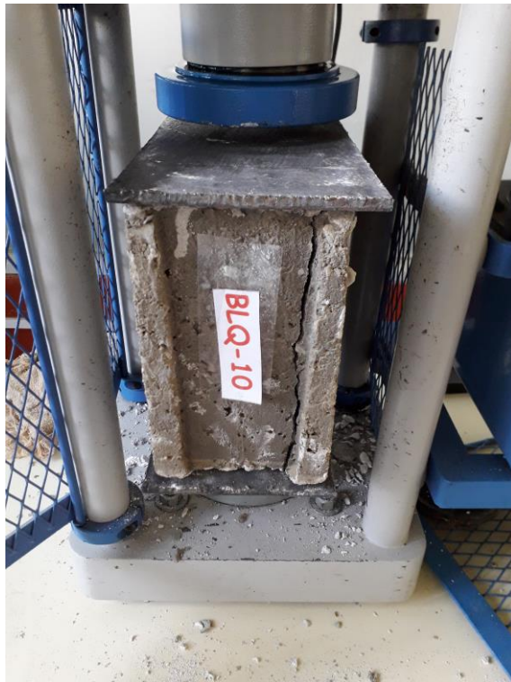
Foto 06. Falla provocada al bloque de concreto producto de la prueba de resistencia a la compresión
