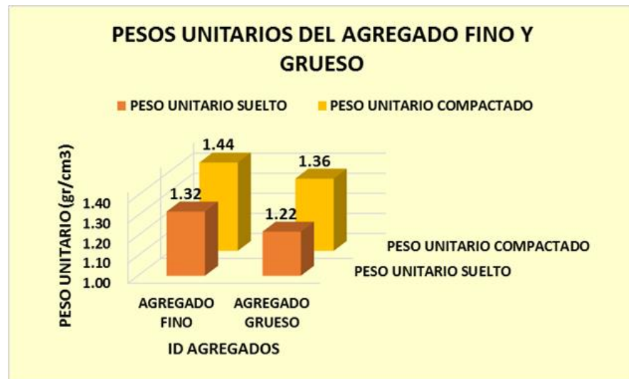
Figura 42. Resultado final de los pesos unitarios del agregado fino y grueso
