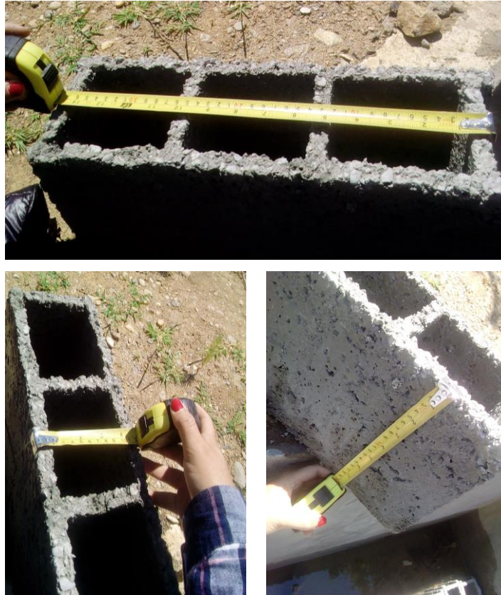
Figura 29. Medición de dimensiones de las unidades de albañilería
