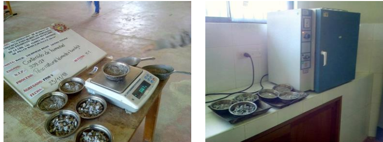
Figura 16. Peso y puesta al horno de la muestra natural húmeda
