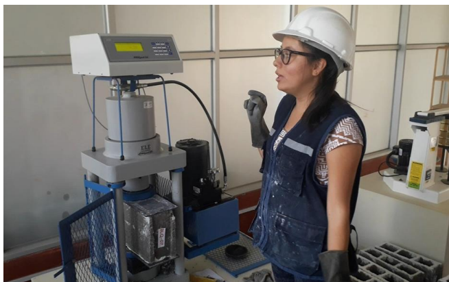
Figura 32. Resistencia a la compresión aplicada a las unidades de albañilería
