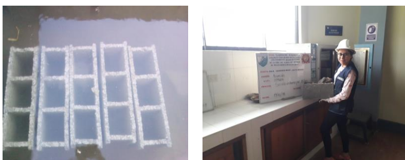
Figura 33. Saturación y secado a horno de las unidades de albañilería (Prueba de absorción)
