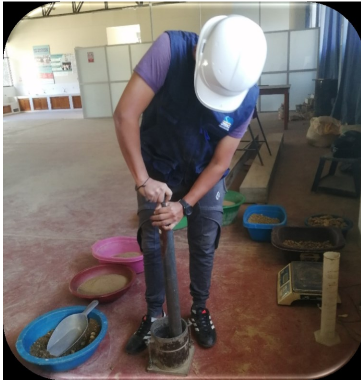
EN LA IMAGEN SE OBSERVA LA REALIZACIÓN DEL ENSAYO DE PROCTOR MODIFICADO DEL AGREGADO DE LA CANTERA SAN ANDRES
