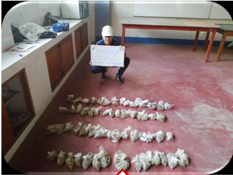
EN LA IMAGEN SE OBSERVA LA CLASIFICACIÓN POR CADA TAMIZ DE MUESTRAS N°1,2,3 Y 4 DEL AGREGADO DE LA CANTERA SAN ANDRES Y LAS MUESTRAS N°1,2,3 Y 4 DEL AGREGADO DE LA CANTERA LA DESPENSA
