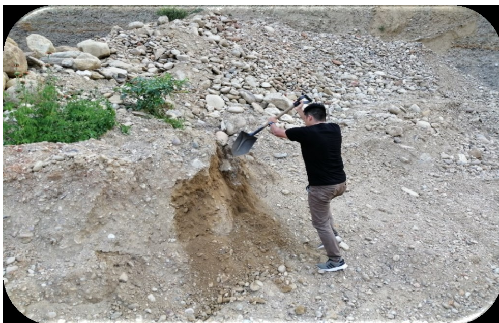
EN LA IMAGEN SE OBSERVA LA EXTRACCIÓN DEL AGREGADO DE CERRO DE LA CANTERA SAN ANDRES PARA REALIZAR LOS ENSAYOS RESPECTIVOS
