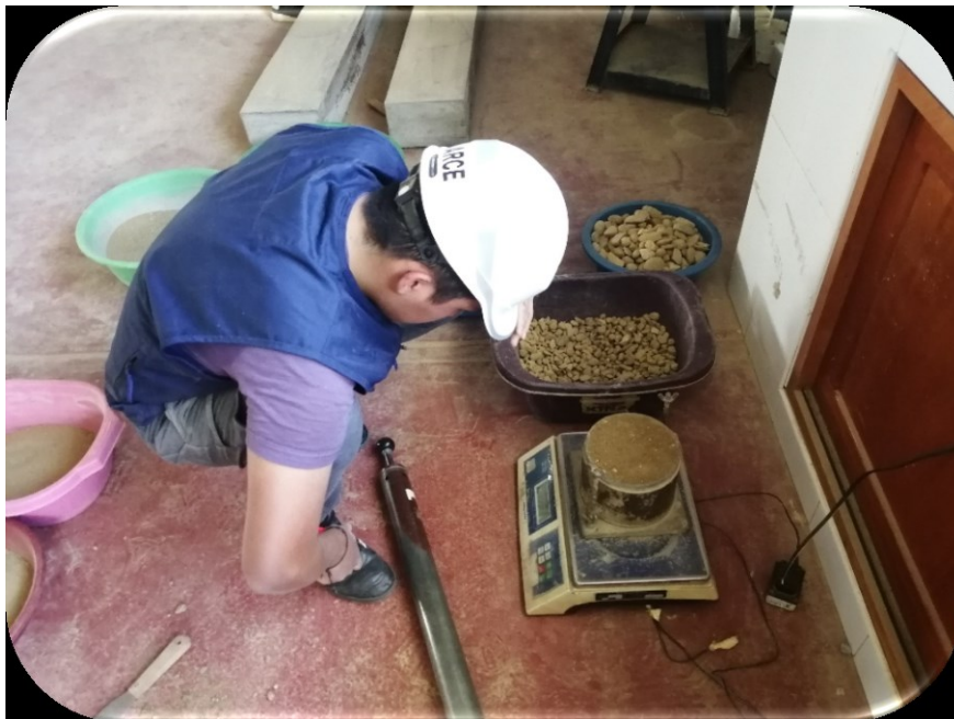
EN LA IMAGEN SE OBSERVA LA REALIZACIÓN DEL ENSAYO DE PROCTOR MODIFICADO DEL AGREGADO DE LA CANTERA SAN ANDRES
