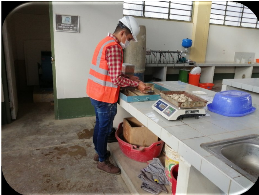
EN LA IMAGEN SE OBSERVA EL ENSAYO DE ABRASIÓN LOS ANGELES DE LA MUESTRA DEL AGREGADO DE CERRO EN UN 90%+ AGREGADO DE RIO - PIEDRA CHANCADA ½" 10%
