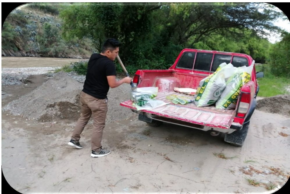
EN LA IMAGEN SE OBSERVA LA EXTRACCIÓN DEL AGREGADO DE RIO DE LA CANTERA LA DESPENSA PARA REALIZAR LOS ENSAYOS RESPECTIVOS
