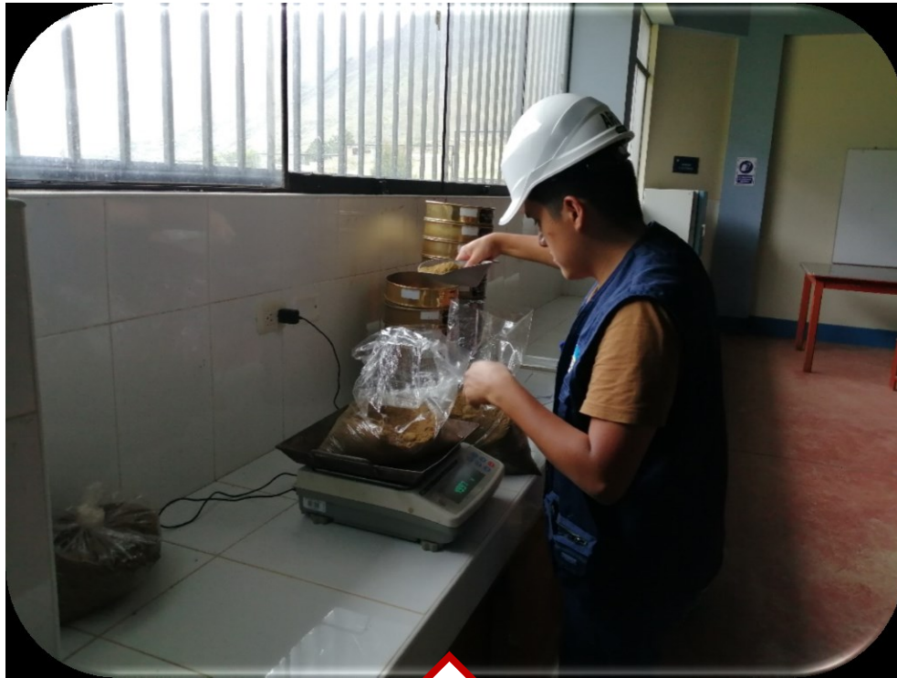
EN LA IMAGEN SE OBSERVA EL PESO DE LA MUESTRA N°3 DEL AGREGADO DE LA CANTERA SAN ANDRES
