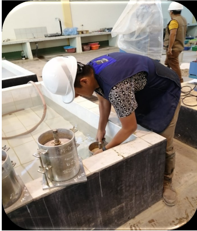
EN LA IMAGEN SE OBSERVA SUMERGIENDO LOS MOLDES EN AGUA PARA PORDER OBETENER LA SATURACIÓN DE LA MUESTRA
