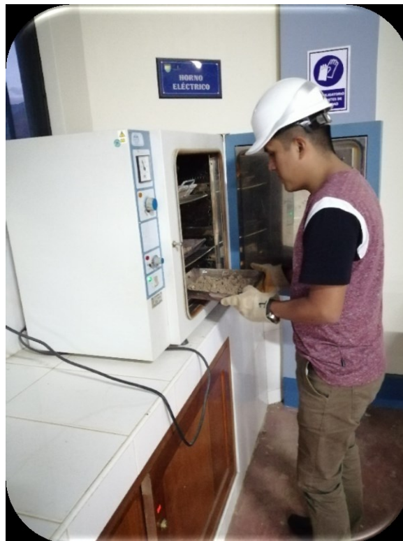
EN LA IMAGEN SE OBSERVA EL RETIRO DE LAS MUESTRAS DEL ENSAYO DEL PROCTOR MODIFICADO DEL HORNO
