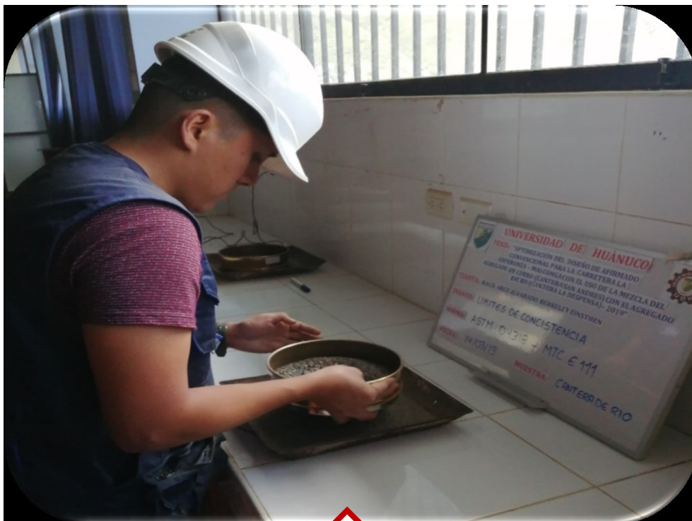
EN LA IMAGEN SE OBSERVA LA SELECCIÓN DE LA MUESTRA PARA EL ENSAYO DE LOS LIMITES DE CONSISTENCIA DEL AGREGADO DE LA CANTERA LA DESPENSA
