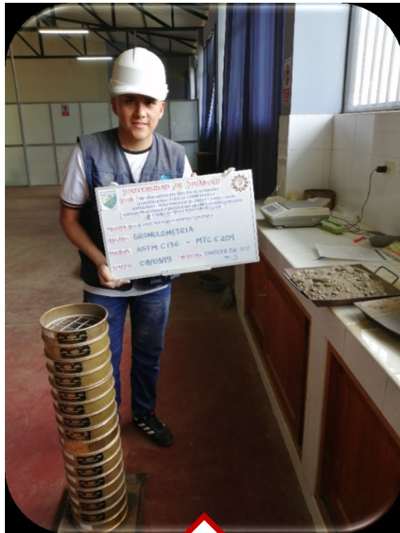
EN LA IMAGEN SE OBSERVA EL TAMIZADO DE LA MUESTRA N°3 DEL AGREGADO DE RIO DE LA CANTERA LA DESPENSA
