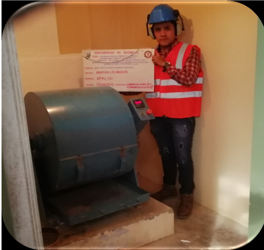
EN LA IMAGEN SE OBSERVA EL ENSAYO DE ABRASIÓN LOS ANGELES DE LA MUESTRA DEL AGREGADO DE CERRO EN UN 90%+ AGREGADO DE RIO - PIEDRA CHANCADA ½" 10%
