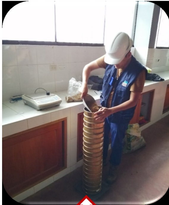
EN LA IMAGEN SE OBSERVA EL TAMIZADO DE LA MUESTRA N°2 DEL AGREGADO DE CERRO DE LA CANTERA SAN ANDRES
