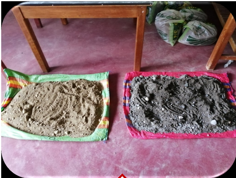
EN LA IMAGEN SE OBSERVA EL SECADO A TEMPERATURA AMBIENTE PARA OBTENER LA HUMEDAD NATURAL DE LAS MUESTRAS
