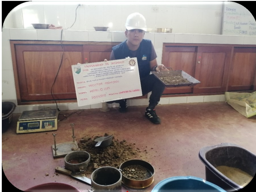
EN LA IMAGEN SE OBSERVA LA SELECCIÓN DE 600 gr DE LA MUESTRA DEL ENSAYO DE PROCTOR MODIFICADO PARA EL SECADO EN EL HORNO
