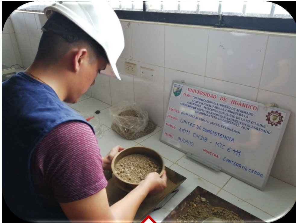
EN LA IMAGEN SE OBSERVA LA SELECCIÓN DE LA MUESTRA PARA EL ENSAYO DE LOS LIMITES DE CONSISTENCIA DEL AGREGADO DE LA CANTERA SAN ANDRES
