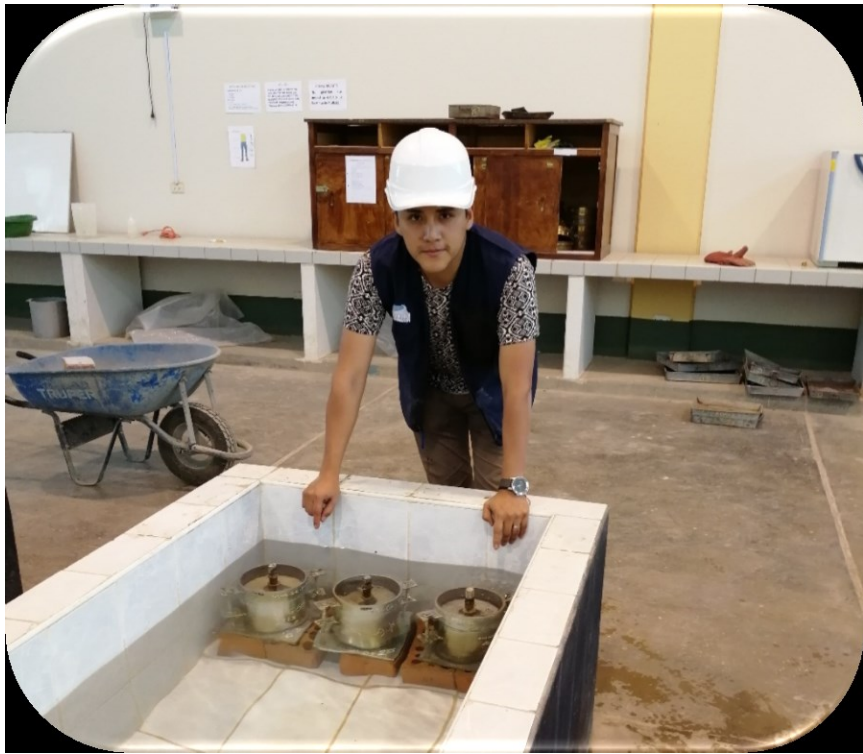
EN LA IMAGEN SE OBSERVA SUMERGIENDO LOS MOLDES EN AGUA PARA PORDER OBETENER LA SATURACIÓN DE LA MUESTRA
