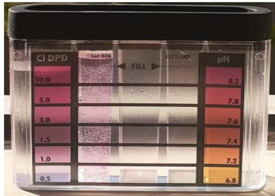
Foto 3 Instrumento= Clorímetro, que sirve para medir la cantidad de cloro en el agua.
