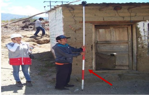
Foto 15 Realizando el levantamiento topográfico de las viv., usando prismas.
