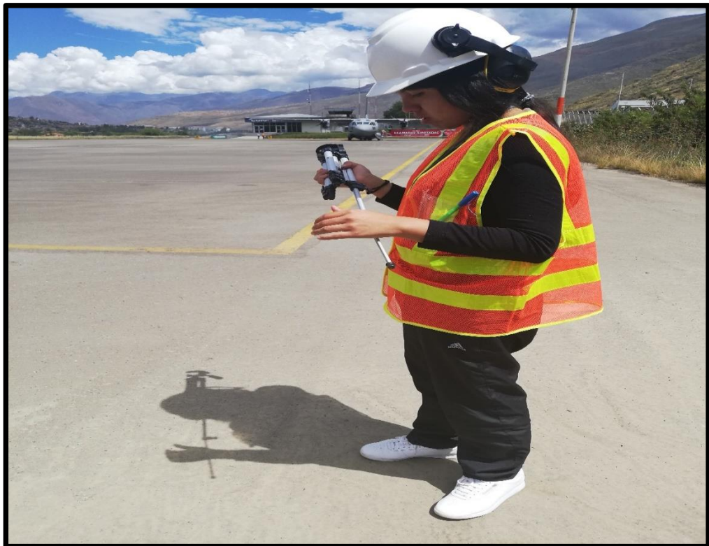
FOTOGRAFÍA 03 y 04. Instalación de los equipos y materiales a utilizar para el respectivo monitoreo de ruido en el Aeropuerto Alf. Fap David Figueroa Fernandini.
