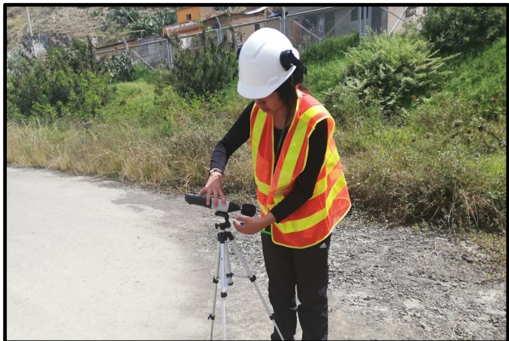
FOTOGRAFÍA 05 y 06. Instalación del sonómetro a utilizar para el respectivo monitoreo ruido en el Aeropuerto Alf. Fap David Figueroa Fernandini.
