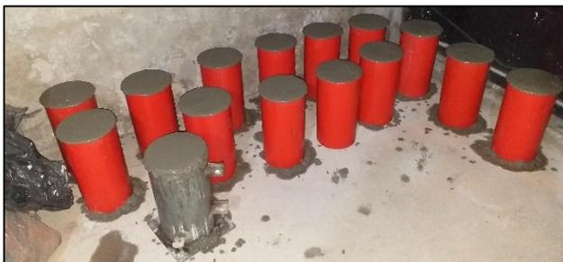
Se puede observar en la figura 14, las probetas cilíndricas en estado fresco, para su obtención y manipulación se abordó bajo los procedimientos antes indicados.
