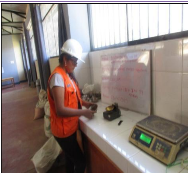
FOTOGRAFÍA N° 87: La obtención de la muestra húmeda se pesa para colocarlo al horno y obtener su peso seco.
