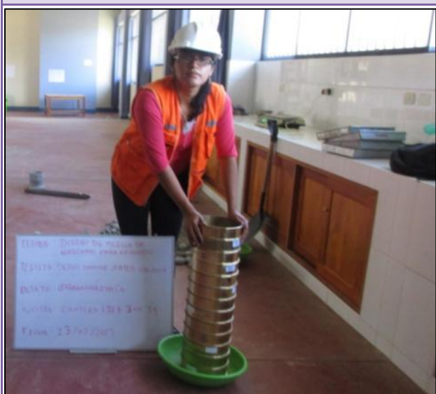
FOTOGRAFÍA N° 80: Se realizó el tamizado del material de cantera.
