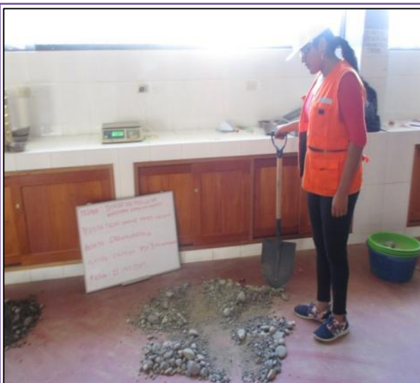
FOTOGRAFÍA N° 71: Cuarteo de muestras del material de cantera.
