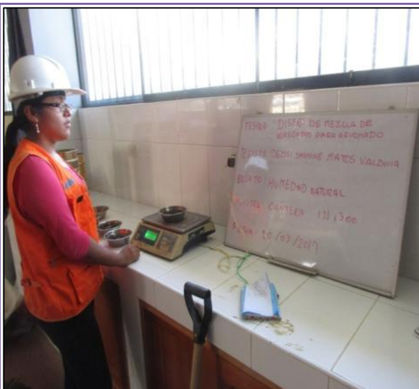
FOTOGRAFÍA N° 67: Se obtuvo las muestras secas y posteriormente se pesó las muestras M-1, M-2, M-3 de las canteras.
