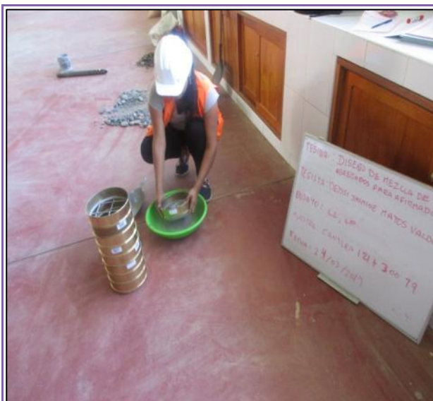
FOTOGRAFÍA N° 82: Se realiza el tamizado por la malla N° 40 de cada uno de los materiales de cantera para realizar el ensayo de Límites Líquido y Plástico.
