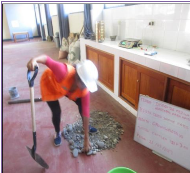
FOTOGRAFÍA N° 70: Cuarteo de muestras del material de cantera.
