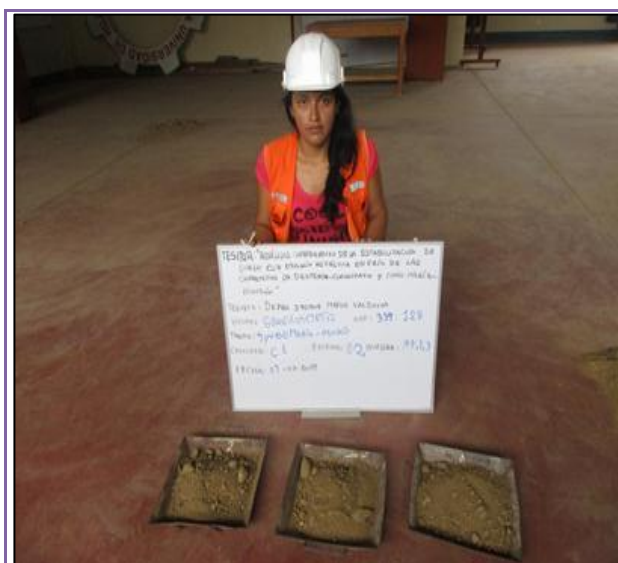
FOTOGRAFÍA N° 35: Se realizó el tamizado de las C-1, C-2 y C-3 de la carretera Bella – Inti.
