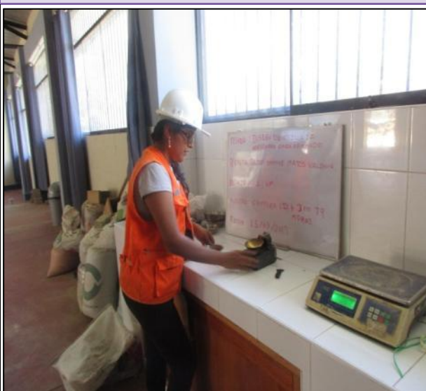
FOTOGRAFÍA N° 85: Posteriormente se pesó la muestra para saturarla con agua destilada y realizar las pruebas.
