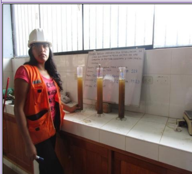
FOTOGRAFÍA N° 92: Realizando el ensayo de Equivalente de Arena de los materiales de cantera.
