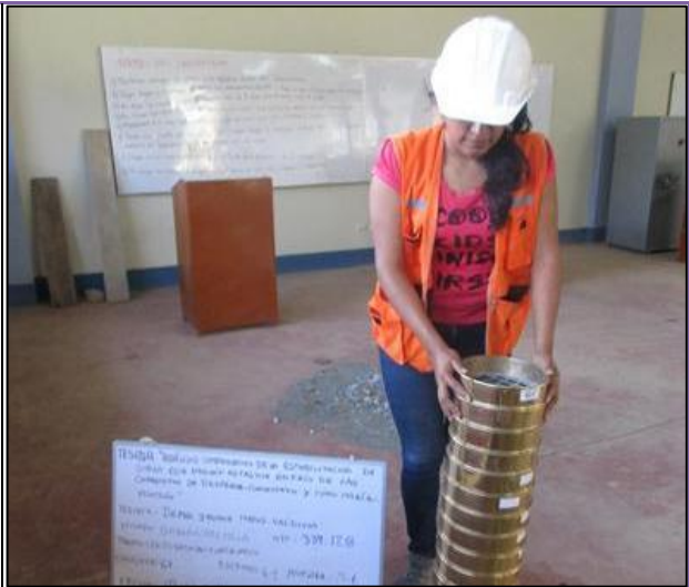
FOTOGRAFÍA N° 38: Se realizó el tamizado de las C-1, C-2 y C-3 de la carretera Bella – Inti.
