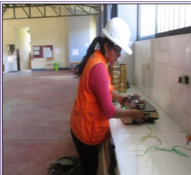
FOTOGRAFÍA N° 62: Se pesa la muestra M-1 en su estado natural de 400 gr a más para obtener su peso natural húmedo.
