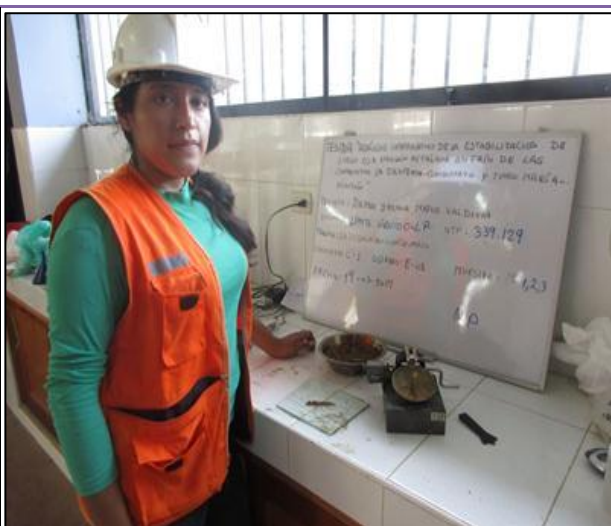
FOTOGRAFÍA N° 46: Posteriormente se pesó la muestra para saturarla con agua destilada y realizar las pruebas.
