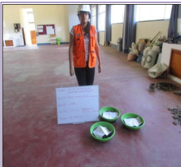
FOTOGRAFÍA N° 102: Preparación de muestra para en ensayo de CBR de la combinación de los agregados.
