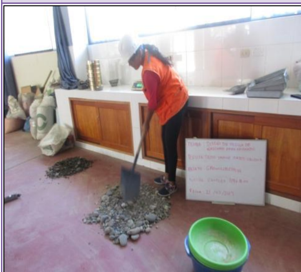
FOTOGRAFÍA N° 68: Cuarteo de muestras del material de cantera.
