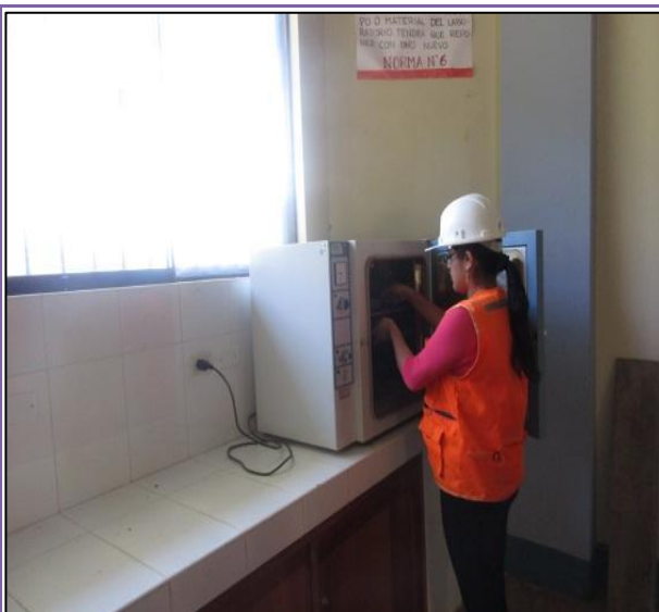
FOTOGRAFÍA N° 79. Se colocó las muestras al horno para secado por 24 horas.
