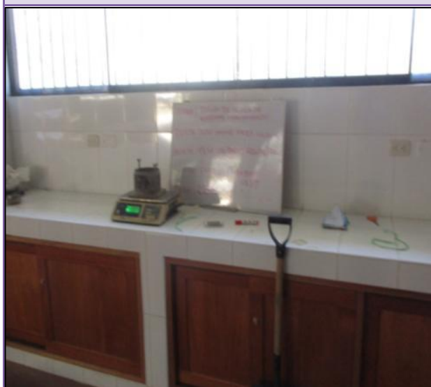
FOTOGRAFÍA N° 76: Realizando el ensayo de peso unitario volumétrico de la muestra.
