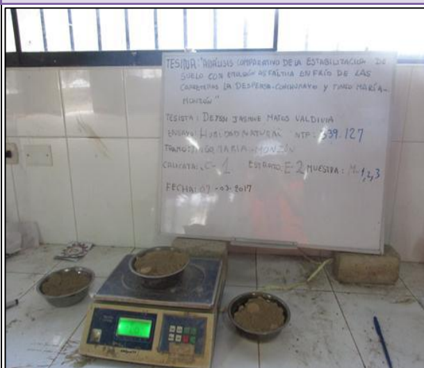
FOTOGRAFÍA N° 28: Se pesa la muestra en su estado natural de 400 gr a más para obtener su peso natural húmedo.
