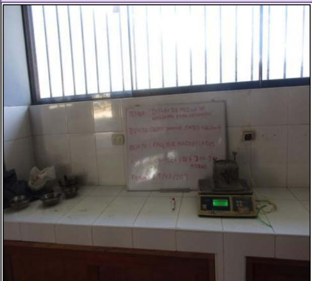
FOTOGRAFÍA N° 97: Pesando el material del Proctor de los materiales de Cantera.
