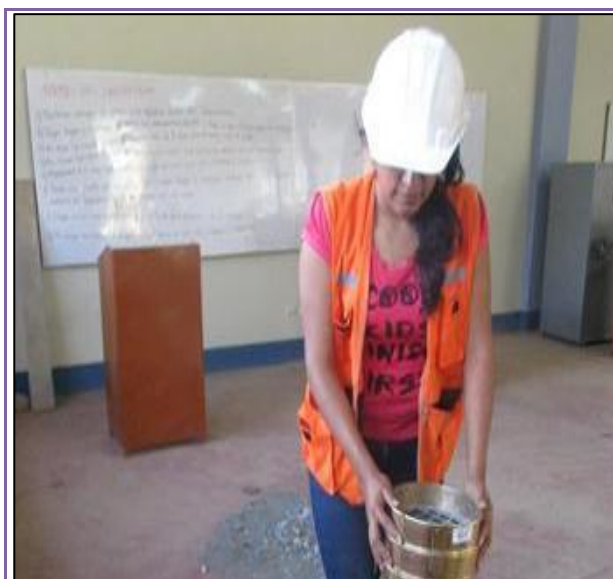
FOTOGRAFÍA N° 43: Se realiza el tamizado por la malla N° 40 (para los límites de Atterberg) de cada uno de los estratos para las C-1, C-2, C-3 de cada una de las carreteras.
