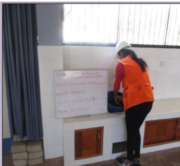
FOTOGRAFÍA N° 90: Lavado de material para realizar el ensayo de Abrasión Los Ángeles.
