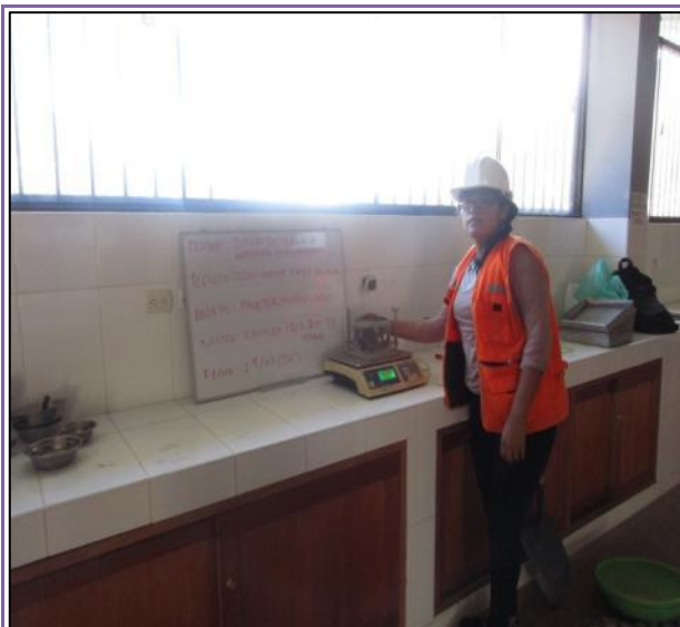
FOTOGRAFÍA N° 98: Pesando el material del Proctor de los materiales de Cantera.
