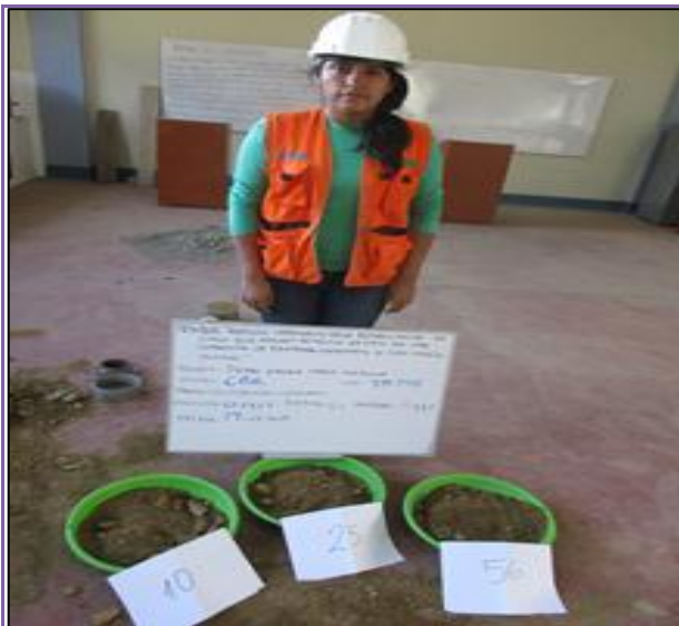
FOTOGRAFÍA N° 51: Preparación de muestra para en ensayo de CBR
