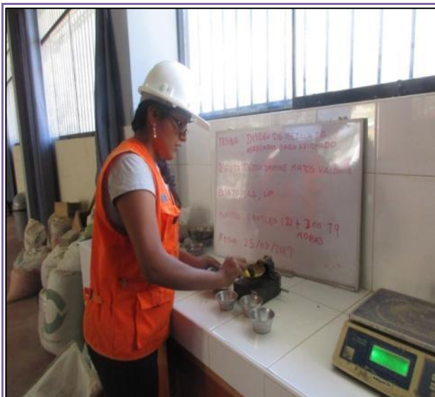
FOTOGRAFÍA N° 86: La obtención de la muestra húmeda se pesa para colocarlo al horno y obtener su peso seco.
