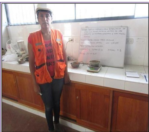
FOTOGRAFÍA N° 24: Se pesa la muestra M-2 en su estado natural de 400 gr a más para obtener su peso natural húmedo.
