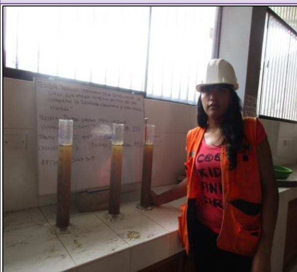
FOTOGRAFÍA N° 93: Realizando el ensayo de Equivalente de Arena de los materiales de cantera.
