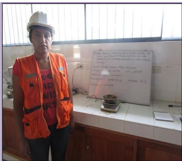
FOTOGRAFÍA N° 23: Se pesa la muestra M-1 en su estado natural de 400 gr a más para obtener su peso natural húmedo.
