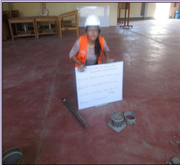
FOTOGRAFÍA N° 94: Realizando el ensayo de Proctor Modificado de los materiales de Cantera.
