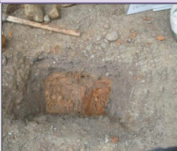
FOTOGRAFÍA N° 11 y 12: En las fotografías se puede observar la calicata N° 03 con dimensiones de 1.00 m x 1.00 m y 1.50 m de profundidad, cuyas coordenadas geodésicas son Latitud 9° 19' 14.93" S y Longitud 76° 2' 16.41" W.
