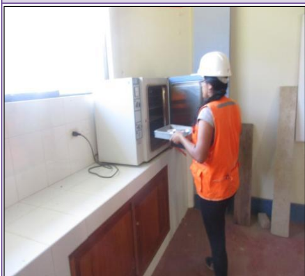
FOTOGRAFÍA N° 88: La obtención de la muestra húmeda se pesa para colocarlo al horno y obtener su peso seco.
