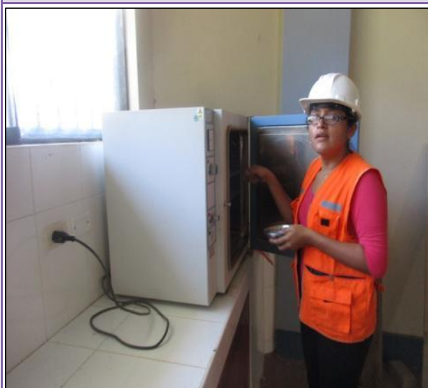
FOTOGRAFÍA N° 64: Se colocó las muestras a secado por 24 horas a temperatura de 110 °C.
