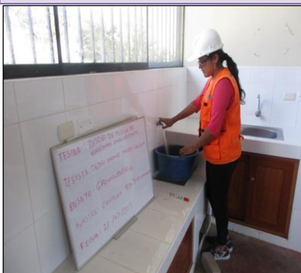
FOTOGRAFÍA N° 77: Se realiza el lavado de la muestra del material de cantera para realizar el ensayo granulométrico.
