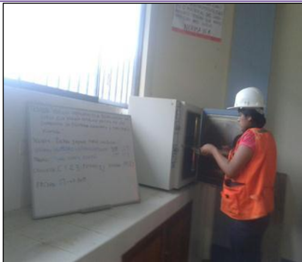
FOTOGRAFÍA N° 37: Se colocó las muestras al horno para secado por 24 horas.
