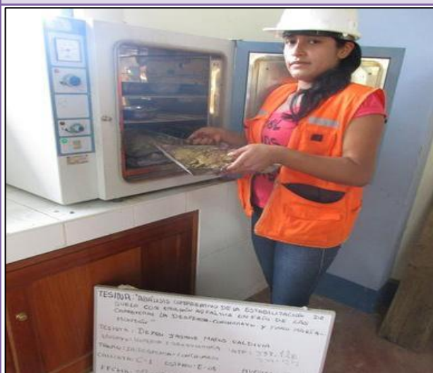
FOTOGRAFÍA N° 31: Se colocó las muestras a secado por 24 horas a temperatura de 110 °C.
