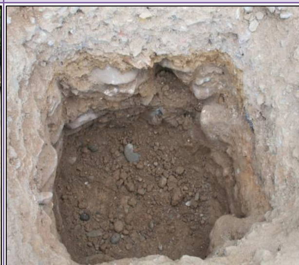
FOTOGRAFÍA N° 7 y 8: En las fotografías se puede observar la calicata N° 02 con dimensiones de 1.00 m x 1.00 m y 1.50 m de profundidad, cuyas coordenadas geodésicas son Latitud 9° 19' 20.30" S y Longitud 76° 2' 11.33" W.
