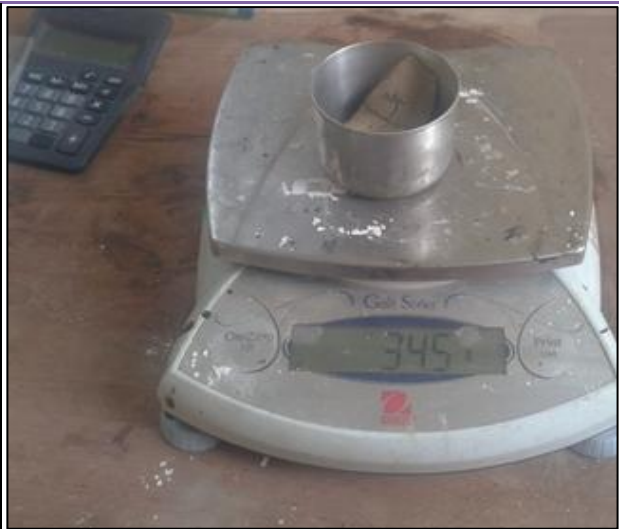
FOTOGRAFÍA N° 50: Se obtuvo las muestras secas y posteriormente se pesó las muestras M-1, M-2, M-3 de los E-1, E-2, E-3, E-4 de las C-1, C-2, C-3 de la Bella – Inti.
