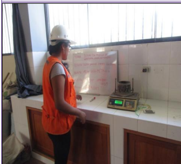
FOTOGRAFÍA N° 72: Realizando el ensayo de peso unitario volumétrico de la muestra.
