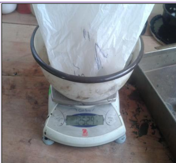
FOTOGRAFÍA N° 91: Peso del material para realizar el ensayo de Abrasión Los Ángeles.
