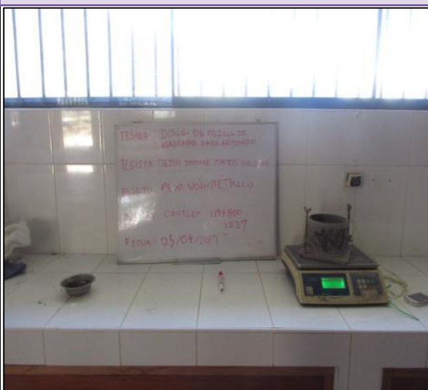
FOTOGRAFÍA N° 73: Realizando el ensayo de peso unitario volumétrico de la muestra.
