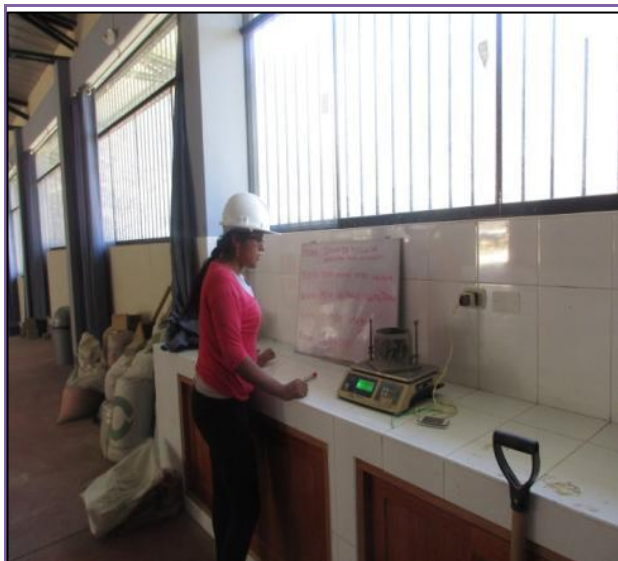
FOTOGRAFÍA N° 74: Realizando el ensayo de peso unitario volumétrico de la muestra.
