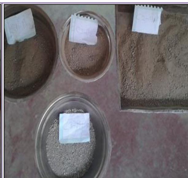
FOTOGRAFÍA N° 44: Se obtuvo muestra pasante de la malla N°40 para la preparación de muestras para el límite líquido y plástico.
