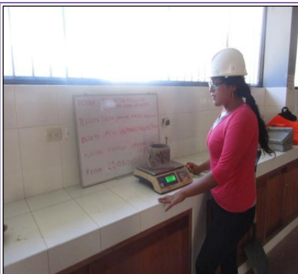
FOTOGRAFÍA N° 75: Realizando el ensayo de peso unitario volumétrico de la muestra.
