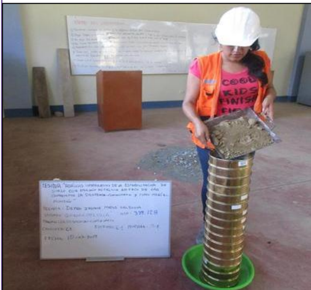
FOTOGRAFÍA N° 39: Se realizó el tamizado de las C-1, C-2 y C-3 de la carretera Bella – Inti.
