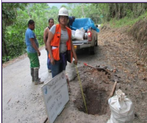
FOTOGRAFÍA N° 11 y 12: En las fotografías se puede observar la calicata N° 03 con dimensiones de 1.00 m x 1.00 m y 1.50 m de profundidad, cuyas coordenadas geodésicas son Latitud 9° 19' 14.93" S y Longitud 76° 2' 16.41" W.
