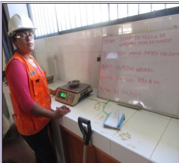
FOTOGRAFÍA N° 66: Se obtuvo las muestras secas y posteriormente se pesó las muestras M-1, M-2, M-3 de las canteras.
