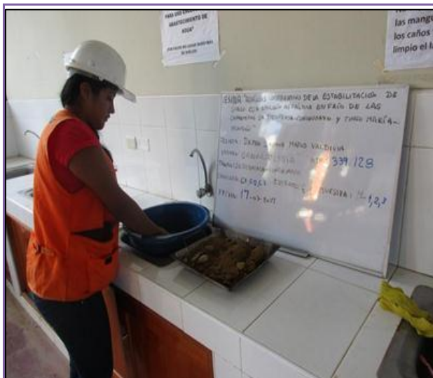
FOTOGRAFÍA N° 33: Se realiza el lavado de la muestra por cada Estrato de cada Calicata.
