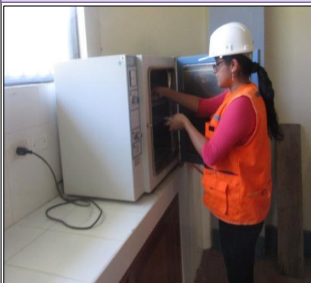
FOTOGRAFÍA N° 65: Se colocó las muestras a secado por 24 horas a temperatura de 110 °C.
