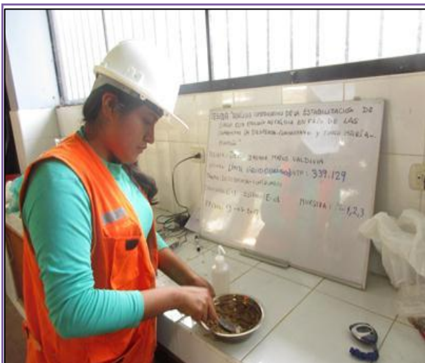
FOTOGRAFÍA N° 45: Posteriormente se pesó la muestra para saturarla con agua destilada y realizar las pruebas.
