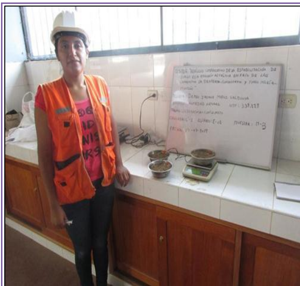
FOTOGRAFÍA N° 25: Se pesa la muestra M-3 en su estado natural de 400 gr a más para obtener su peso natural húmedo.
