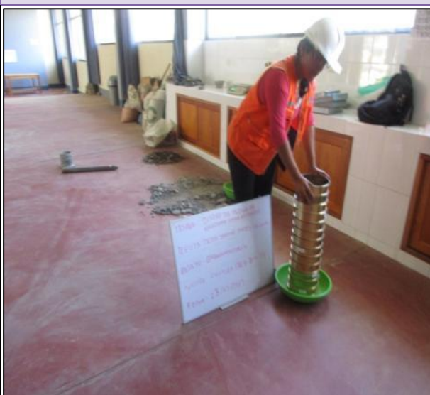
FOTOGRAFÍA N° 81: Se realizó el tamizado del material de cantera.
