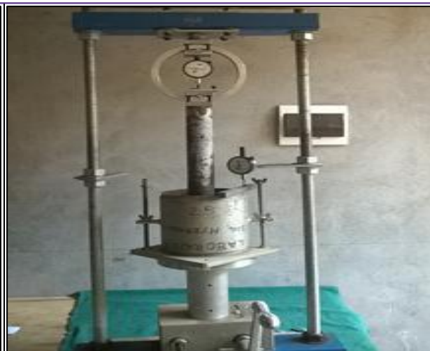
FOTOGRAFÍA N° 54: Se observa el Marco De Carga, El Anillo Y El Dial De Deformaciones.
