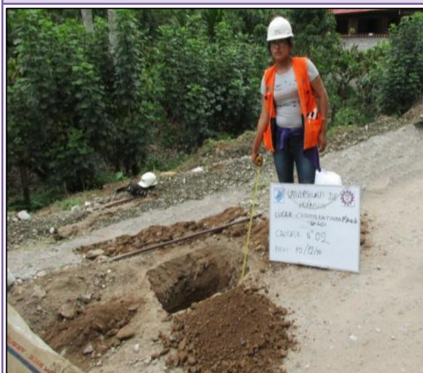
FOTOGRAFÍA N° 7 y 8: En las fotografías se puede observar la calicata N° 02 con dimensiones de 1.00 m x 1.00 m y 1.50 m de profundidad, cuyas coordenadas geodésicas son Latitud 9° 19' 20.30" S y Longitud 76° 2' 11.33" W.
