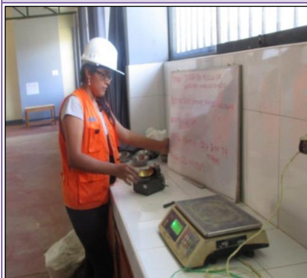
FOTOGRAFÍA N° 84: Posteriormente se pesó la muestra para saturarla con agua destilada y realizar las pruebas.
