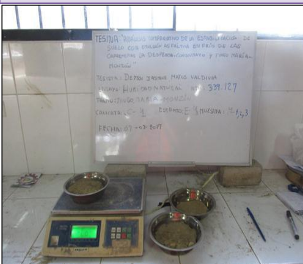
FOTOGRAFÍA N° 32: Se obtuvo las muestras secas y posteriormente se pesó las muestras M-1, M-2, M-3 de los E-1, E-2, E-3, E-4 de las C-1, C-2, C-3 de la Bella – Inti.
