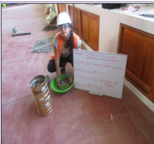
FOTOGRAFÍA N° 83: Se realiza el tamizado por la malla N° 40 de cada uno de los materiales de cantera para realizar el ensayo de Límites Líquido y Plástico.
