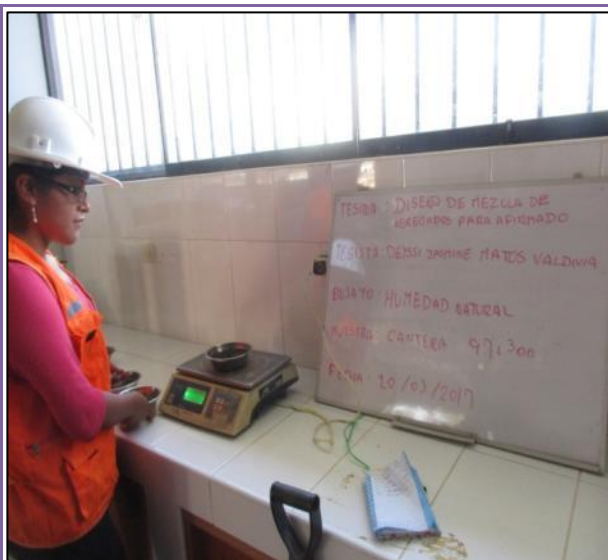
FOTOGRAFÍA N° 63: Se pesa la muestra M-1 en su estado natural de 400 gr a más para obtener su peso natural húmedo.
