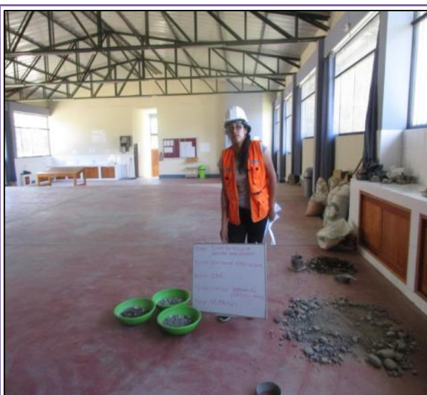
FOTOGRAFÍA N° 103: Preparación de muestra para en ensayo de CBR de la combinación de los agregados.
