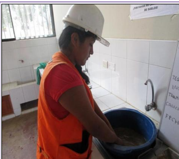
FOTOGRAFÍA N° 34: Se realiza el lavado de la muestra por cada Estrato de cada Calicata.
