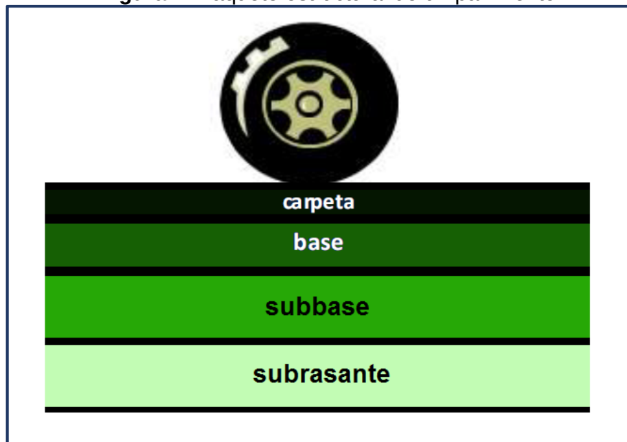
Figura 2. Paquete estructural de un pavimento
