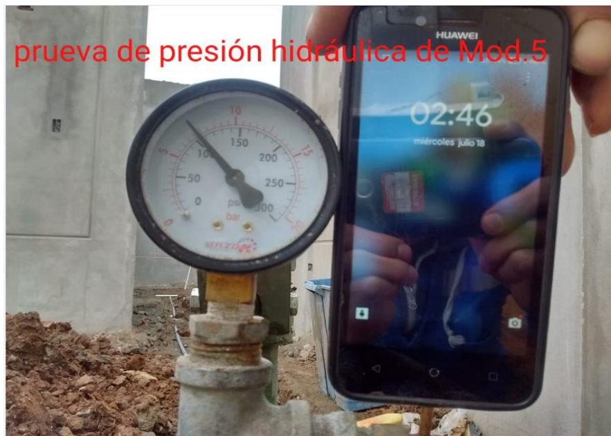
FOTO 10: Se realizó la prueba de la presión Hidráulica de Mod.5.
