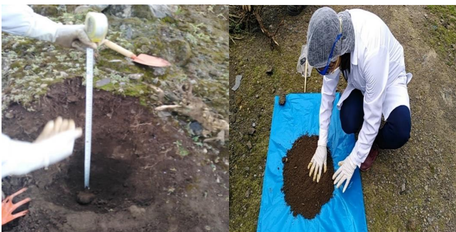
Figura 21. Luego se midió la profundidad del suelo y posteriormente se realizó el cuarteo del suelo. Fuente: Elaboración propia
