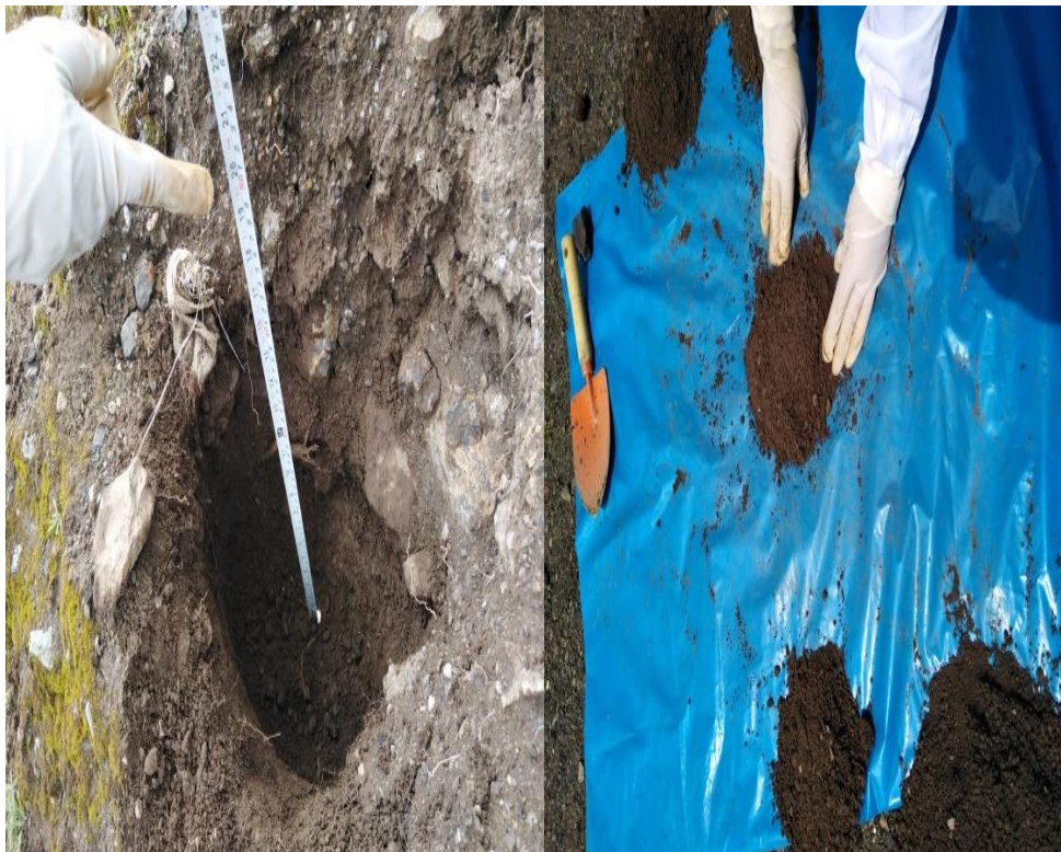
Figura 14. Luego se midió la profundidad del suelo; y posteriormente se realizó el cuarteo.
