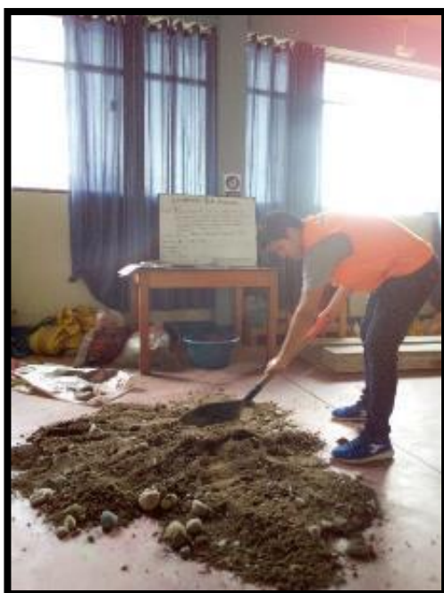
FOTO 2: SEPARACIONES DE LAS MUESTRAS PARA SU SECADO POR CUARTEO
