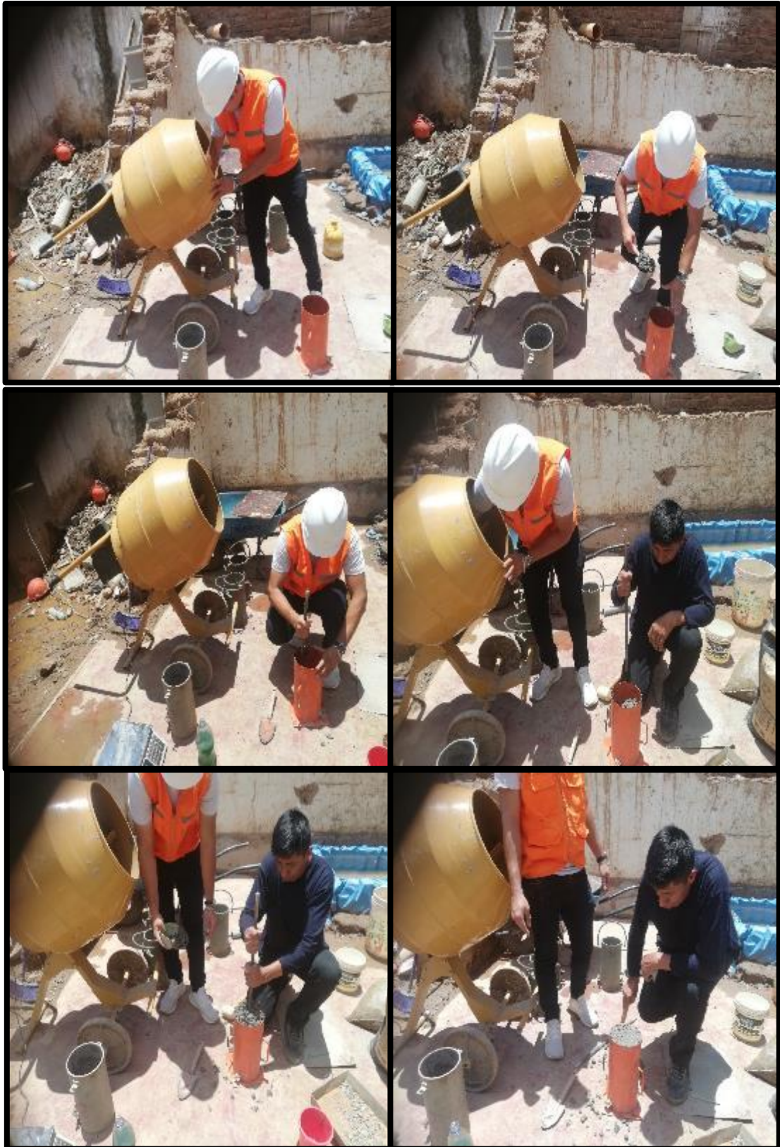
FOTO 48: SEPTIMO HACEMOS LO MISMO HASTA MOLDEAR 10 PROBETAS CON 0.5 %, 1.5 % Y 2.5 % PARA 7, 14 Y 28 DIAS
