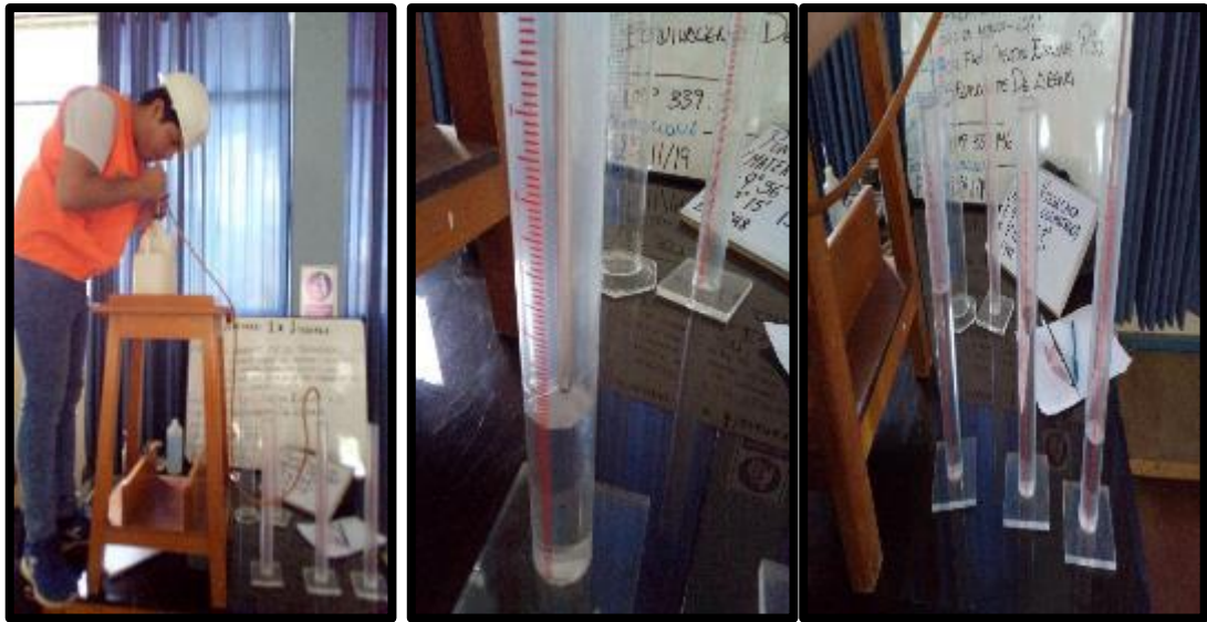
FOTO 38: TERCERO MEDIMOS EN LA FIOLA Y LLENAMOS EN EL ENVASE, LUEGO ARMAMOS LAS ESTRUCTURA PARA EL ENSAYO
