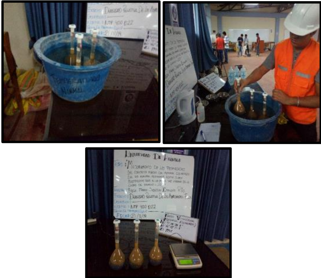
FOTO 19: SEXTO LLENAMOS LAS TINAS CON AGUA A UNA TEMPERATURA NORMAL DURANTE 20 MINUTOS, CADA 5 MINUTOS LO MEZCLAMOS Y AL ULTIMO LO MEZCLAMOS
