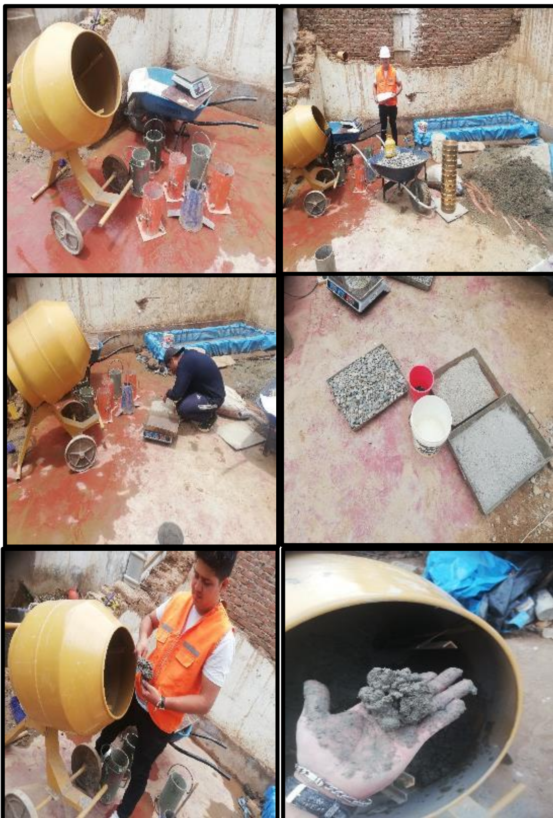
FOTO 46: QUINTO YA OBTENIDO EL DISEÑO OPTIMO PARA EL CONCRETO POROSO EMPEZAMOS CON LA MEZCLA PARA EL MOLDEO DE LAS PROBETAS CON PROPORCIONES DE 0.5 %, 1.5 % Y 2.5 % DE ADITIVO SUPER PLASTIFICANTE PARA LOS 7, 14 Y 28 DIAS
