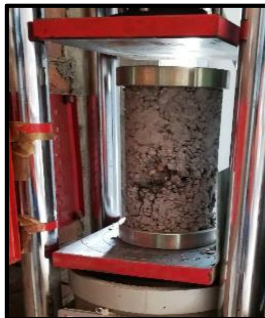
FOTO 56: CONCRETO POROSO CON ADITIVO SUPER PLASTIFICANTE CON PROPORCION DE 1.5 %
