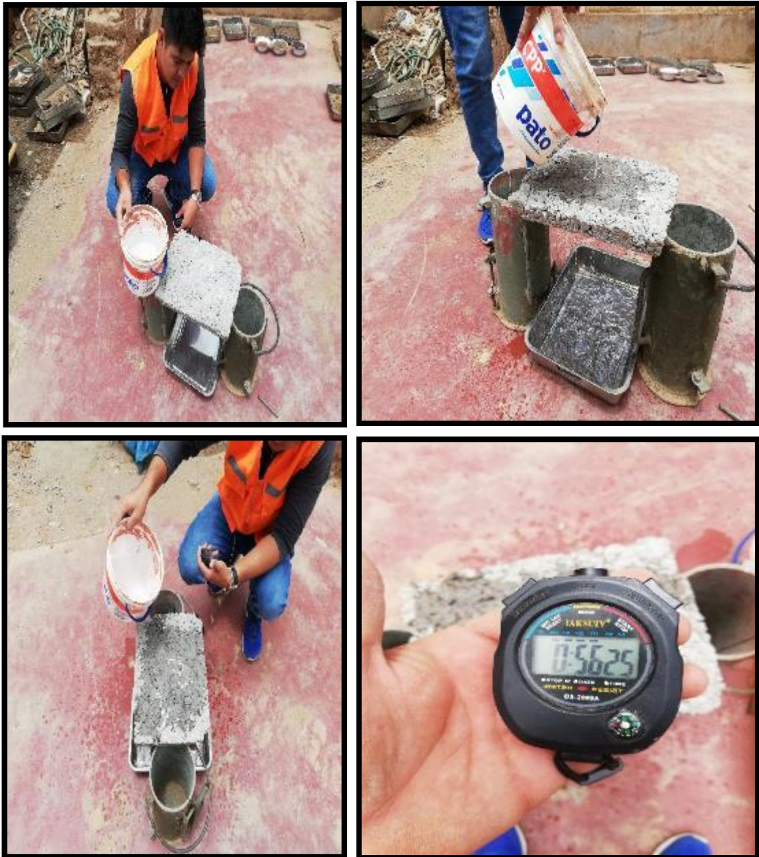
FOTO 63: TAMBIEN HICIMOS UNA PLANCHA DE CONCRETO POROSO DE 7 CM PARA VER LA PERMEABILIDAD
