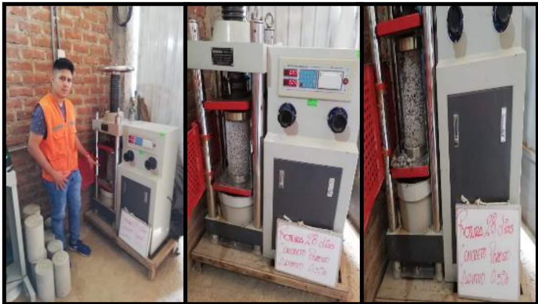
FOTO 58: ROTURA DE LA PROBETA DE CONCRETO POROSO A LOS 28 DIAS CON ADITIVO SUPER PLASTIFICANTE CON PROPORCION DE 0.5 %, 1.5 % Y 2.5 %
