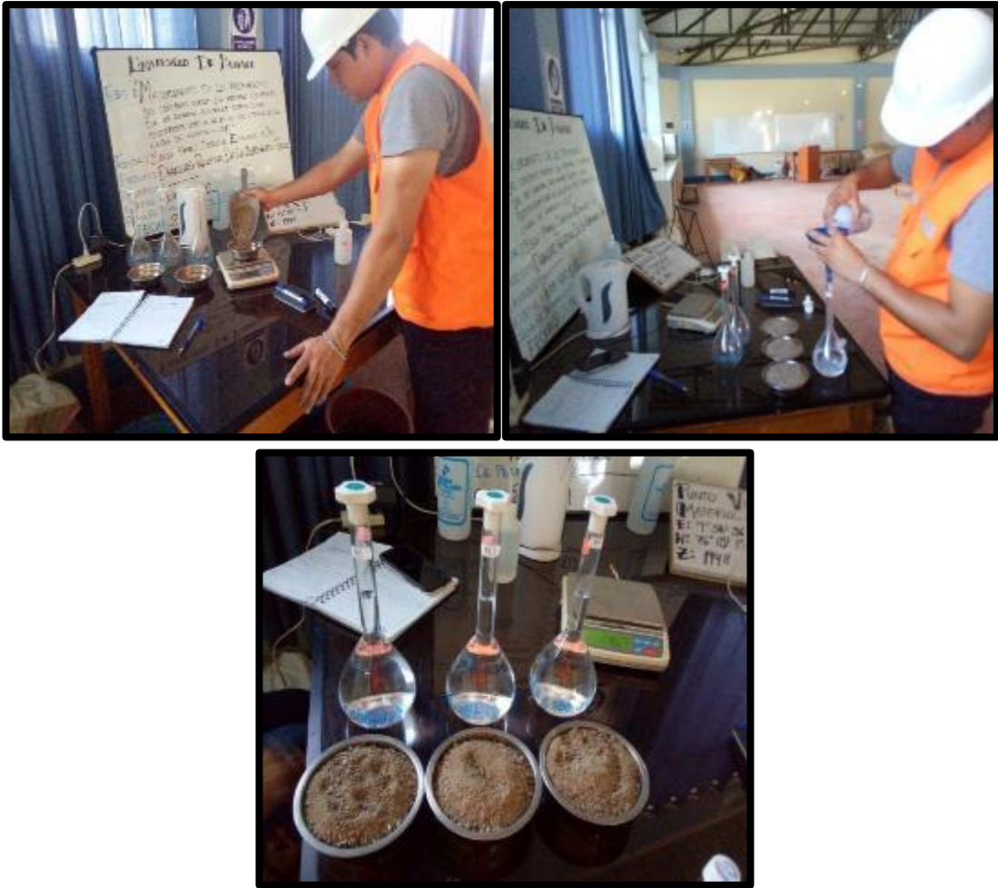
FOTO 16: TERCERO PESAMOS LAS TARAS CON EL AGREGADO FINO, LAS FIOLAS CON EL DESTILADO DE AGUA Y LOS PESAMOS
