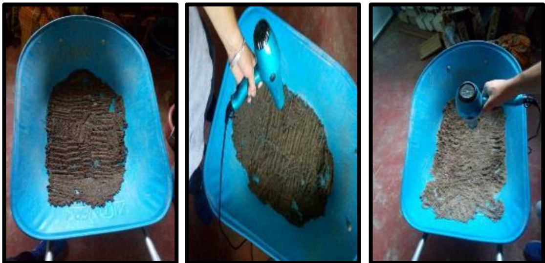
FOTO 14: PRIMERO BOTAMOS EL AGUA DEL AGREGADO FINO, LO TENDEMOS EN LA CARRETILLA Y LO SECAMOS DURANTE 2 HORAS
