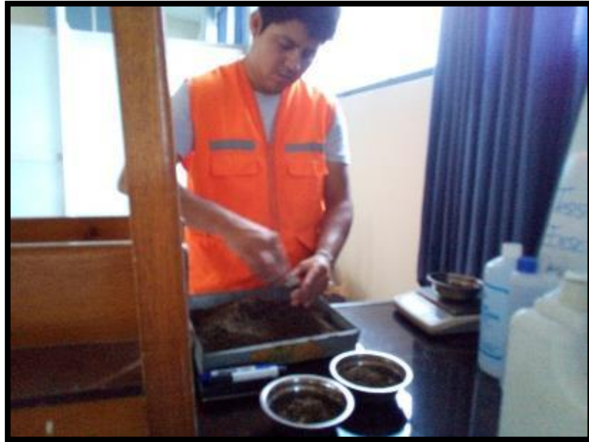
FOTO 37: SEGUNDO PESAMOS LAS TARAS + AGREGADOS
