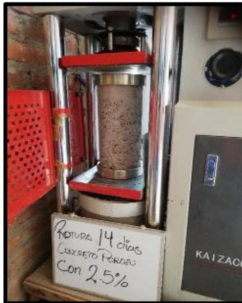
FOTO 57: CONCRETO POROSO CON ADITIVO SUPER PLASTIFICANTE CON PROPORCION DE 2.5 %
