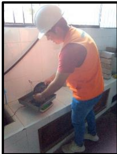
FOTO 22: TERCERO PESAMOS EL AGREGADO GRUESO DENTRO DEL AGUA, LO SACAMOS Y LO DEJAMOS ESCURRIR EL AGUA, LUEGO LOS PESAMOS
