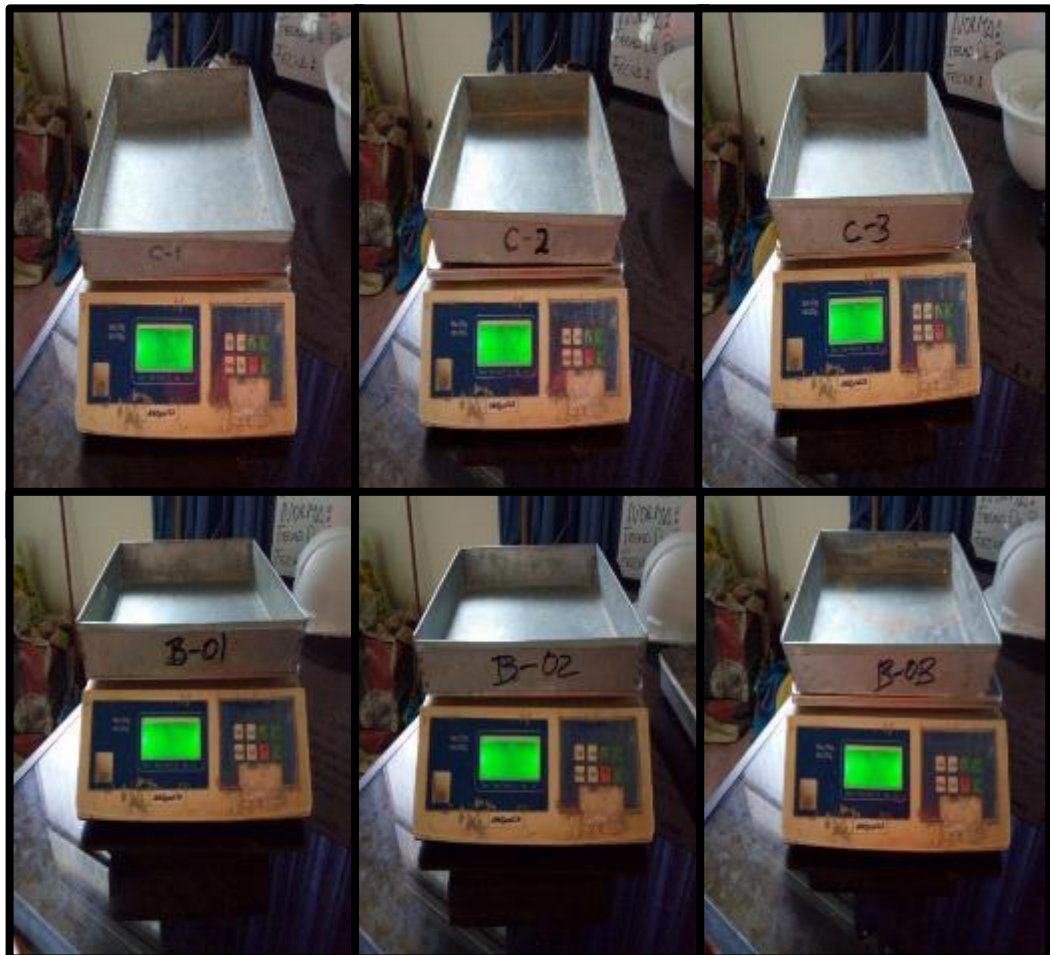
FOTO 25: SEGUNDO PESAMO LAS CAZOLETAS PARA LOS AGREGADOS FINO© Y GRUESOS (B)
