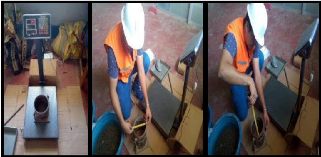
FOTO 10: PRIMERO PESAMOS, MEDIMOS EL DIAMETRO Y LA ALTURA DEL RECIPIENTE
