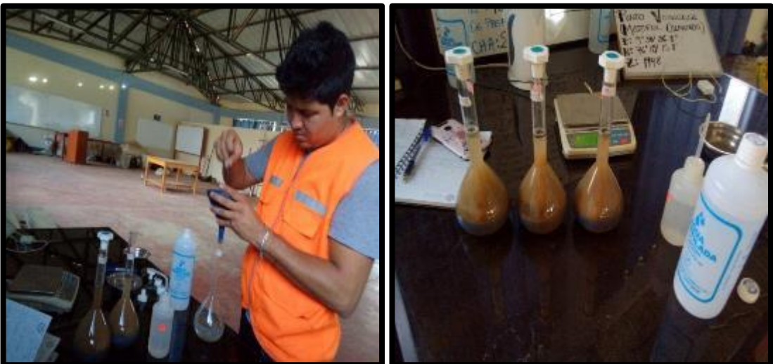
FOTO 16: TERCERO PESAMOS LAS TARAS CON EL AGREGADO FINO, LAS FIOLAS CON EL DESTILADO DE AGUA Y LOS PESAMOS
