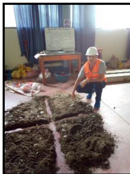
FOTO 2: SEPARACIONES DE LAS MUESTRAS PARA SU SECADO POR CUARTEO
