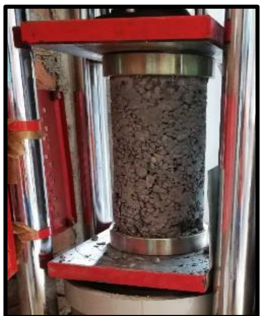
FOTO 54: CONCRETO POROSO CON ADITIVO SUPER PLASTIFICANTE CON PROPORCION DE 2.5 %
