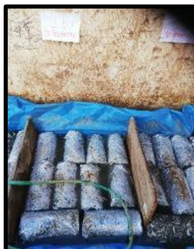
FOTO 49: NOVENO UNA VEZ MOLDEADO PONEMOS CON PLASTICO DEJAMOS QUE CURE UNOS DIAS Y LUEGO LO PONEMOS AL AGUA
