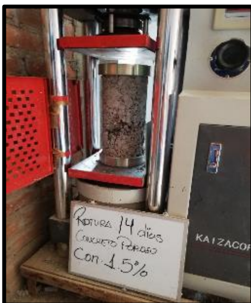
FOTO 56: CONCRETO POROSO CON ADITIVO SUPER PLASTIFICANTE CON PROPORCION DE 1.5 %
