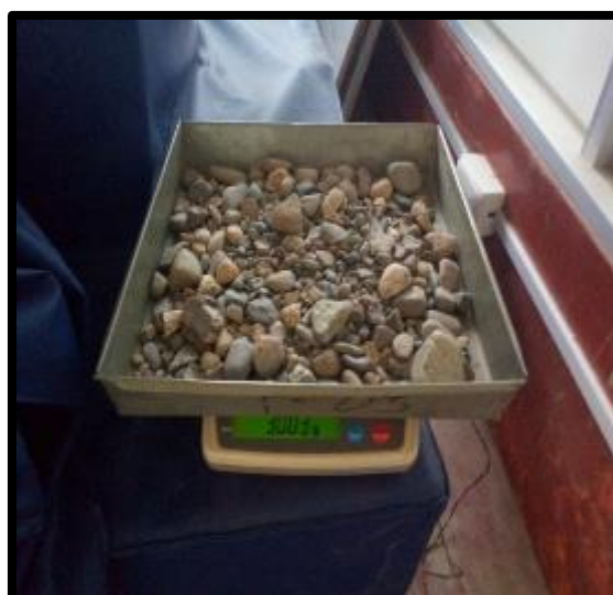
FOTO 23: CUARTO LO SECAMOS E UNA TEMPERATURA NORMAL AL AGREGADO Y LO PESAMOS, LUEGO LO LLEVAMOS AL HORNO Y LO DEJAMOS HASTA EL DIA SIGUIENTE Y LO VOLVEMOS A PESAR
