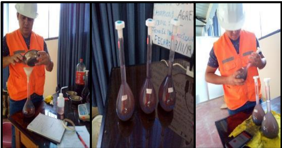
FOTO 33: CUARTO LLENAMOS LAS FIOLAS CON CEMENTO Y LO HACEMOS GIRAR EN 45° DURANTE 10 MINUTOS
