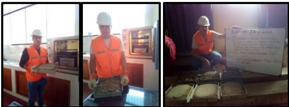
FOTO 27: CUARTO RETIRAMOS LOS AGREGADOS DEL HORNO DESPUES DE LAS 24 HORAS
