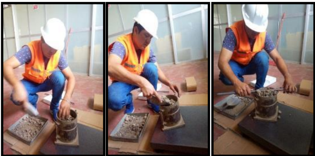
FOTO 10: PRIMERO PESAMOS, MEDIMOS EL DIAMETRO Y LA ALTURA DEL RECIPIENTE
