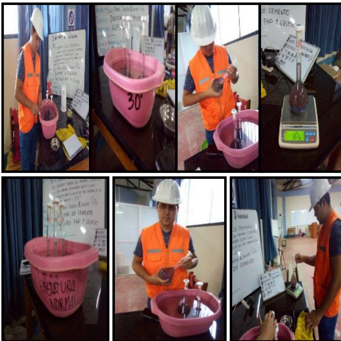
FOTO 34: QUINTO LO PESAMOS EN UNA TINA LLENA CON AGUA A UNA TEMPERATURA DE 30°C DURANTE 2 HORAS Y CADA 5 MINUTOS LO GIRAMOS EN 45° Y IGUALMENTE DESPUES EN UNA TINA CON AGUA A UNA TEMPERATURA NORMAL DURANTE 20 MINUTOS Y CADA 5 MINUTOS LO GIRAMOS Y AL ULTIMO LO PESAMOS
