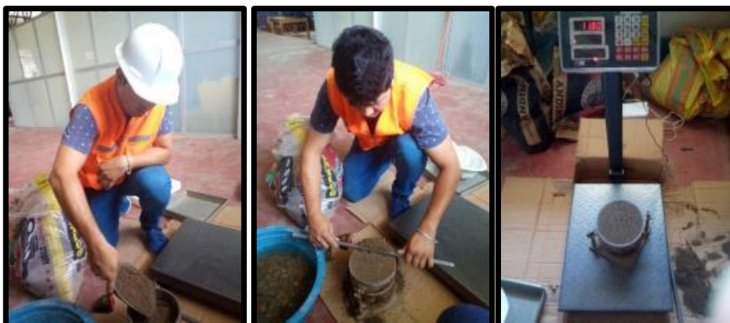
FOTO 8: SEGUNDO PESAMOS LOS AGREGADOS SUELTO + RECIPIENTE
