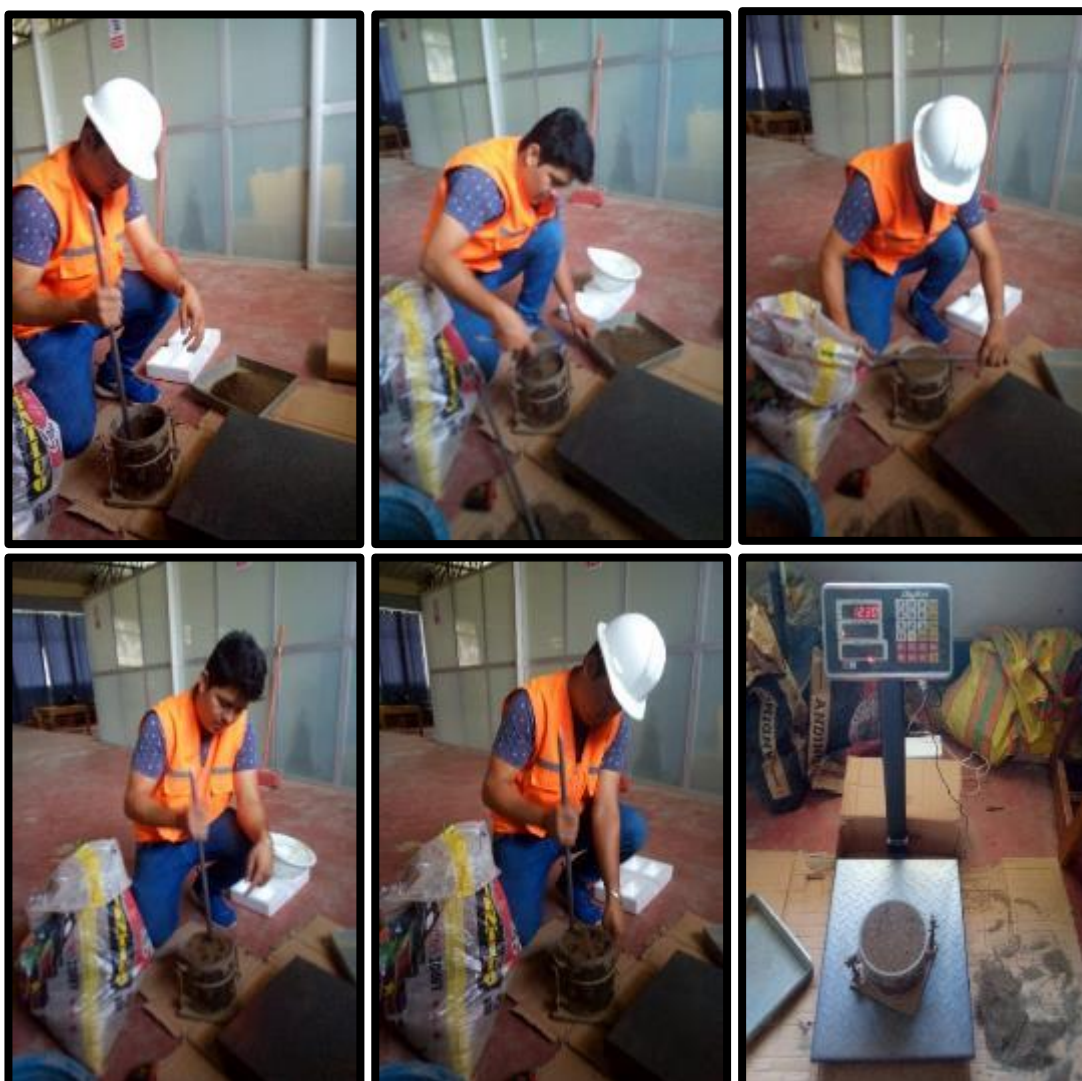
FOTO 9: TERCERO PESAMOS EL AGREGADO VARILLADO + RECIPIENTE
