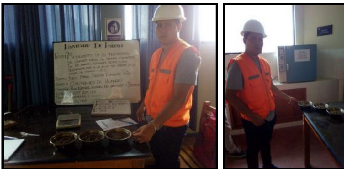
FOTO 5: SACAMOS LAS MUESTRAS DEL HORNO DESPUES DE 24 HORAS Y LO PESAMOS.
