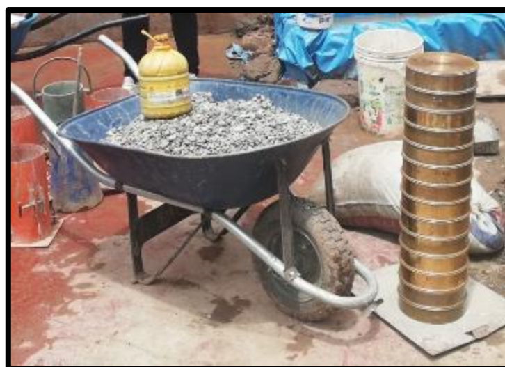
FOTO 43: SEGUNDO SELECCIONAMOS LOS MATERIALE COLMATADO EXTRAIDO CON LOS TAMICES DE \frac{3}{4} "HASTA 4"
