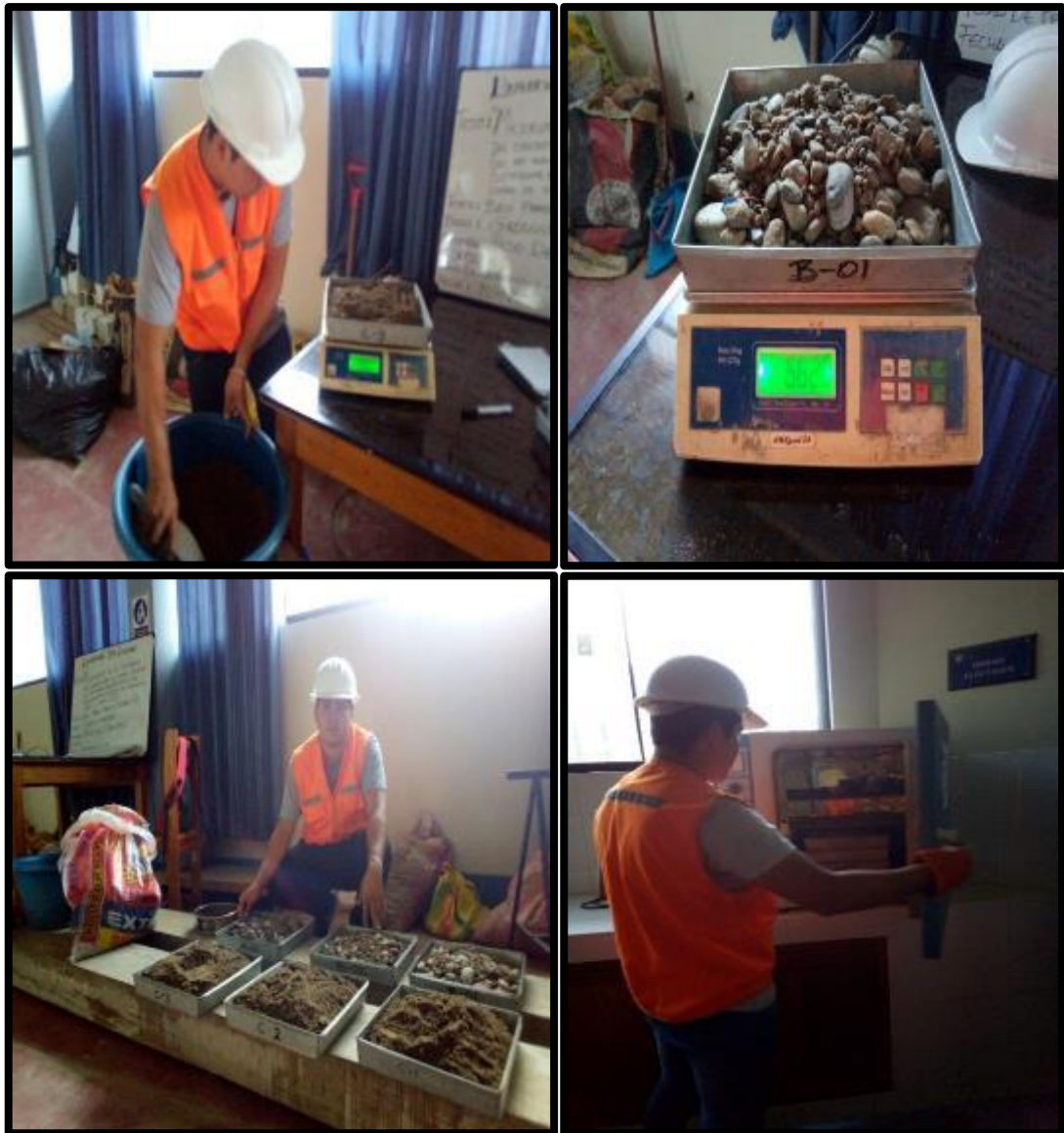
FOTO 26: TERCERO PESAMOS LOS AGREGADOS FINO, GRUESO + CAZOLETAS, LUEGI AL HORNO DURNATE 24 HORAS
