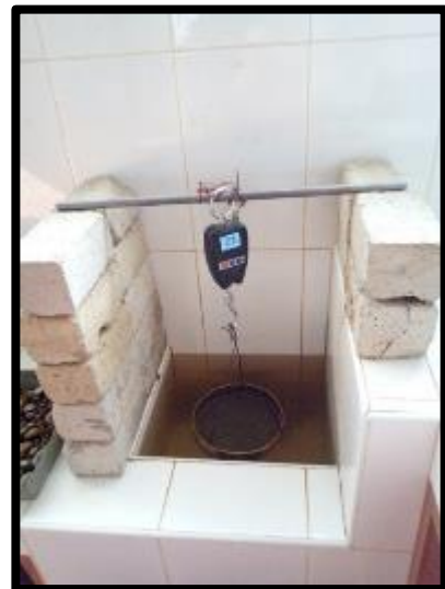
FOTO 21: SEGUNDO ARMAMOS LAS ESTRUCTURAS PARA PESAR LOS AGREGADOS DENTRO DEL AGUA
