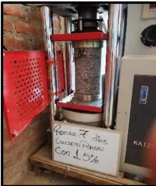
FOTO 53: CONCRETO POROSO CON ADITIVO SUPER PLASTIFICANTE CON PROPORCION DE 1.5 %
