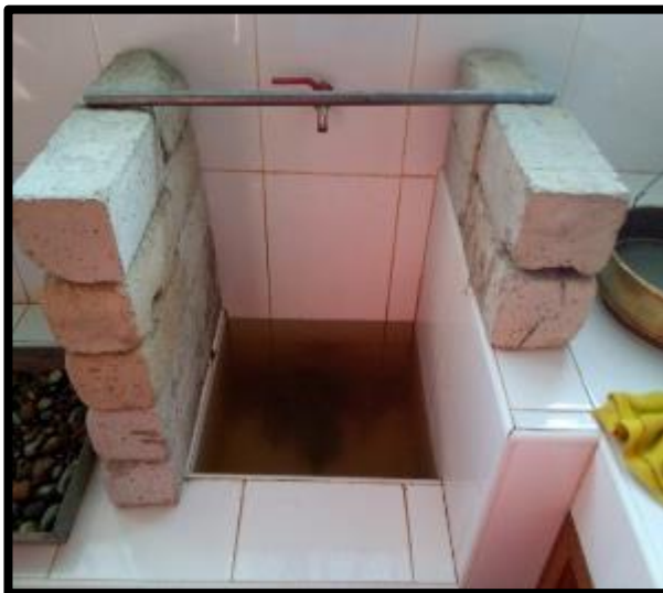
FOTO 21: SEGUNDO ARMAMOS LAS ESTRUCTURAS PARA PESAR LOS AGREGADOS DENTRO DEL AGUA
