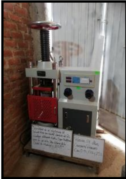
FOTO 58: ROTURA DE LA PROBETA DE CONCRETO POROSO A LOS 28 DIAS CON ADITIVO SUPER PLASTIFICANTE CON PROPORCION DE 0.5 %, 1.5 % Y 2.5 %
