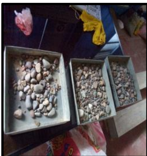
FOTO 23: CUARTO LO SECAMOS E UNA TEMPERATURA NORMAL AL AGREGADO Y LO PESAMOS, LUEGO LO LLEVAMOS AL HORNO Y LO DEJAMOS HASTA EL DIA SIGUIENTE Y LO VOLVEMOS A PESAR
