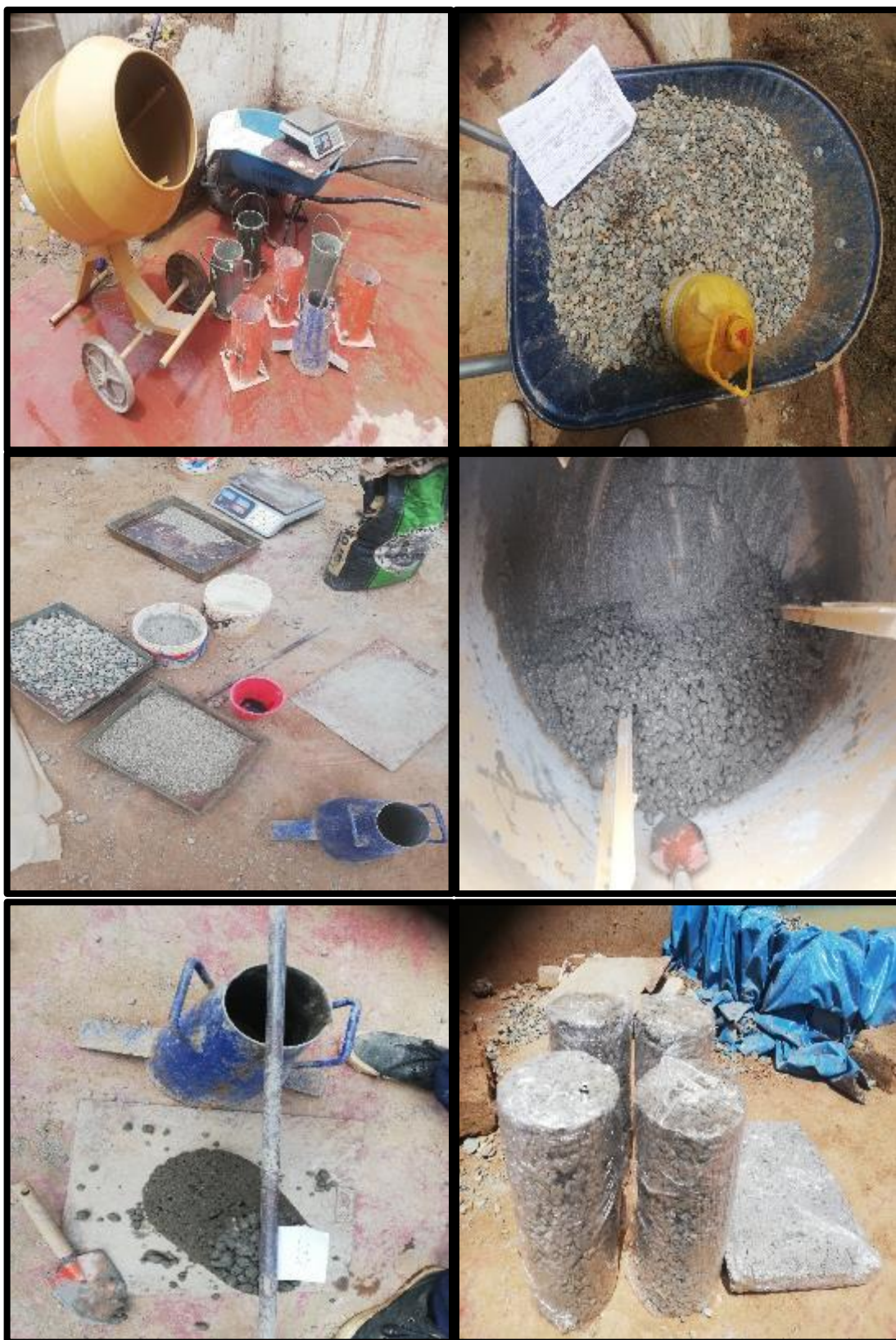
FOTO 45: CUARTO YA OBTENIDO EL DISEÑO DE MEZCLA HACEMOS LA PRUEBA CORRESPONDIENTE PARA EL REAJUSTE DE PROPORCION
