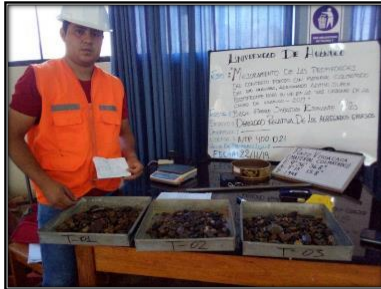
FOTO 20: PRIMERO PESAMOS LAS CAZOLETAS + AGREGADO GRUESO
