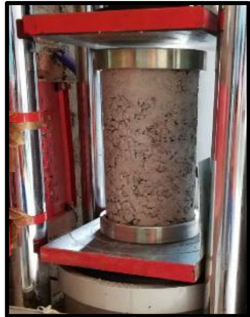
FOTO 57: CONCRETO POROSO CON ADITIVO SUPER PLASTIFICANTE CON PROPORCION DE 2.5 %
