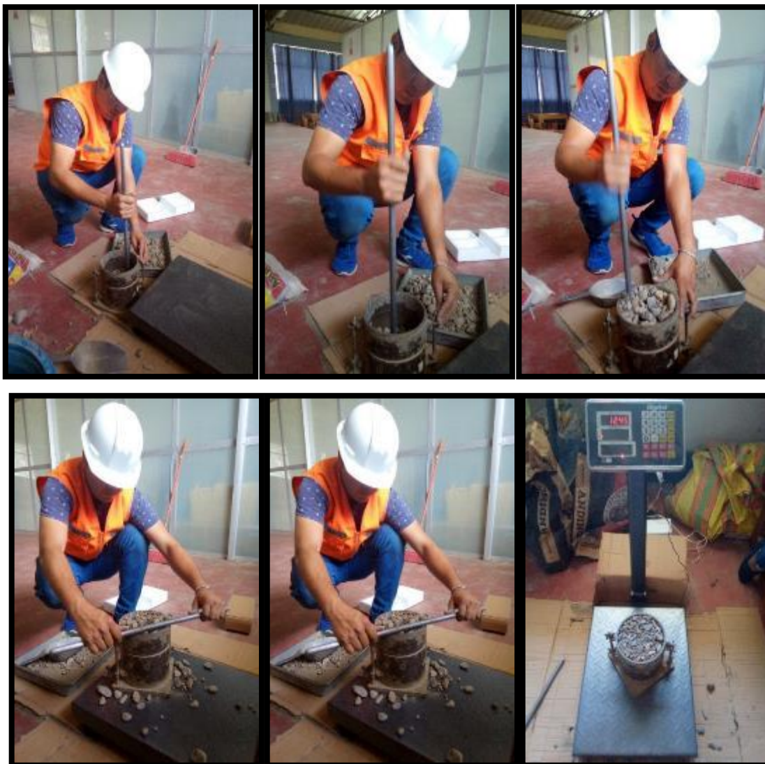
FOTO 12: TERCERO PESAMOS EL AGREGADO VARILLADO + RECIPIENTE
