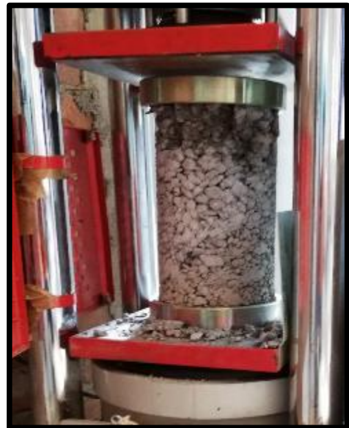
FOTO 55: CONCRETO POROSO CON ADITIVO SUPER PLASTIFICANTE CON PROPORCION DE 0.5 %
