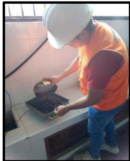
FOTO 22: TERCERO PESAMOS EL AGREGADO GRUESO DENTRO DEL AGUA, LO SACAMOS Y LO DEJAMOS ESCURRIR EL AGUA, LUEGO LOS PESAMOS
