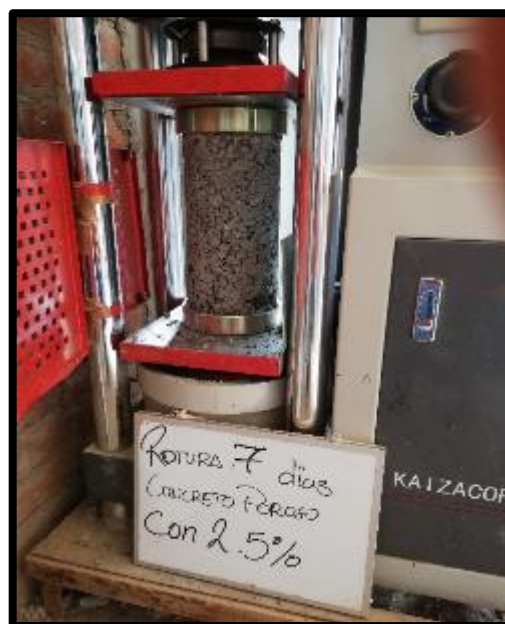
FOTO 54: CONCRETO POROSO CON ADITIVO SUPER PLASTIFICANTE CON PROPORCION DE 2.5 %
