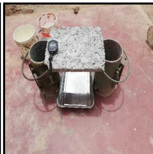
FOTO 62: PERMEABILIDAD DEL CONCRETO POROSO LOS 28 DIAS CON PROPORCION DE 0.5 %, 1.5 % Y 2.5 %
