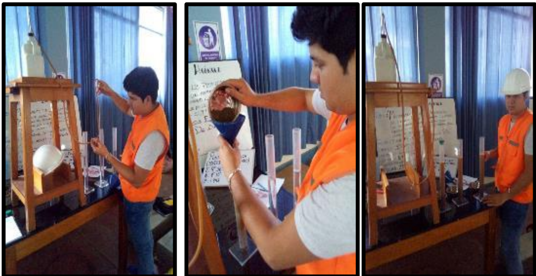
FOTO 39: CUARTO PASO SOPLAMOS Y EMPEZAMOS A LLENAR LAS FIOLAS LUEGO LLENAMOS EL MATERIAL QUE PESAMOS CON LAS TARAS EN LAS FIOLAS
