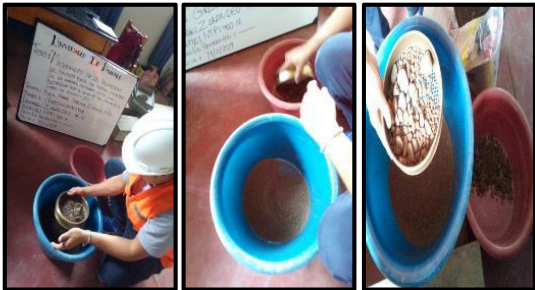
FOTO 24: PRIMERO TAMIZAMOS LOS AGREGADOS FINO Y GRUESO
