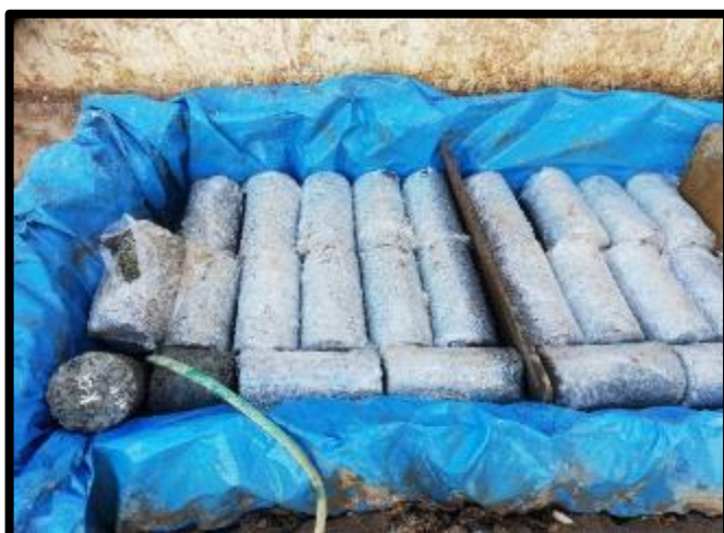
FOTO 49: NOVENO UNA VEZ MOLDEADO PONEMOS CON PLASTICO DEJAMOS QUE CURE UNOS DIAS Y LUEGO LO PONEMOS AL AGUA
