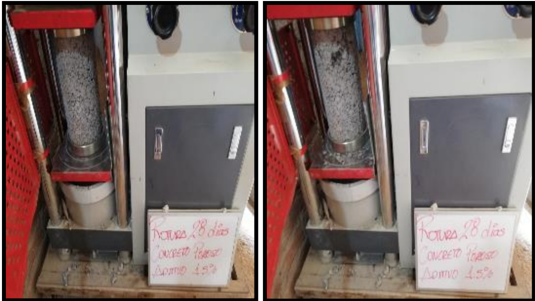
FOTO 60: CONCRETO POROSO LOS 28 DIAS CON ADITIVO SUPER PLASTIFICANTE CON PROPORCION DE 1.5 %
