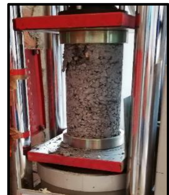
FOTO 53: CONCRETO POROSO CON ADITIVO SUPER PLASTIFICANTE CON PROPORCION DE 1.5 %
