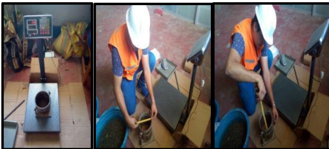
FOTO 7: PRIMERO HACEMOS LAS RESPECTIVAS MEDICIONES, DIAMETRO, ALTURA Y PESAMOS EL RECIPIENTE PARA EL ENSAYO
