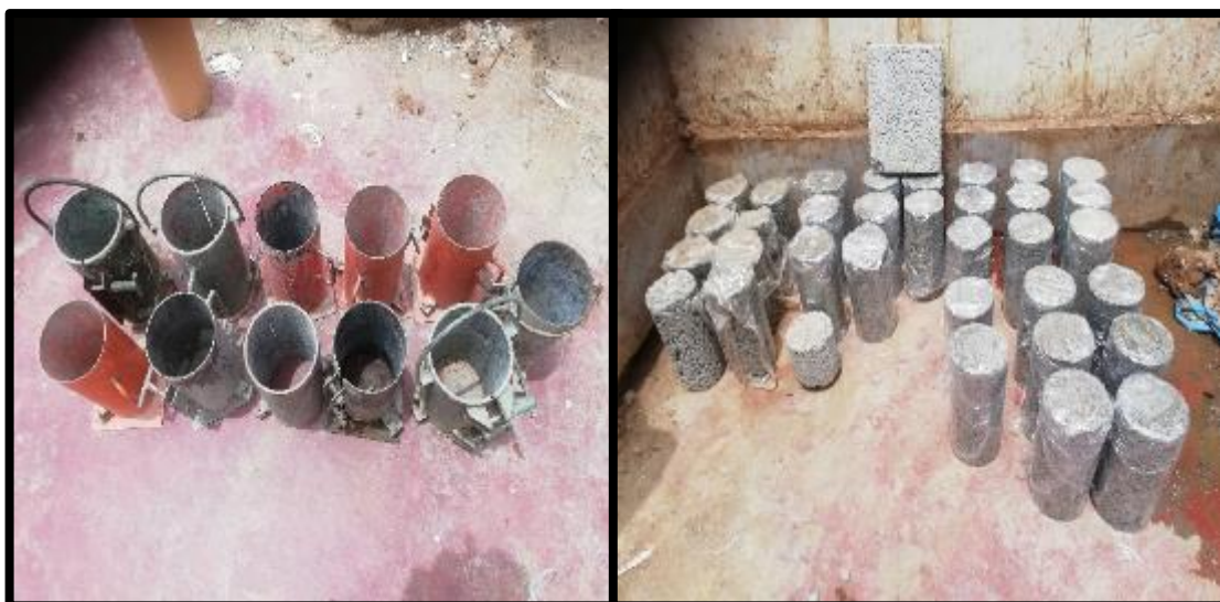
FOTO 49: NOVENO UNA VEZ MOLDEADO PONEMOS CON PLASTICO DEJAMOS QUE CURE UNOS DIAS Y LUEGO LO PONEMOS AL AGUA
