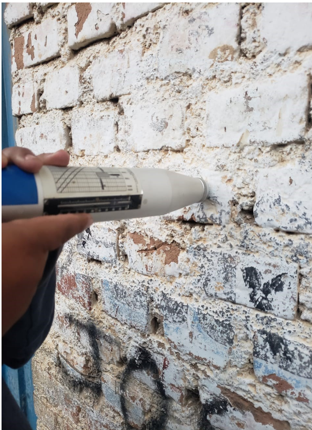
FOTO N°07- EVALUACION DE LA COMPRESION DEL ADOBE CON ESCLEROMETRO MERCADO ANTIGUO.
