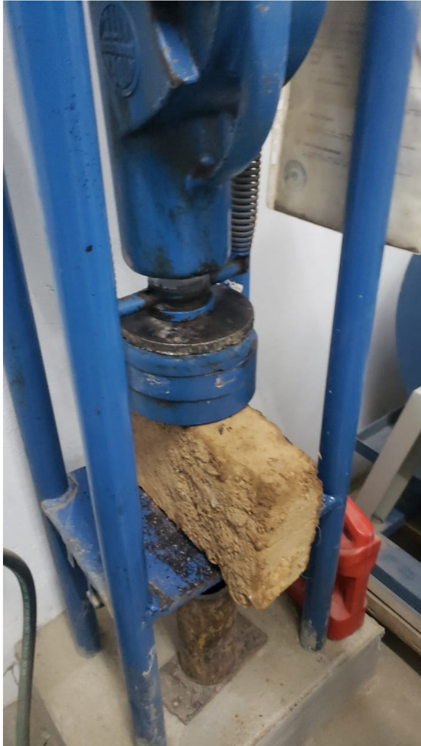
FOTO N°04- ENSAYO DE ROTURA EN PRESA PARA MEDIR LA COMPRESION ANTES DE LA ROTURA EN EL BLOQUE DE ADOBE.
