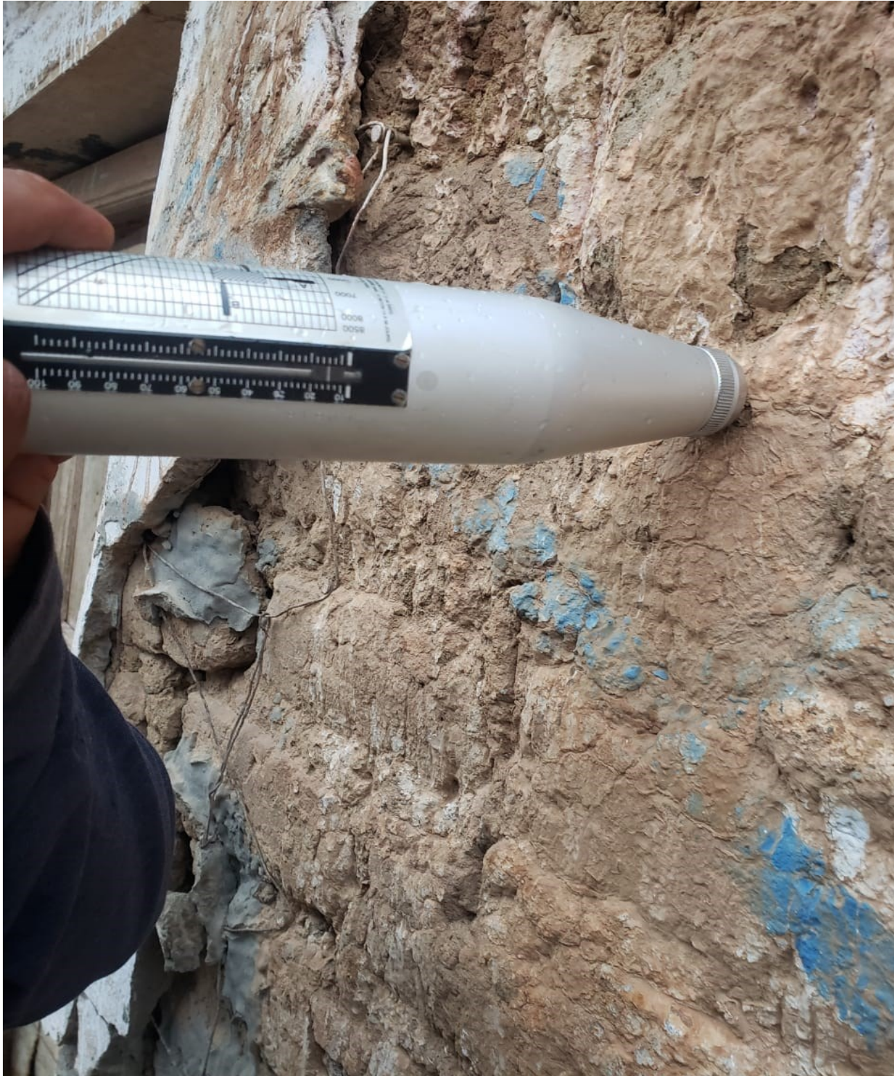
FOTO N°05- EVALUACION DE LA COMPRESION DEL ADOBE CON ESCLEROMETRO MERCADO ANTIGUO.
