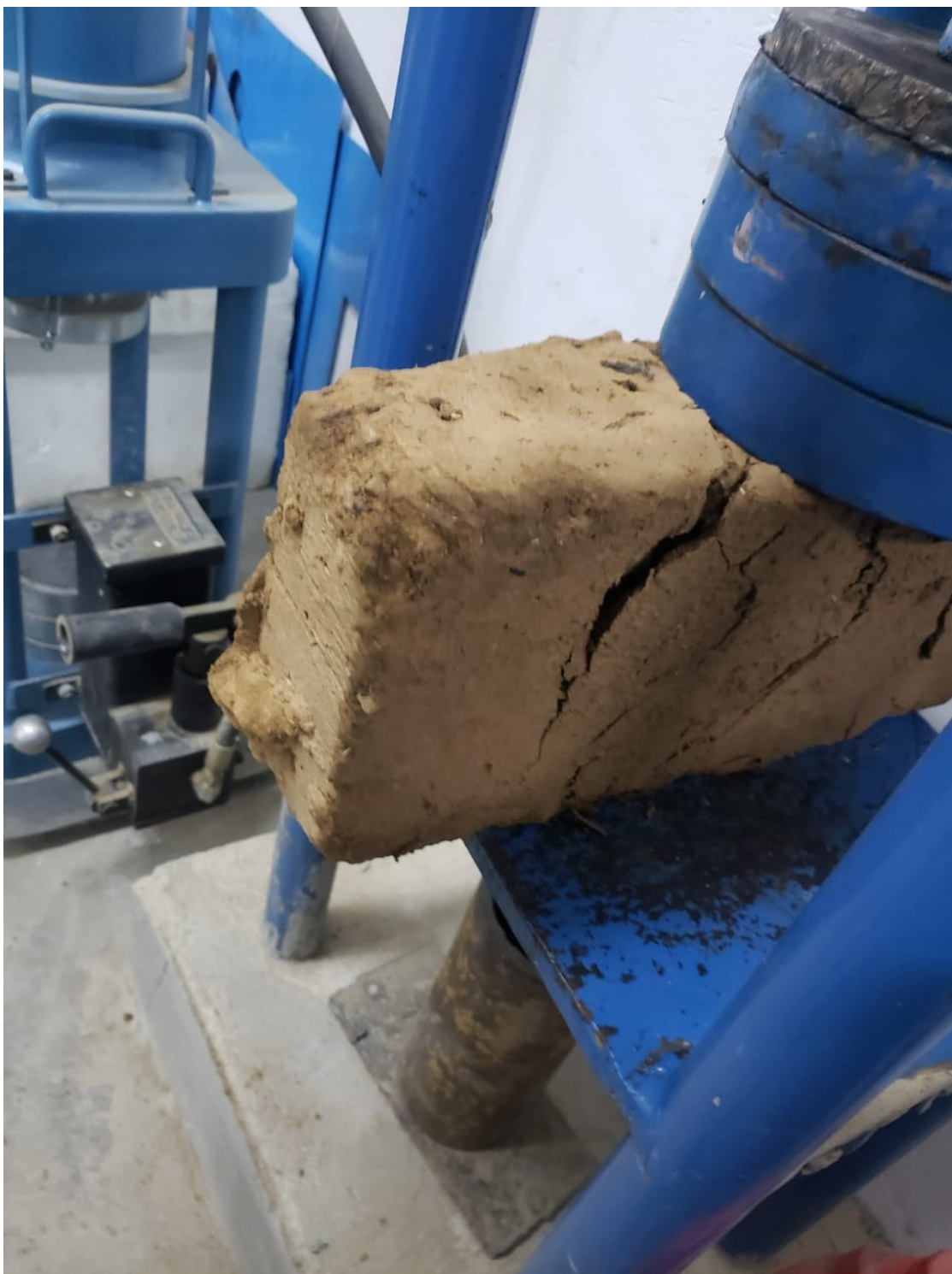
FOTO N°10- FALLA POR COMPRESION DEL ADOBE (MUESTRA N°01) EXTRAIDA DEL MERCADO ANTIGUO DE LA CIUDAD DE HUANUCO.
