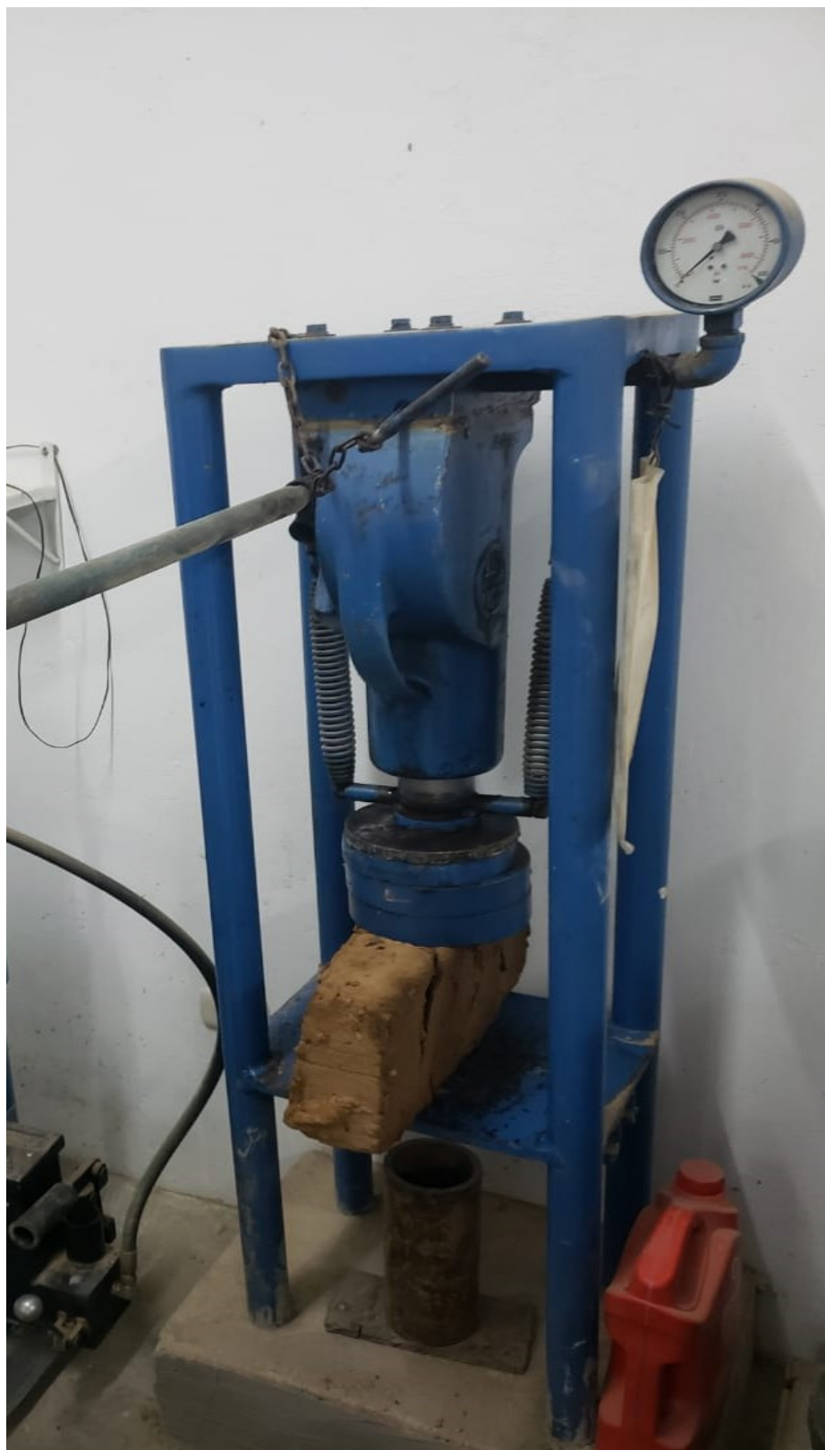
FOTO N°11- FALLA POR COMPRESION DEL ADOBE (MUESTRA N°01) EXTRAIDA DEL MERCADO ANTIGUO DE LA CIUDAD DE HUANUCO.
