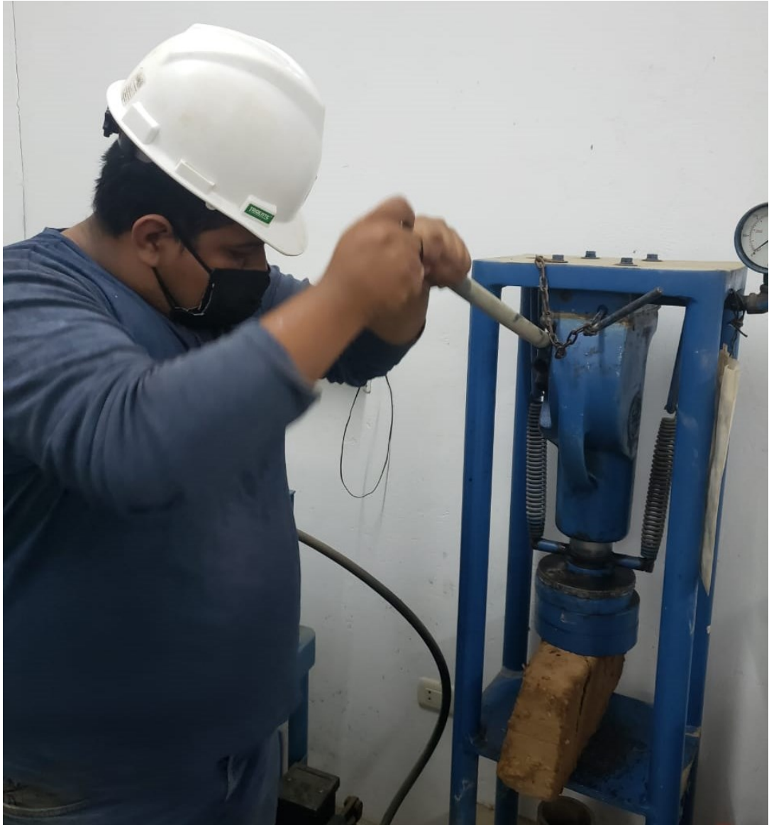
FOTO N°14- USO DE LA PRENSA PARA MEDIR LA COMPRESION DE LA PROBETA DE LOS ADOBES (MUESTRA N°02).
