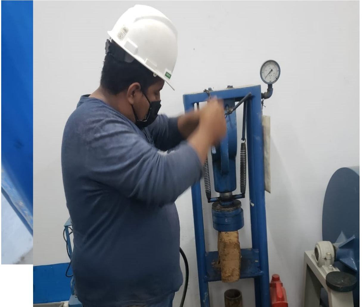
FOTO N°12- FALLA POR COMPRESION DEL ADOBE (MUESTRA N°02) EXTRAIDA DEL MERCADO ANTIGUO DE LA CIUDAD DE HUANUCO.
