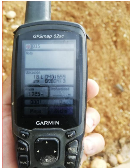
Imagen 31. Toma de puntos con GPS para la elaboración del mapa de ubicación en el tramo Las Vegas.
