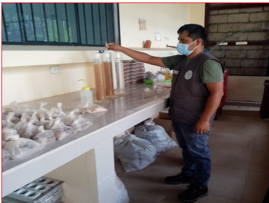
Imagen 22. Lectura del hidrómetro en cada probeta en el tiempo determinado.
