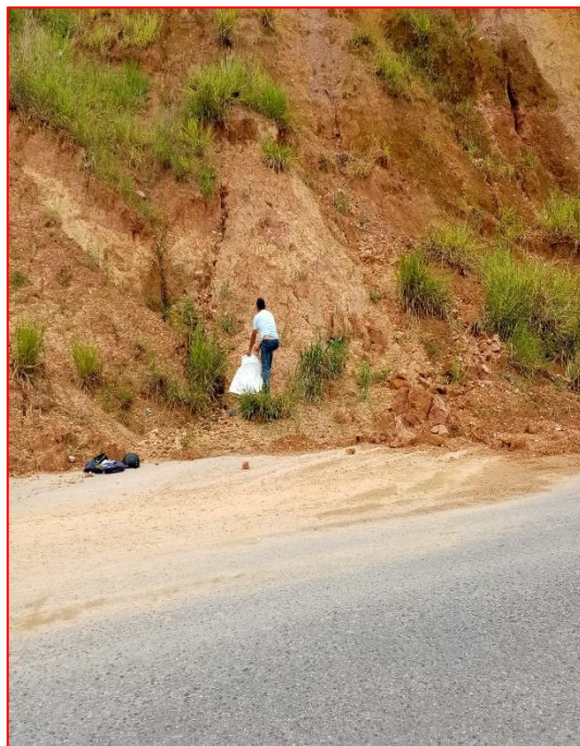
Imagen 5. Muestreo de suelo en pie de talud del tramo Las Vegas.
