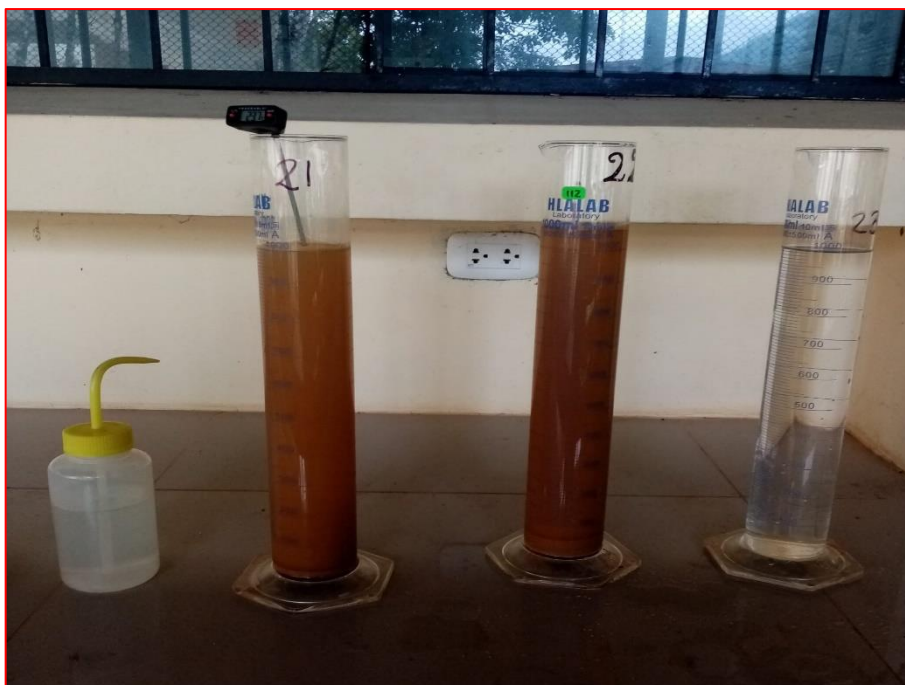
Imagen 21. Medición de la temperatura en cada probeta en el tiempo determinado.
