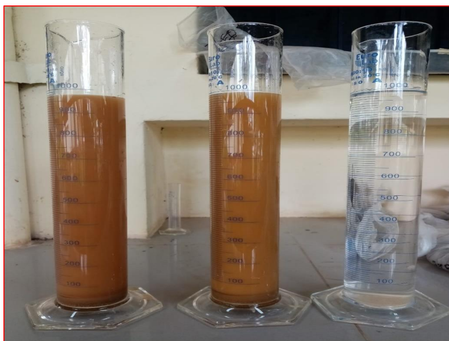
Imagen 20. Enrasado de agua destilada a 1000ml en las dos muestras de suelos y el testigo con agua destilada.
