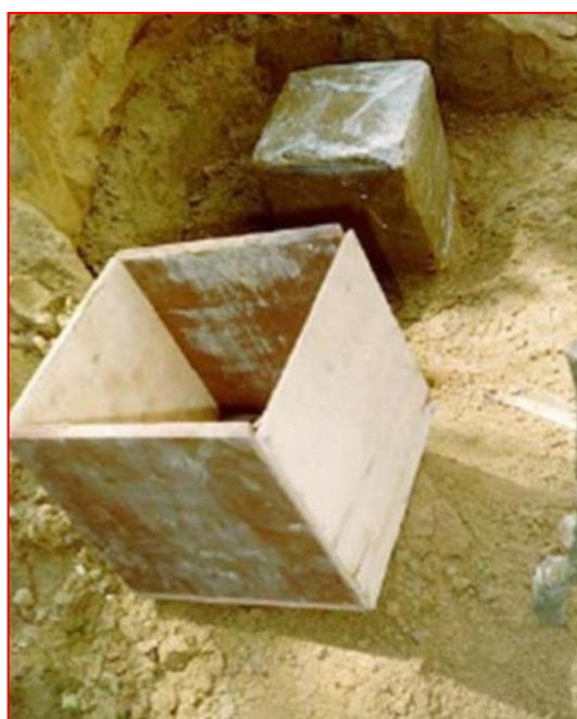
Imagen 8. Muestra inalterada para corte directo.
