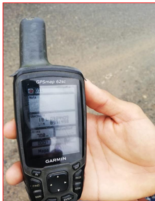
Imagen 32. Toma de puntos con GPS para la elaboración del mapa de ubicación del tramo Inti Alto.
