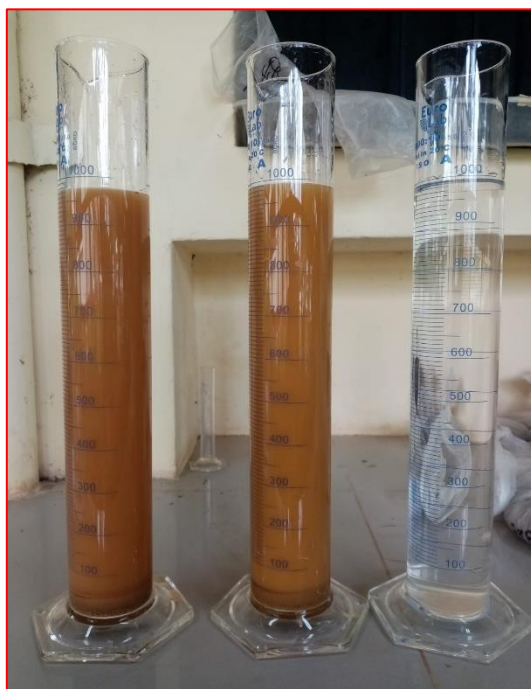
Imagen 33. Muestras para el ensayo de la granulometría por sedimentación.
