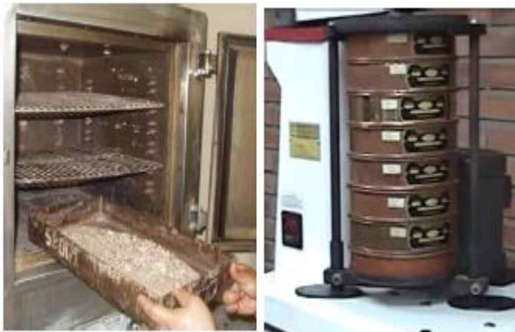
Imagen 14. Vista de secado en horno y tamizado por el equipo mecánico.
