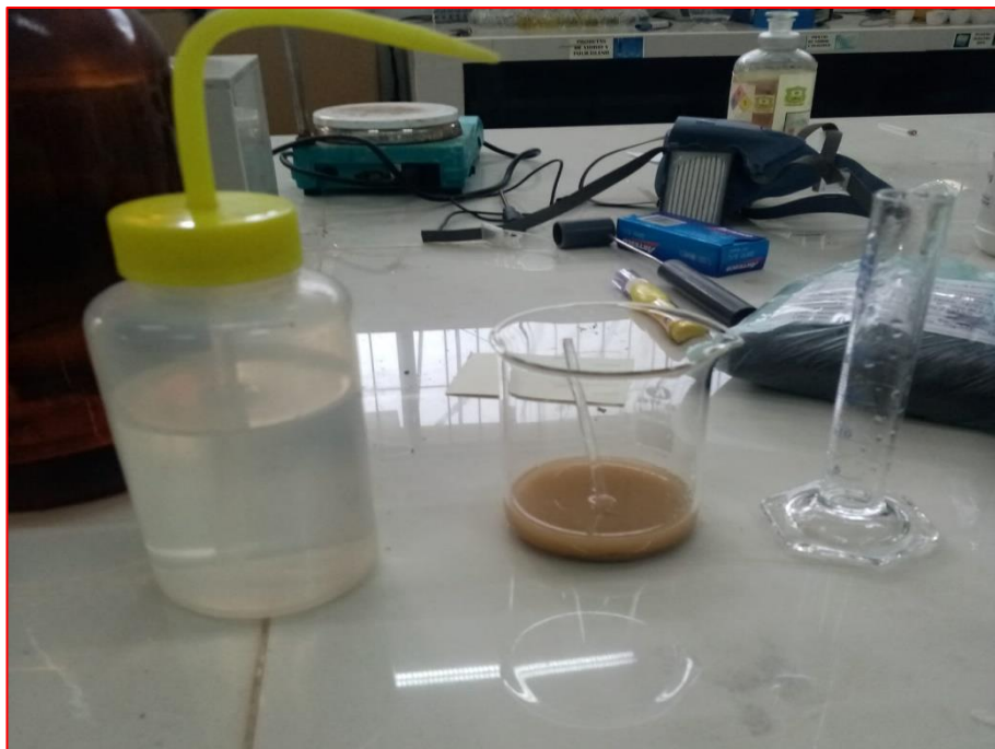
Imagen 18. Disolución del hexametafosfato de sodio con la muestra de suelo.
