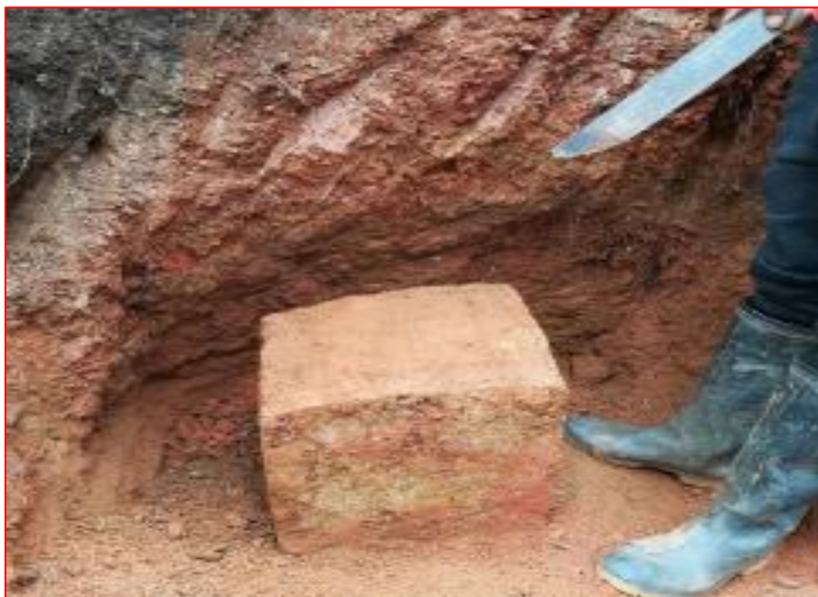
Imagen 7. Muestra inalterada extraída del tramo de inti Alto.
