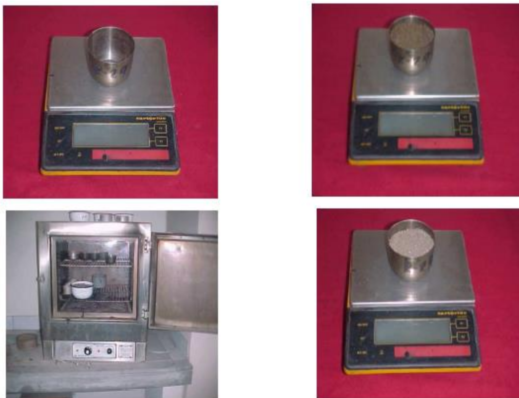
Imagen 10. Vista del procedimiento para la realización de la humedad en laboratorio.
