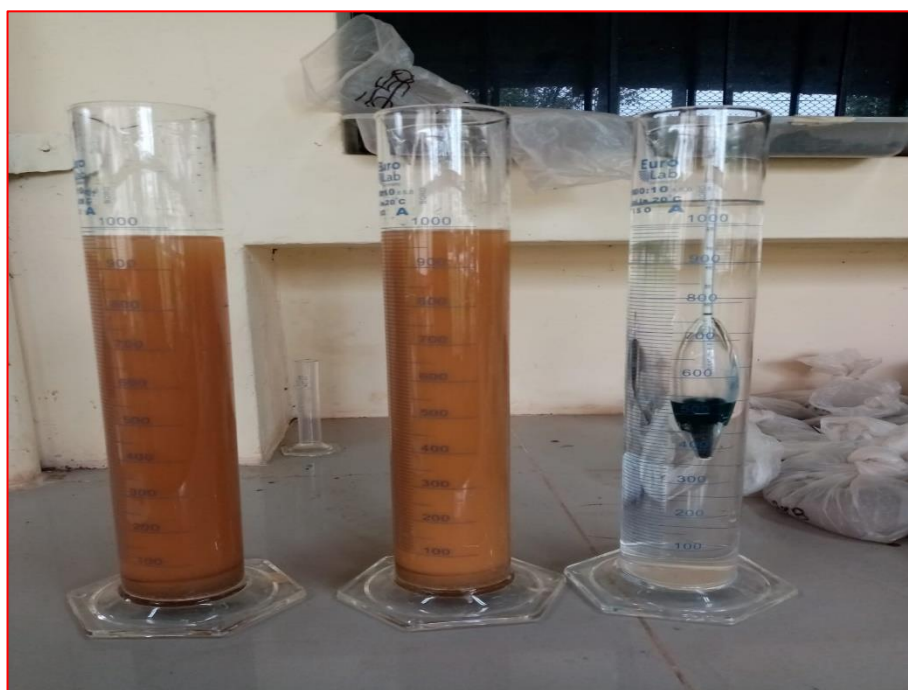
Imagen 23. Lectura del hidrómetro en el testigo (agua destilada)
