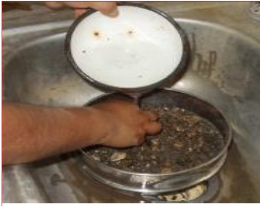
Imagen 13. Lavado del material con agua de caño.
