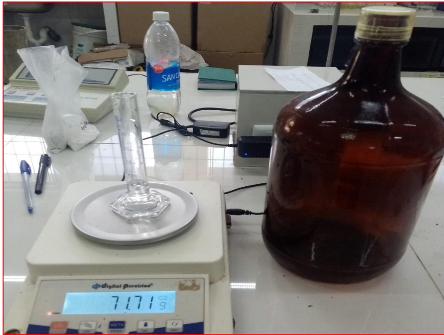
Imagen 17. Preparado del hexametafosfato.
