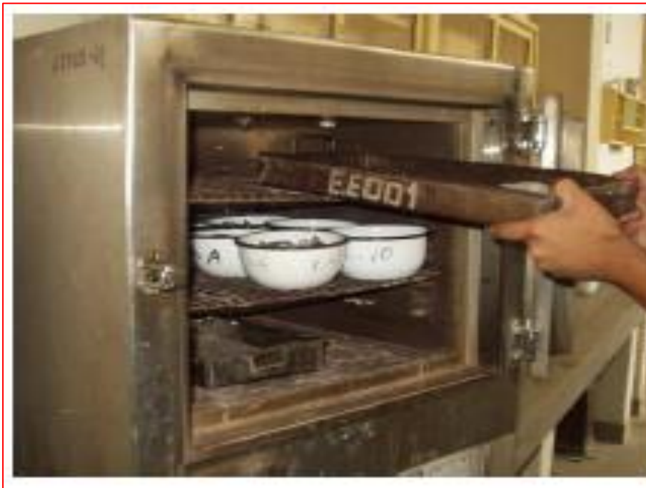
Imagen 11. Secado de muestra en estufa.
