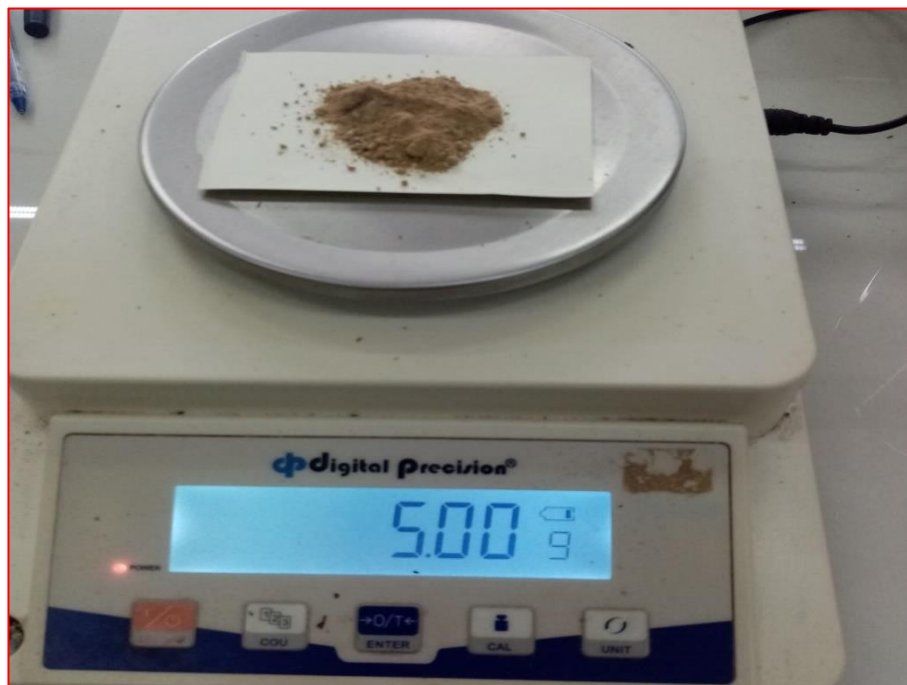
Imagen 16. Pesado de muestra de suelo para ambos tramos.
