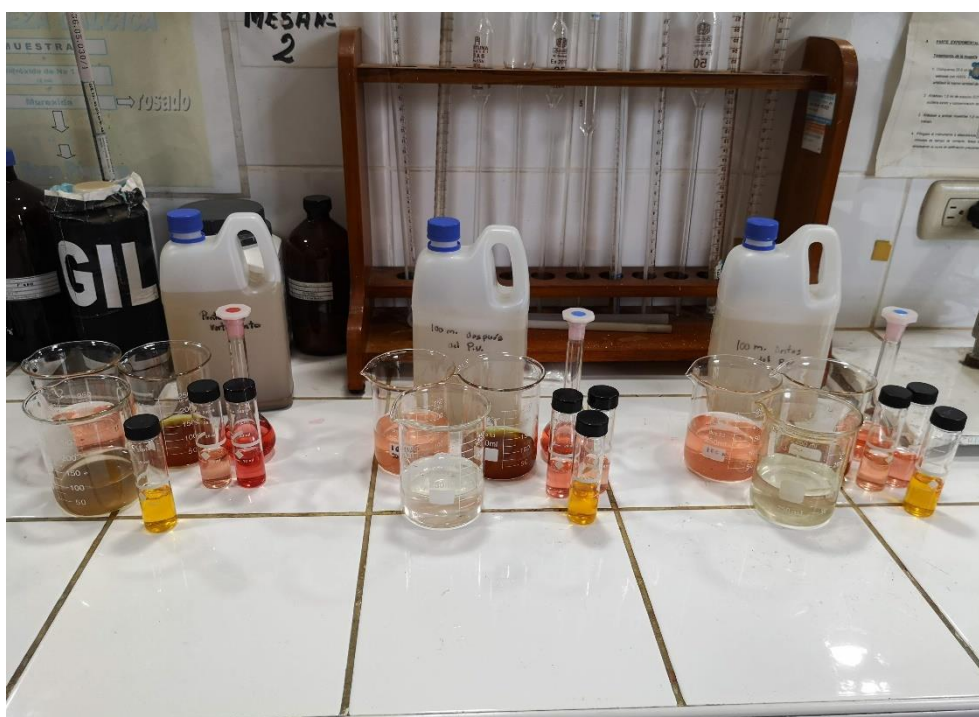
Análisis de Aluminio Residual en el Laboratorio de la Planta de Tratamiento de la EPS Seda Huánuco S.A
