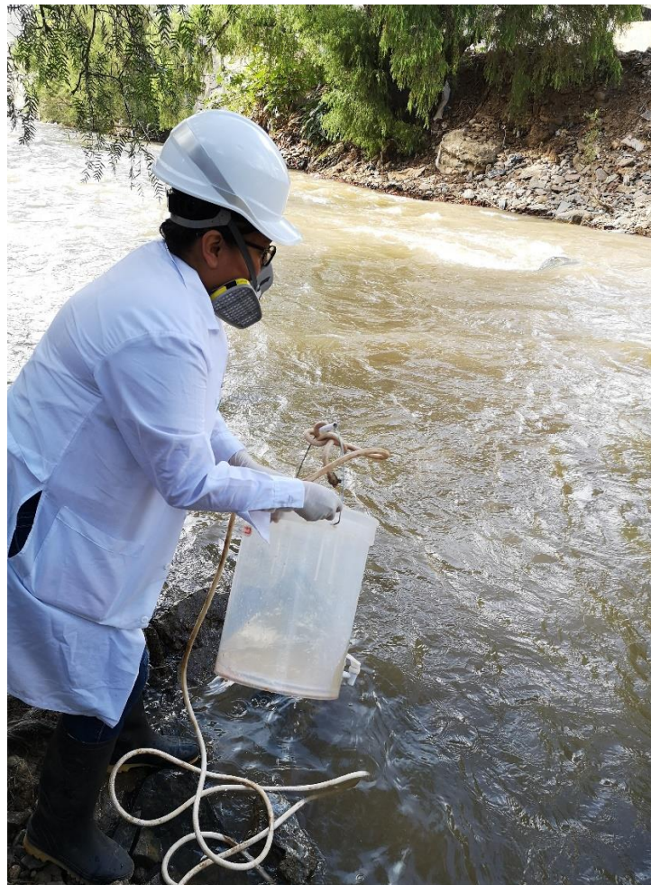
Monitoreo a 100 metros aguas abajo del punto de vertimiento de la Planta Cabritopampa de la EPS Seda Huánuco S.A
