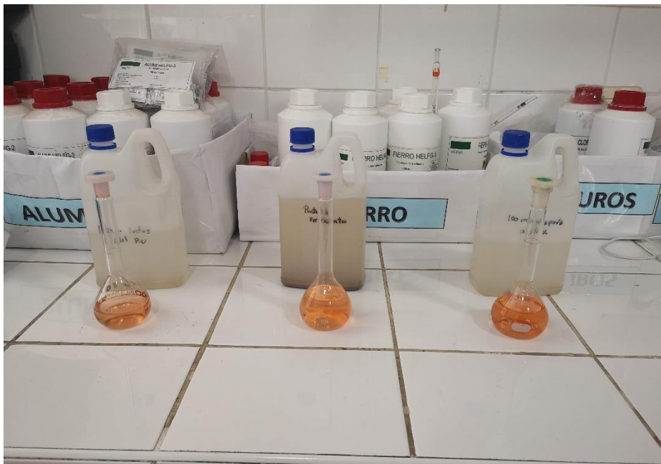
Muestras procesadas con aluminio de 100 metros aguas abajo, 100 metros aguas arriba y punto de vertimiento del estudio.
