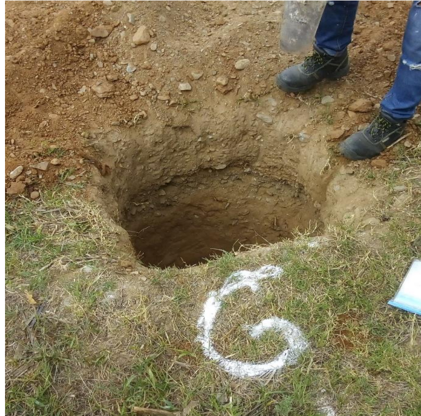
FOTOGRAFIA N° 8 VISTA DE CALICATAS DEL AREA DE ESTUDIO
