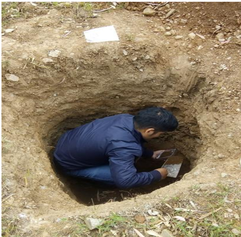
FOTOGRAFIA N° 11 TOMA DE MUESTRA DEL SUELO A ANALIZARCE
