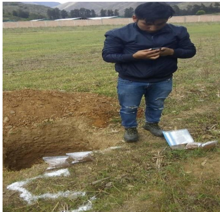
FOTOGRAFIA N° 10 TOMA DE COORDENADAS DE LAS CALICATAS
