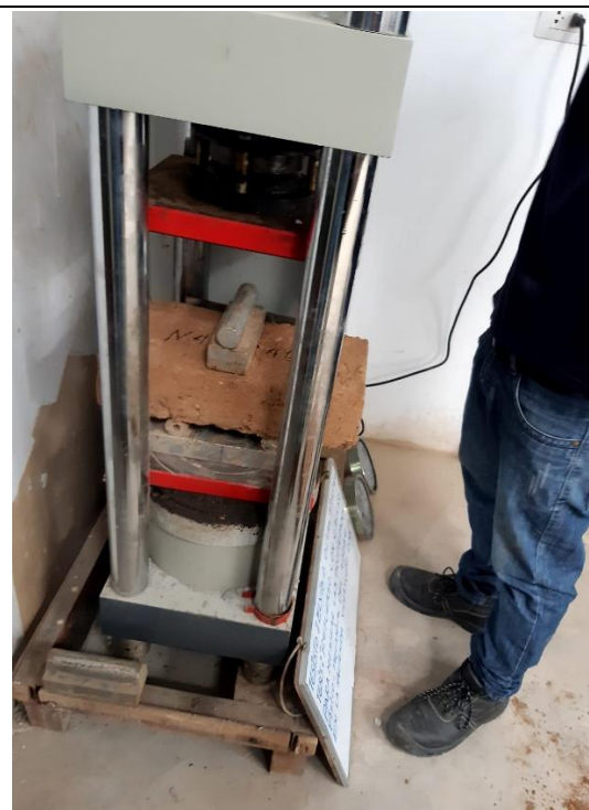
IMAGEN 30 : ENSAYO A CORTE DE ADOBE CONVENCIONAL
