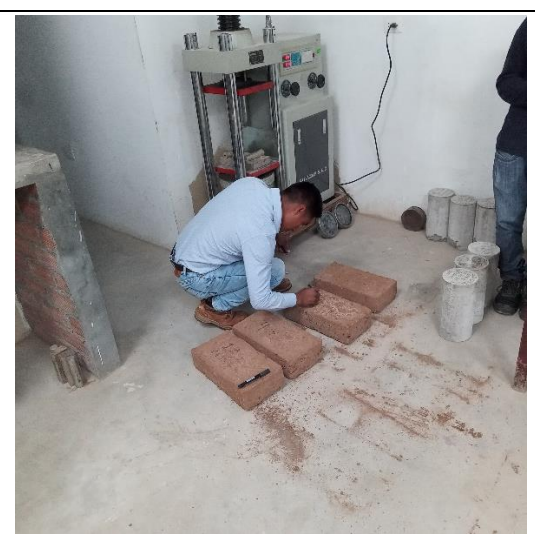
IMAGEN 26 : MARCADO DE MUESTRAS PARA LOS ENSAYOS A CORTE O FLECCION
