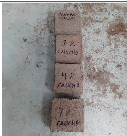
IMAGEN 36 : MUESTRAS LISTAS PARA ENSAYO DE COMPRESION
