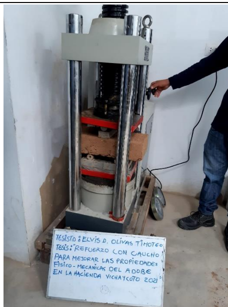
IMAGEN 32 : ENSAYO A CORTE DE ADOBE CON CAUCHO
