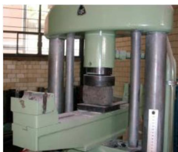
Figura 2. Prueba a la resistencia de compresión (Angeles, 2015)
