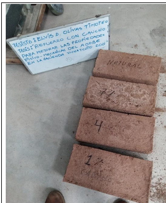
IMAGEN 27 : MUESTRAS LISTAS PARA LOS ENSAYOS DE CORTE
