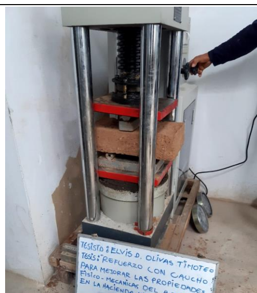
IMAGEN 33 : RESULTADOS DE LA PRUEBA DE CORTE DE ADOBE CON 4 % DE CAUCHO
