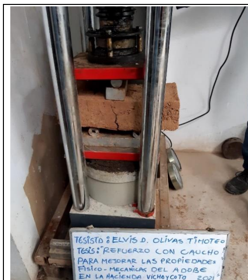
IMAGEN 33 : RESULTADOS DE LA PRUEBA DE CORTE DE ADOBE CONVENCIONAL
