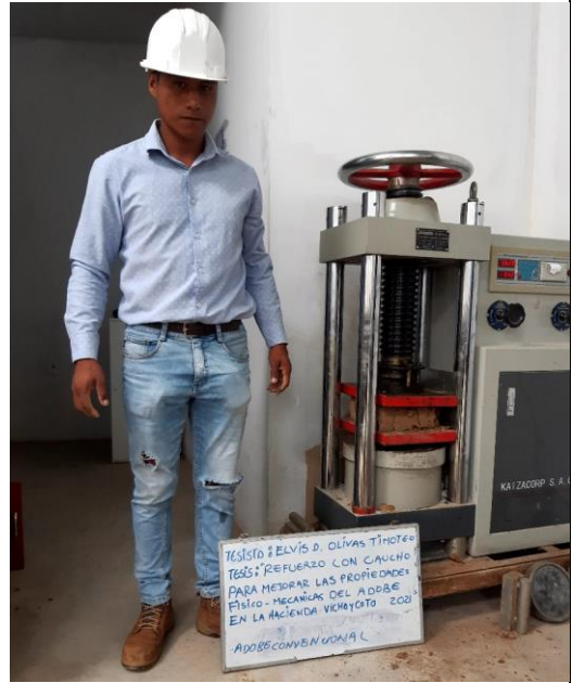
IMAGEN 46 : PRUEBA DE COMPRESION.
