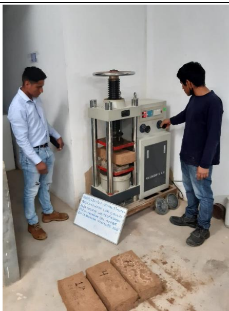
IMAGEN 31 : ENSAYO A CORTE DE ADOBE CON CAUCHO
