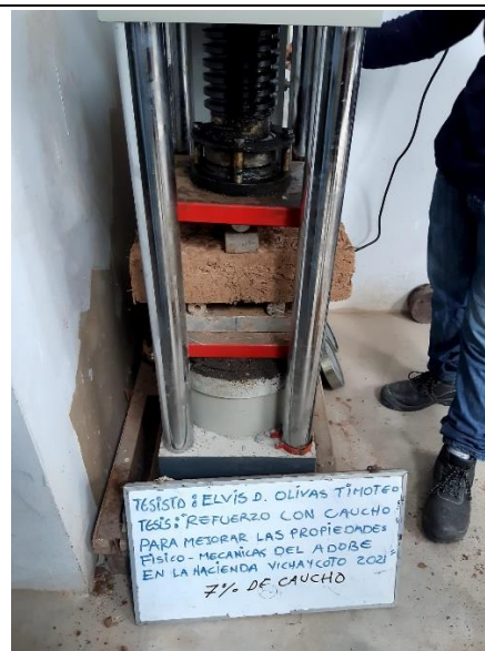
IMAGEN 33 : RESULTADOS DE LA PRUEBA DE CORTE DE ADOBE CON 7 % DE CAUCHO
