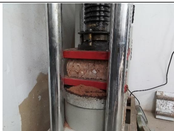
IMAGEN 37 : ENSAYO A COMPRESION DE ADOBES CONVENCIONALES
