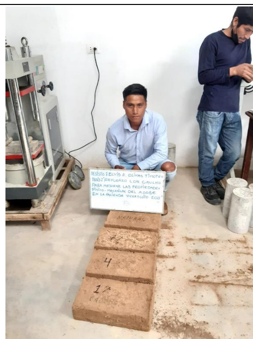
IMAGEN 28 : MUESTRAS LISTAS PARA LOS ENSAYOS DE CORTE
