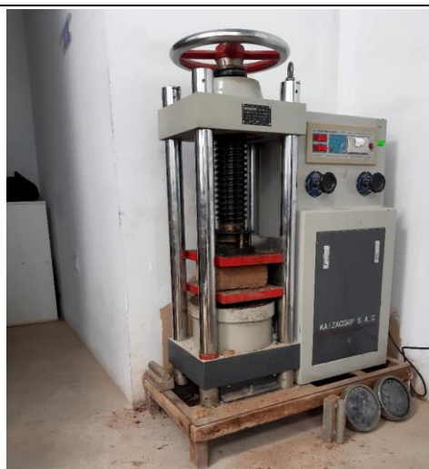
IMAGEN 38 : ENSAYO A COMPRESION DE ADOBES
