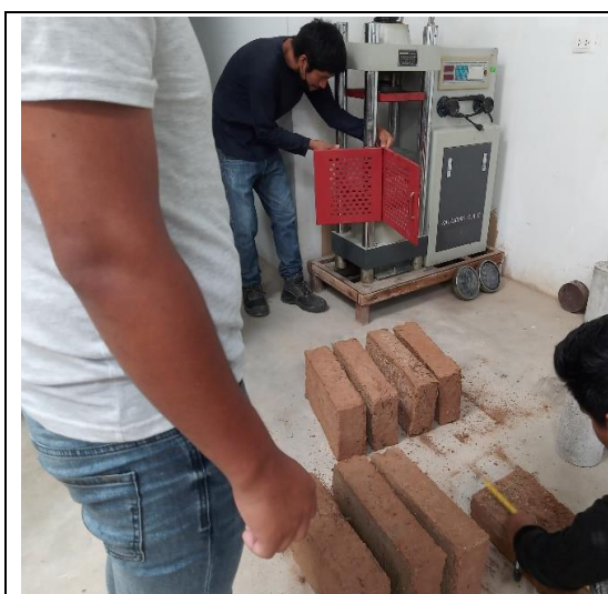
IMAGEN 25 : MEDICION DE MUESTRAS PARA LOS ENSAYOS CORTE O FLECCION
