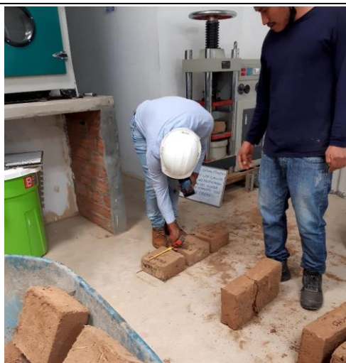
IMAGEN 35 : MEDICION DE ADOBES PARA EL ENSAYO DE COMPRESION
