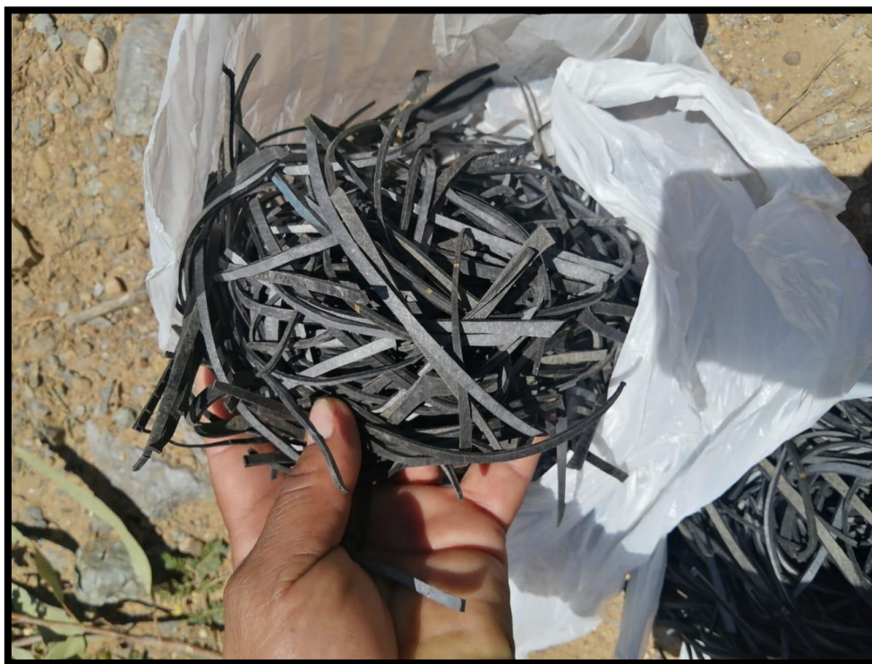
Figura 11. Fibras de cámaras de llantas (caucho) cortadas para la elaboración de adobes.
