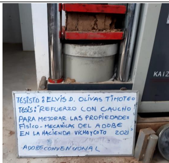
IMAGEN 37 : ENSAYO A COMPRESION DE ADOBES CONVENCIONALES
