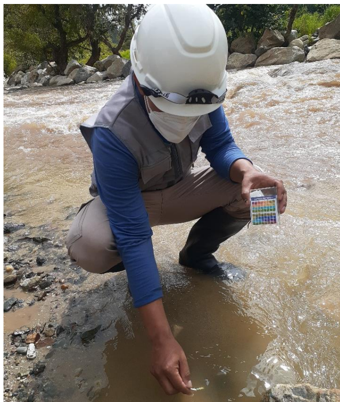
Medición del PH del agua del primer punto de muestreo
