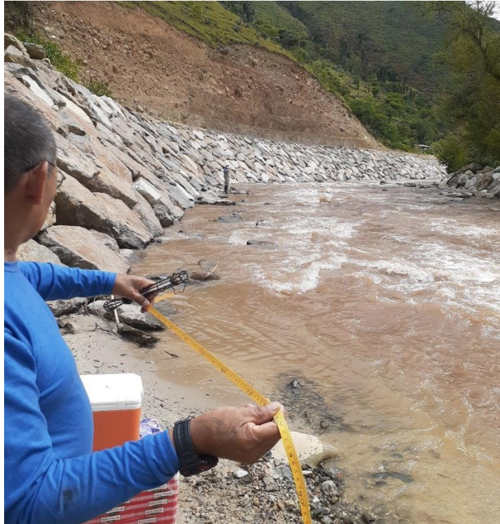
Medición de la distancia de 50 m. para calcular la velocidad del río, dato para cálculo del caudal del río.
