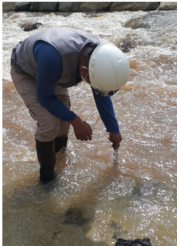
Medición de la temperatura del agua del primer punto de muestreo
