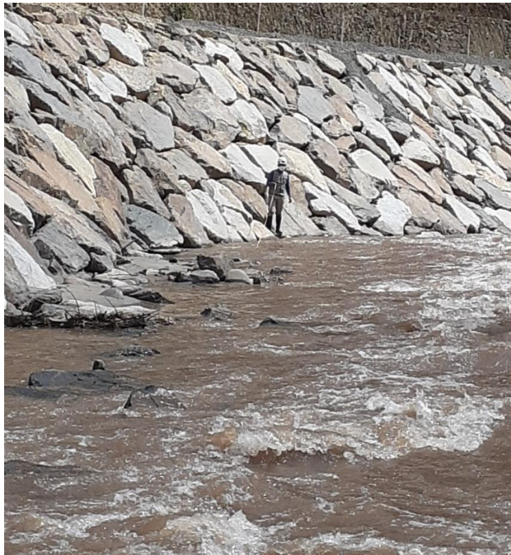
En esta imagen se muestra el lanzamiento del envase midiendo con el cronometro el tiempo que tarda en recorrer los 50 metros.
