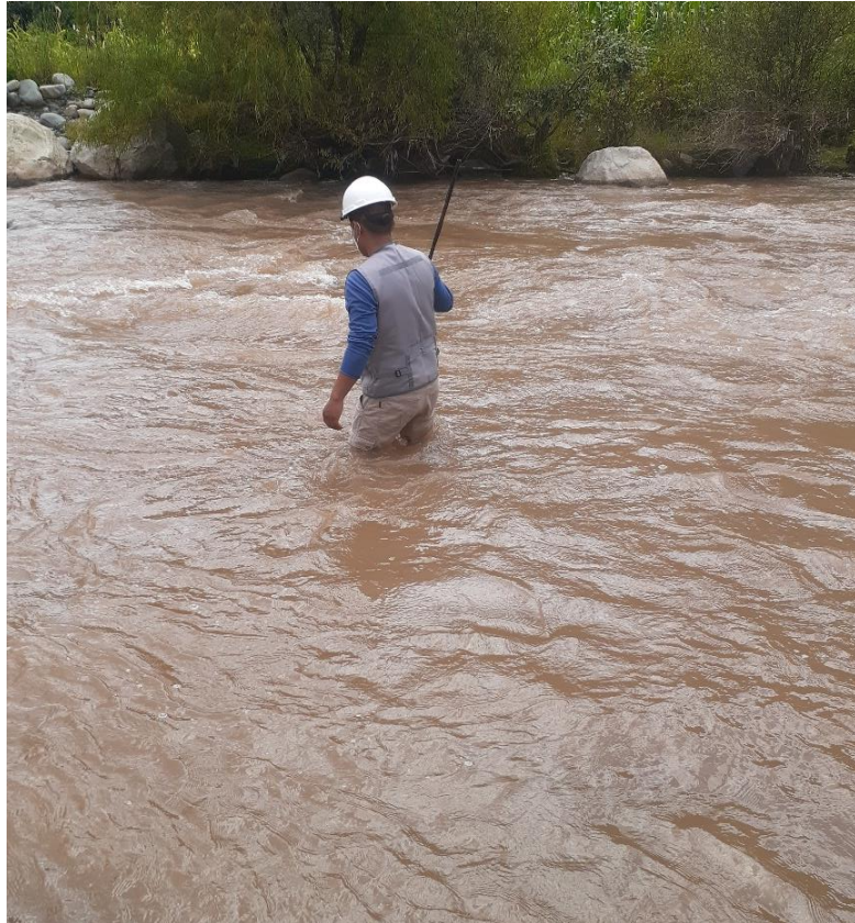
En esta imagen se muestra la medición de la profundidad del río para el cálculo del caudal del río.
