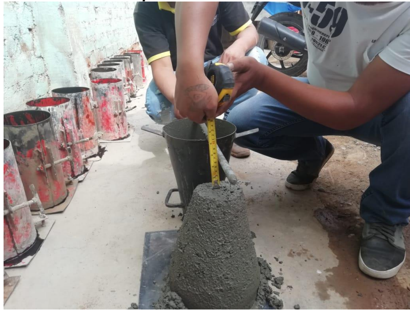
Figura 10 Ensayo de Método Slump
