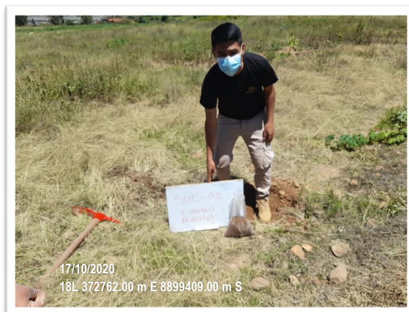
MS – 02: Se evidencia el muestro de suelo y toma de coordenadas mediante un GPS durante la etapa inicial.
