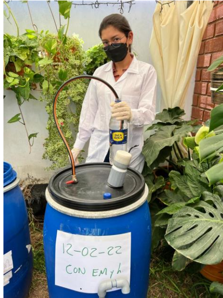
Sellado del biodigestor casero
