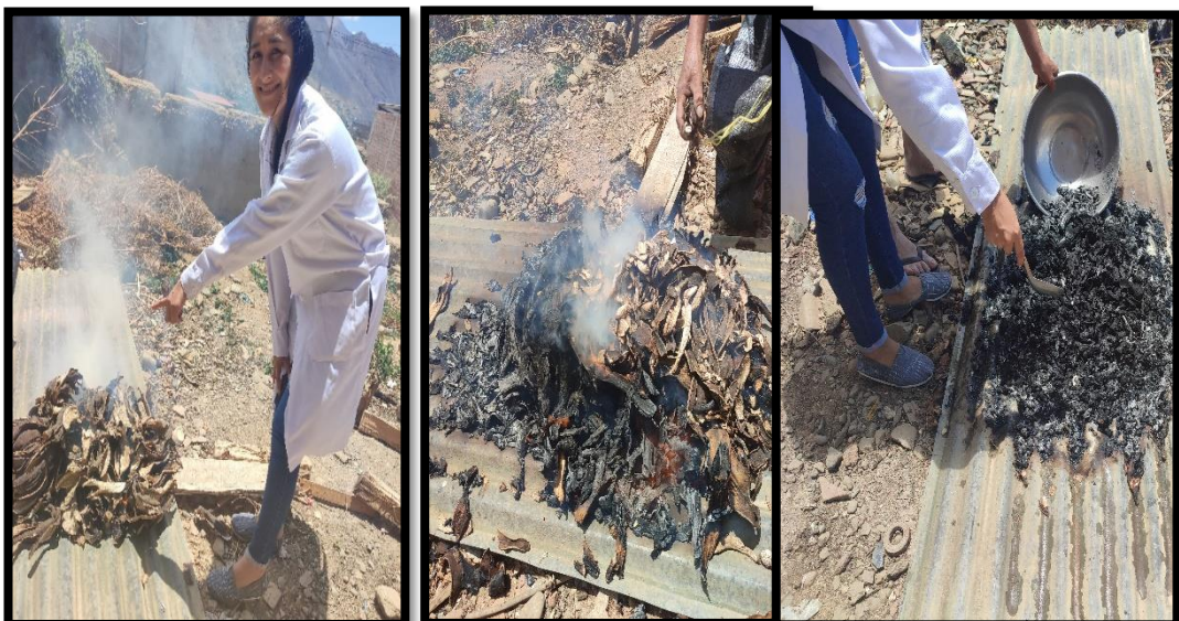
Se observa el proceso de elaboración del carbón del plátano. Iniciando con altas temperaturas para el quemado de la cascara de plátano, hasta que este calcinado o en consistencia de un carbón normal. Recoger en un embace metálico para dejar enfriar. Previamente desinfectado.
