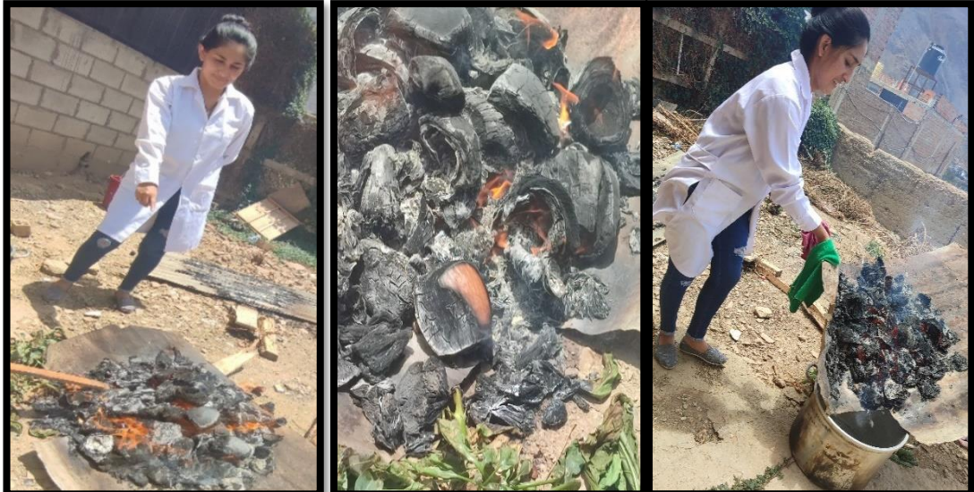
Se observa el proceso de elaboración del carbón de coco. Iniciando con altas temperaturas para el quemado de la cascara de coco, hasta que este calcinado o en consistencia de un carbón normal. Recoger en un embace metálico para dejar enfriar. Previamente desinfectado.
