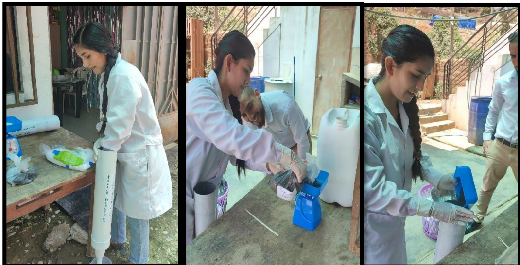
Iniciamos colocando el algodón en la base, el papel filtro después de cada material, pesamos el carbón de coco de plátano.
