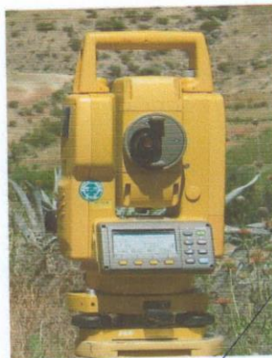
Imagen N° 03. Estación Total TOPCON
