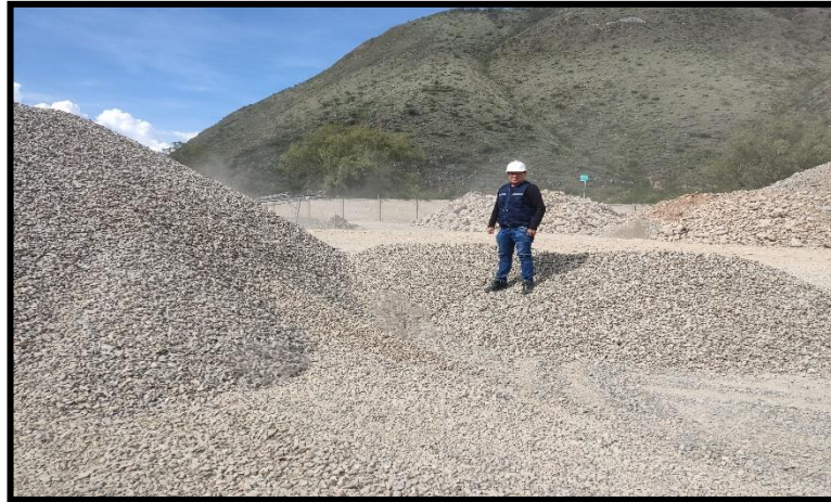
Se observa en la cantera la piedra chancada para la pavimentación
