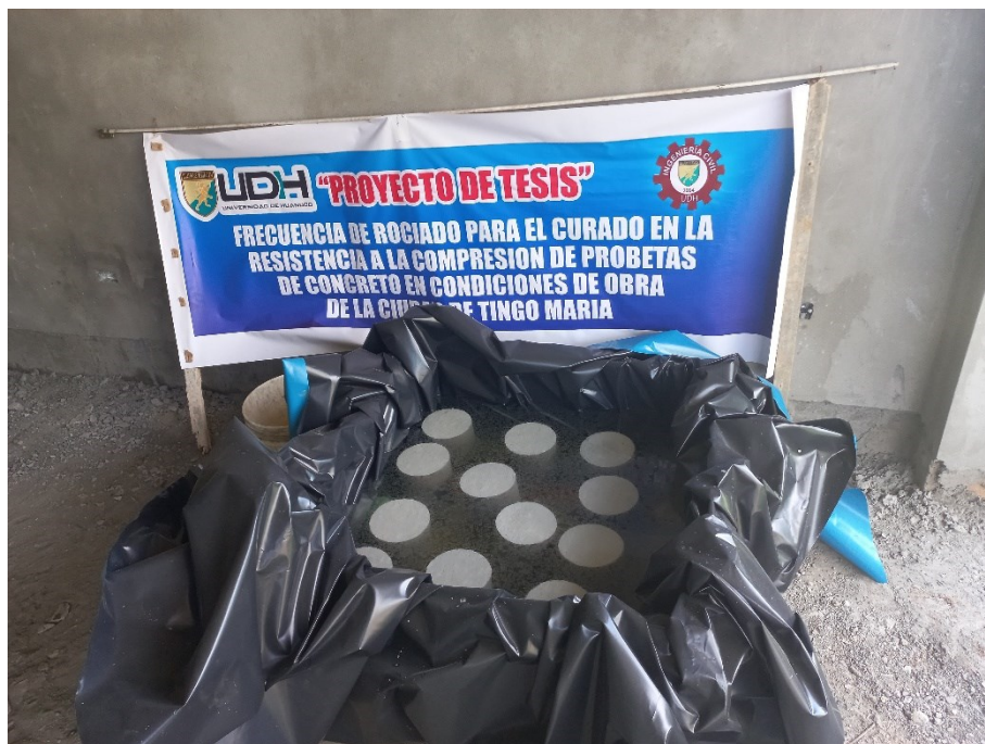
Figura 45 Curado de concreto por inmersión.
