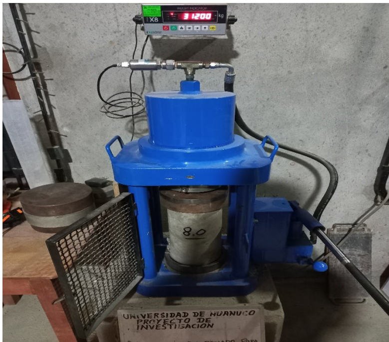
Figura 29 Prueba inicial de dosificación del concreto en 8 bolsas
