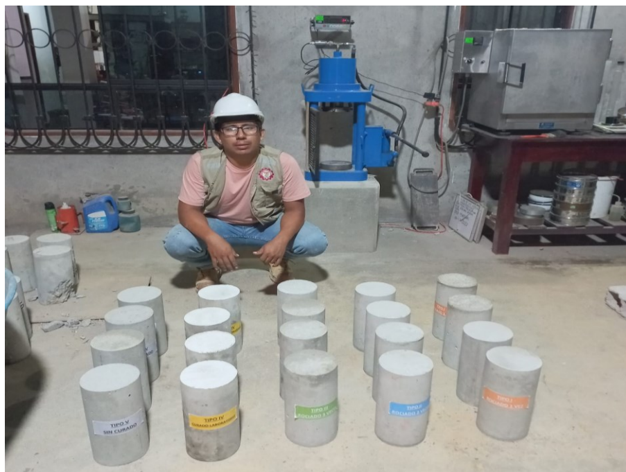
Figura 89 Señalización de los moldes de concreto para su evaluación
