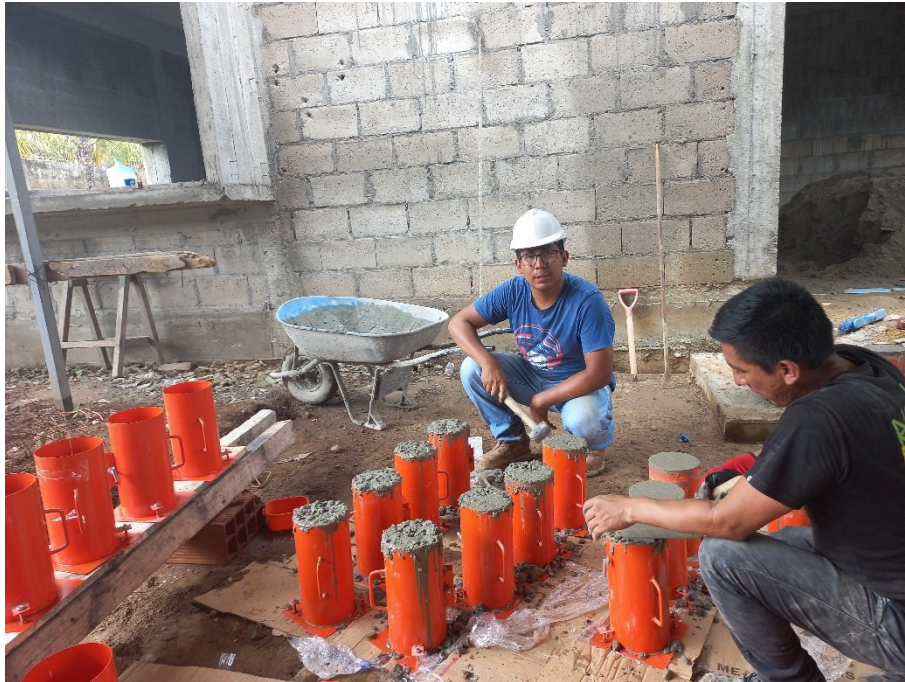
Figura 42 Fabricación de las probetas de concreto
