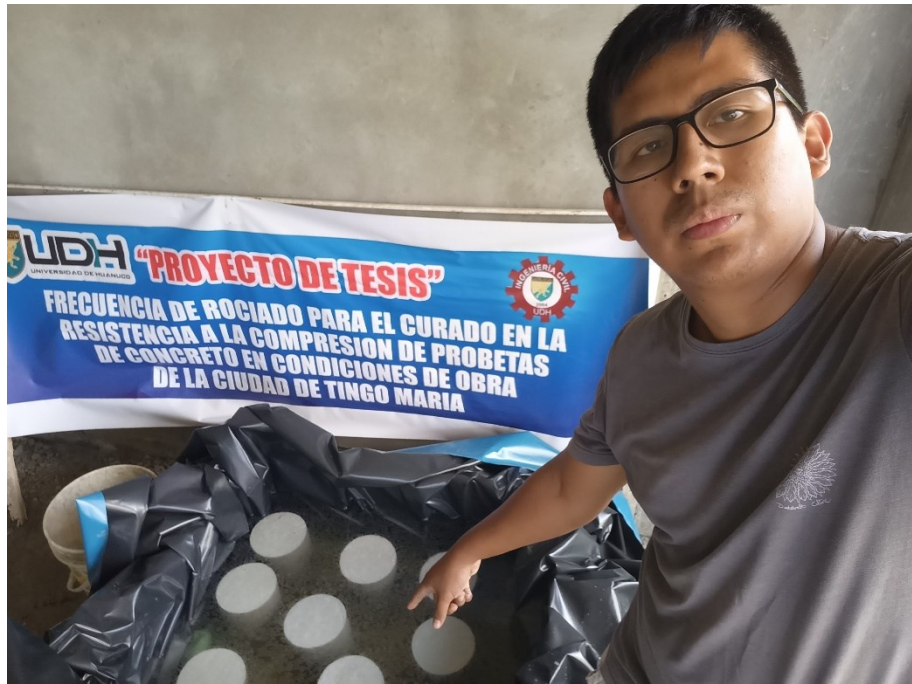
Figura 46 Curado de concreto por inmersión
