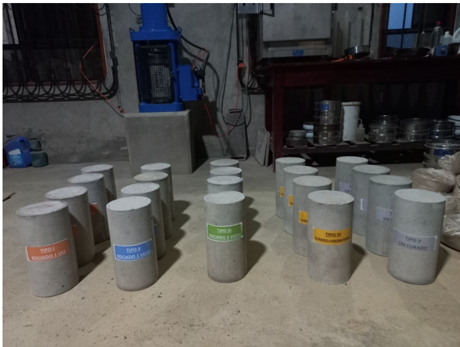
Figura 67 Señalización de los moldes de concreto para su evaluación
