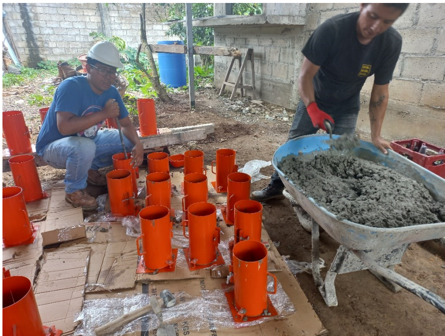
Figura 41 Fabricación de las probetas de concreto
