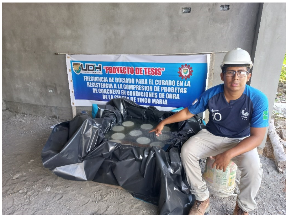
Figura 47 Curado de concreto por inmersión
