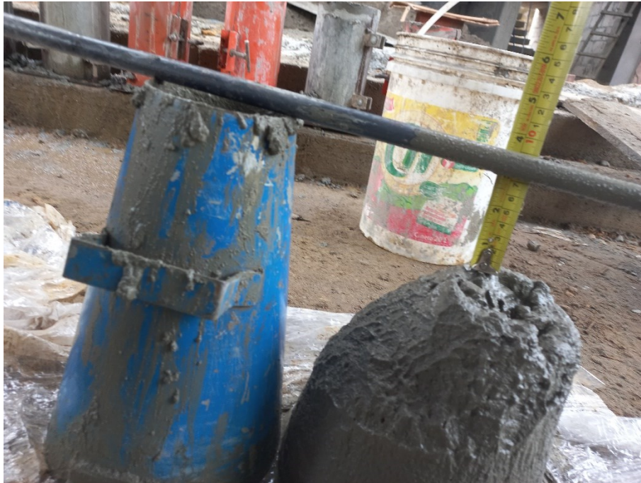
Figura 38 Verificación de asentamiento de concreto
