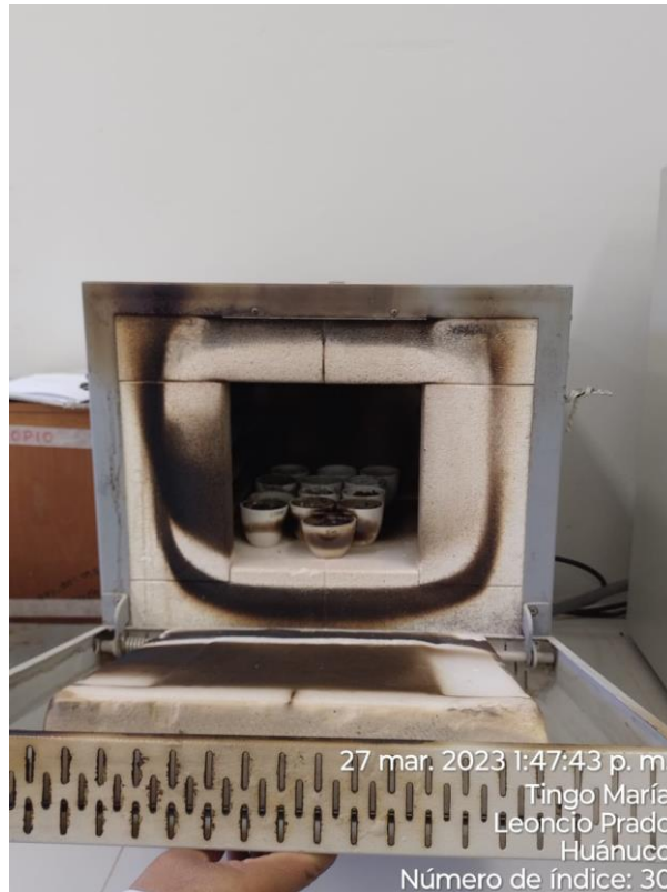
Resultado del Biocarbón de gallinaza a 400°C por 2 Horas.
