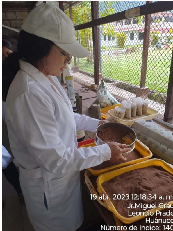
Tamizado del suelo contaminado a través de las mallas de acero.
