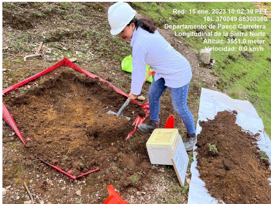
Extracción del Suelo Contaminado de la localidad de Chicrin – Pasco.
