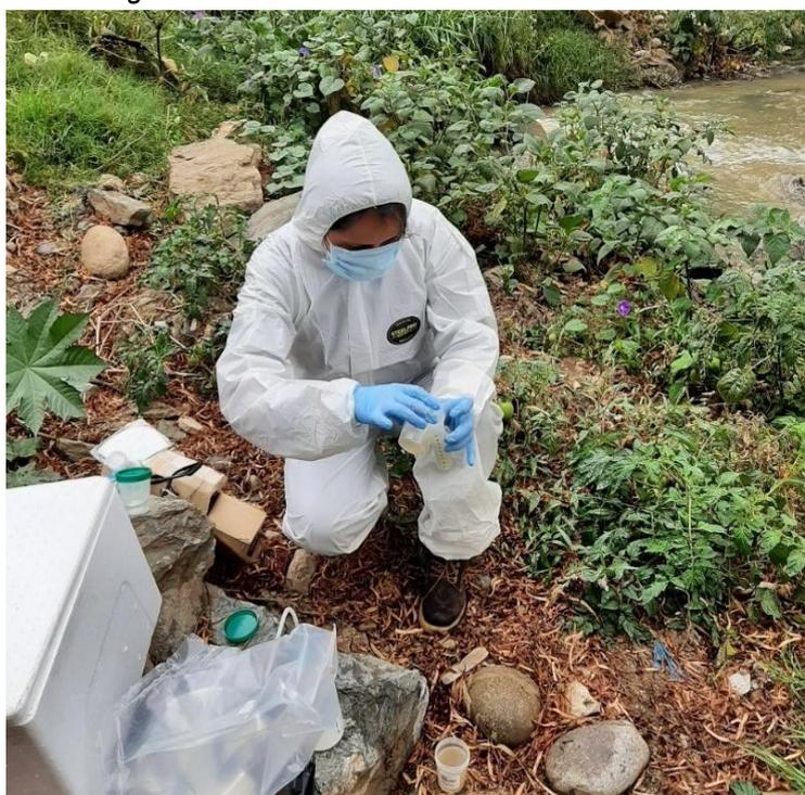
Así también, se tomaron datos de los parámetros de campo *in situ*, entre ellos, medición de oxígeno disuelto (OD), potencial de hidrógeno (pH) temperatura y conductividad eléctrica en cada punto de muestreo (Tabla 3).
