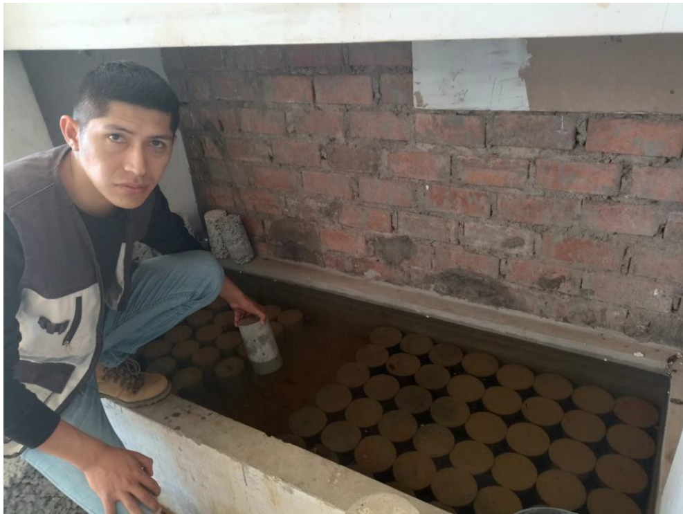
Curado de probetas del concreto estructural.
