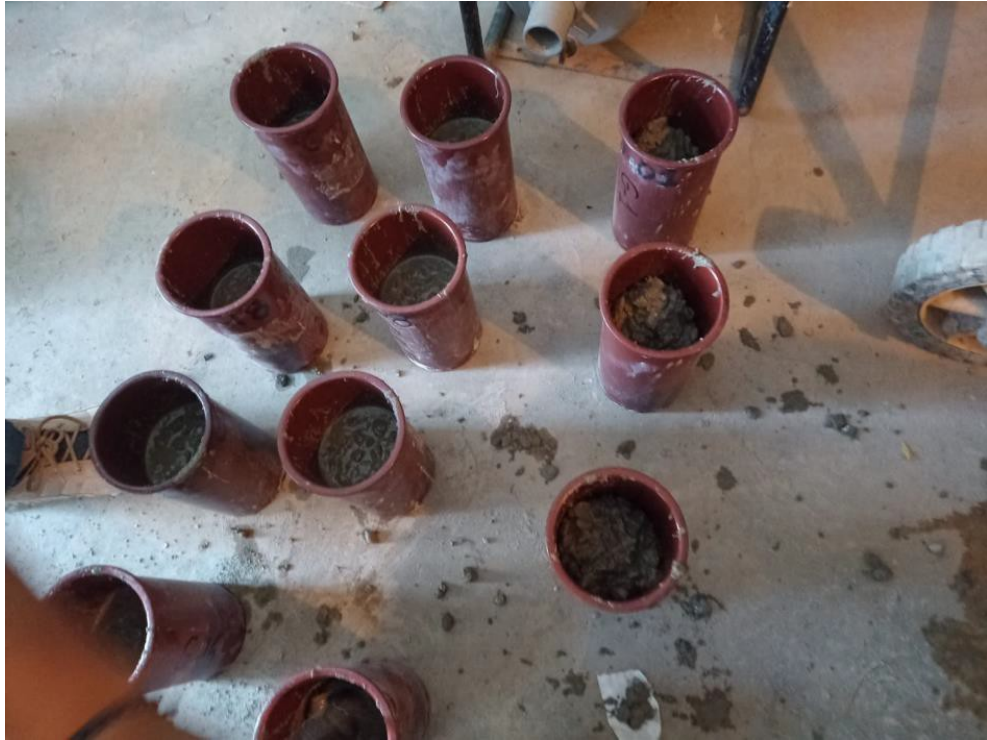
Preparación de probetas del concreto estructural.
