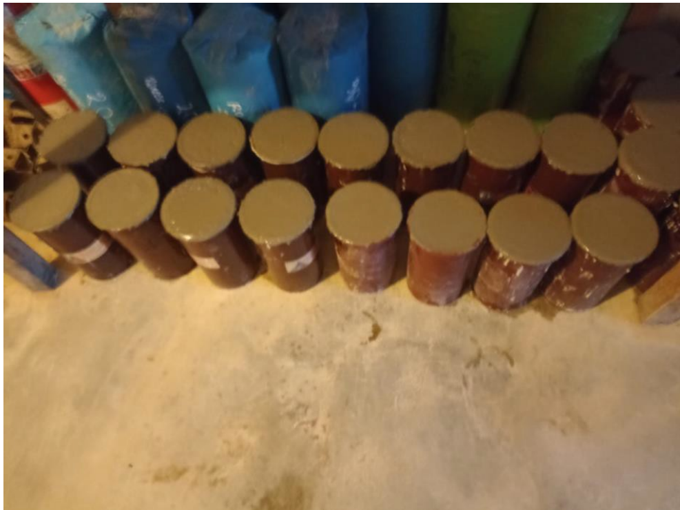
Acabado de las probetas en estado fresco.
