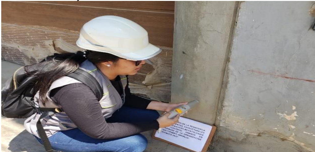
Figura 45 Realización del ensayo de esclerometría E-16
