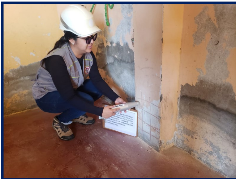
Figura 58 Utilización del esclerómetro
