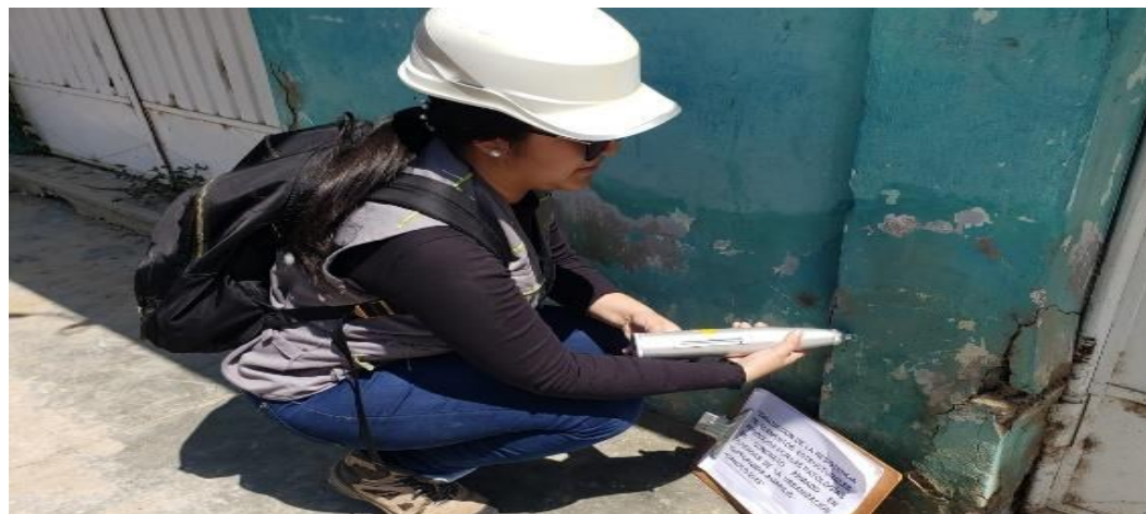
Figura 43 Realización del ensayo de esclerometría E-14
