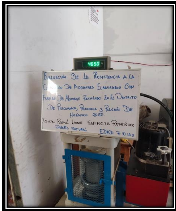
SE OBSERVA LA ROTURA DEL ADOQUIN A LOS 7 DIAS
