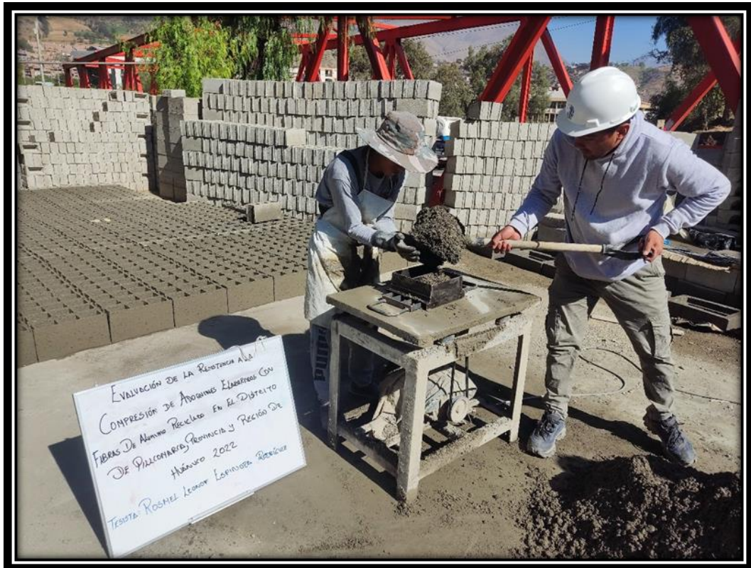
SE OBSERVA EL DISEÑO DE MEZCLA DEL AGREGADO CON EL ALUMINIO RECICLADO
