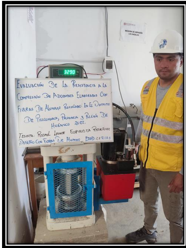
SE OBSERVA LA ROTURA DEL ADOQUIN A LOS 28 DIAS
