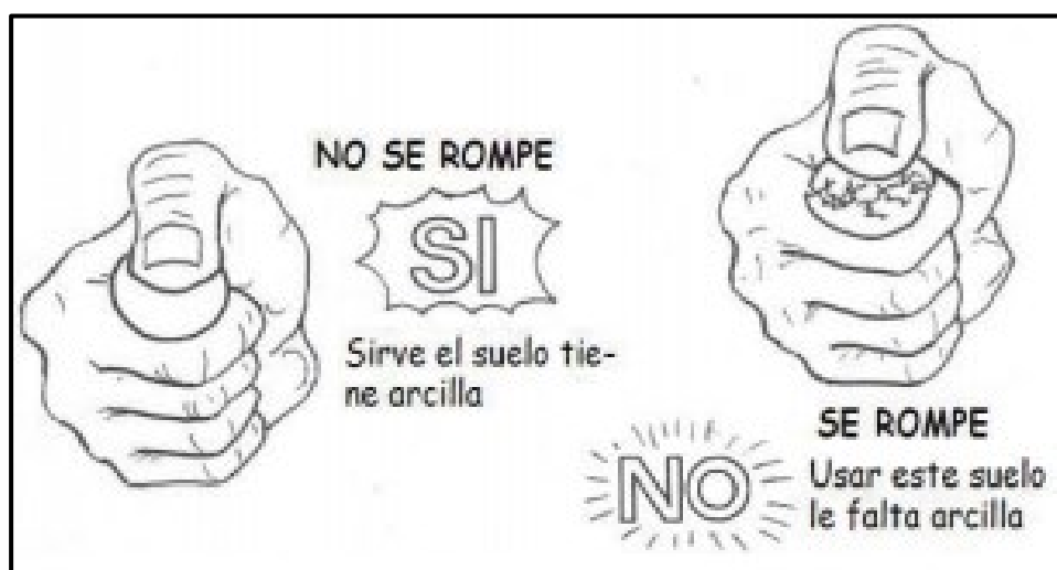
Figura 4 Prueba de quiebre
