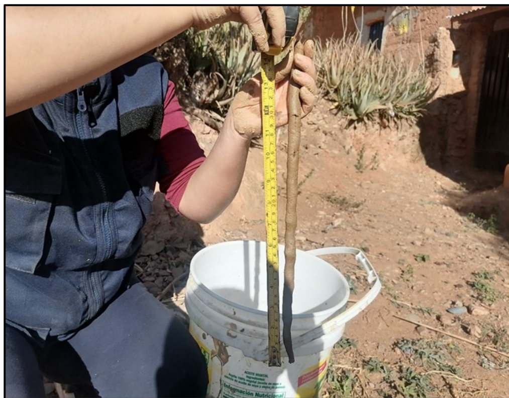
Figura 34 Prueba de cinta de barro
