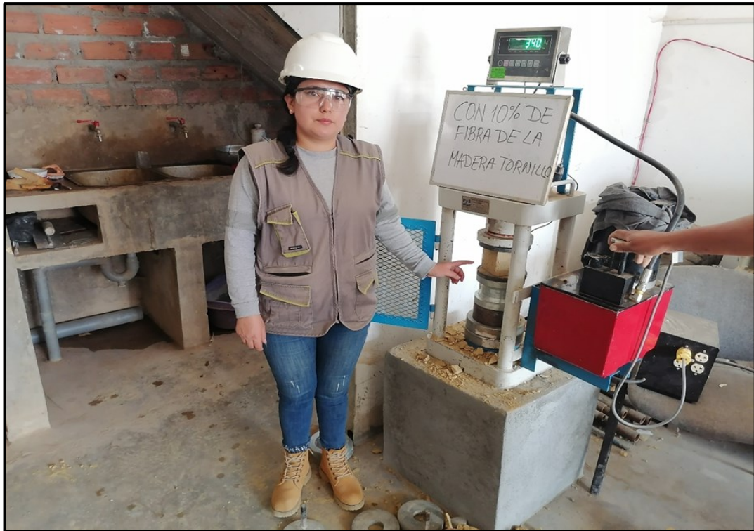
Figura 55 Ensayo de compresión del adobe
