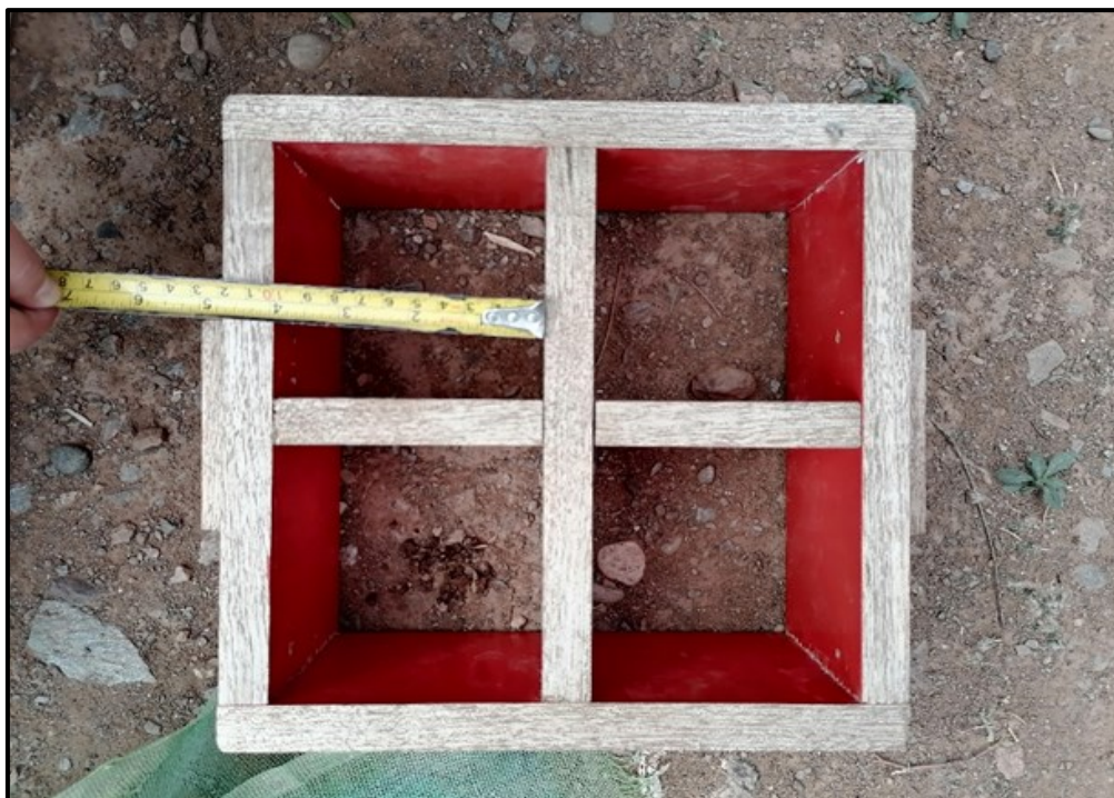
Figura 18 Elaboración del molde de adobe
