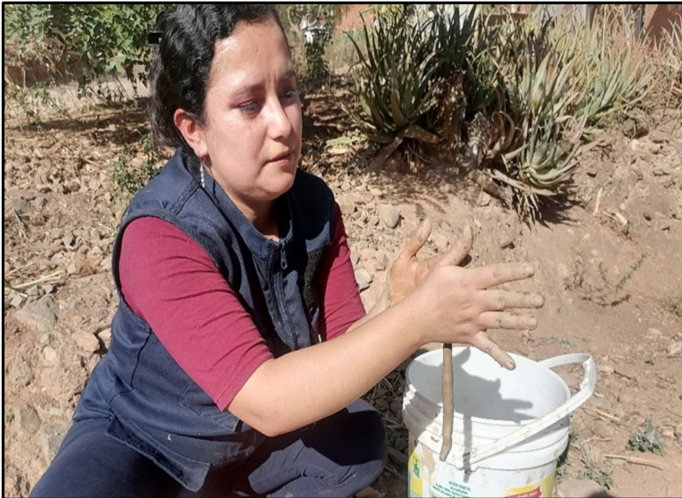
Figura 33 Prueba de cinta de barro
